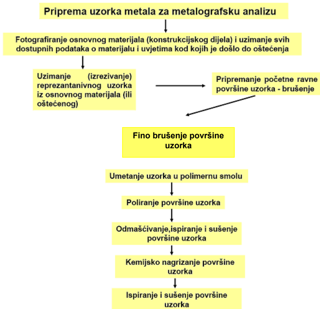
Slika 32. Shematski prikaz pripreme uzorka za mikrostrukturnu analizu [11 ]
