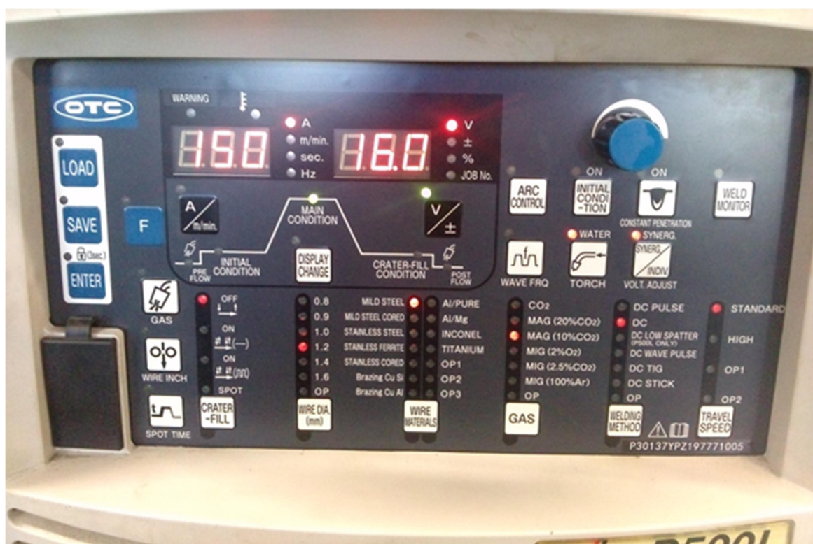
Slika 18. Korisničko sučelje uređaja za zavarivanje WB – 500L
