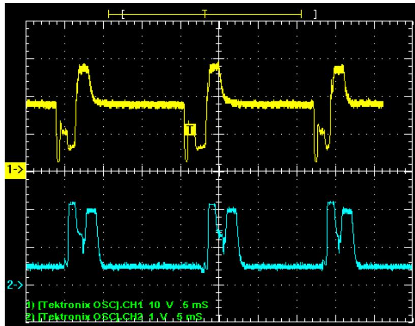
Slika 12. Dinamička karakteristika 1 –  $u=f(t)$ , 2-  $i=f(t)$  FastROOT postupka [14]
