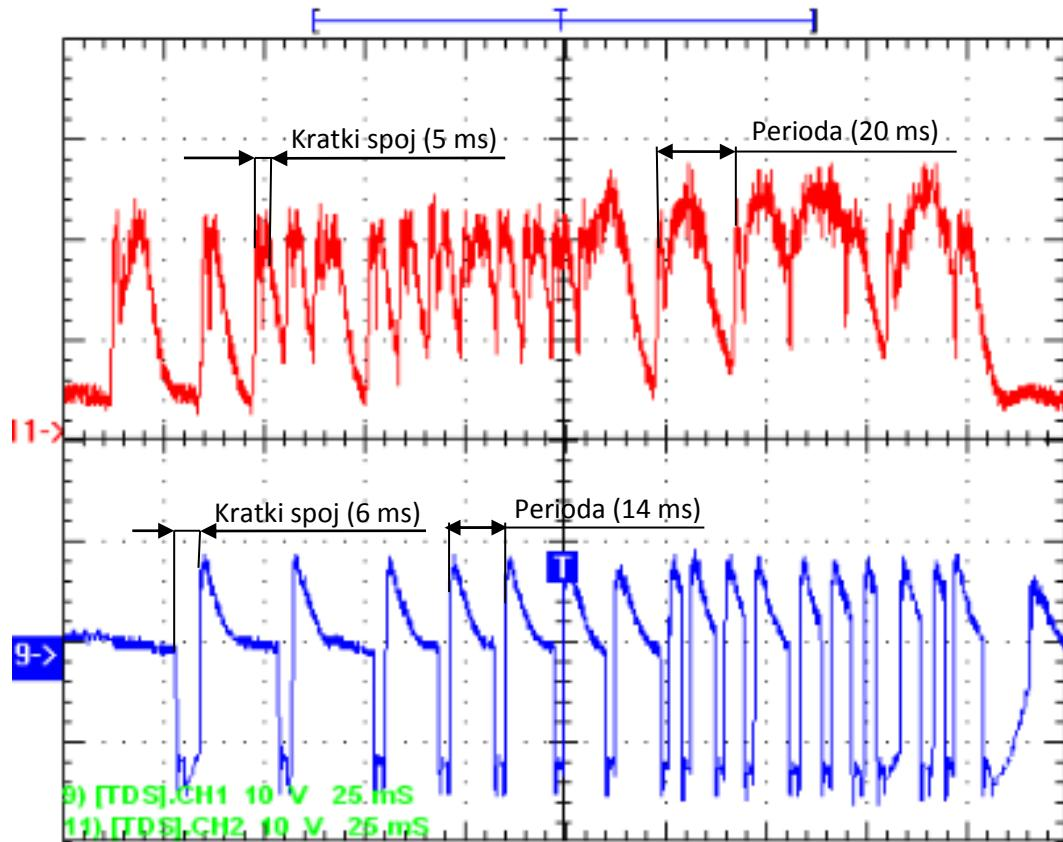
**Slika 43. Oscilogram dinamičke karakteristike  $u,i=f(t)$  pri MAG navarivanju za slobodni kraj žice 17 mm i Korekcija visine luka za postavljenu vrijednost -10**
