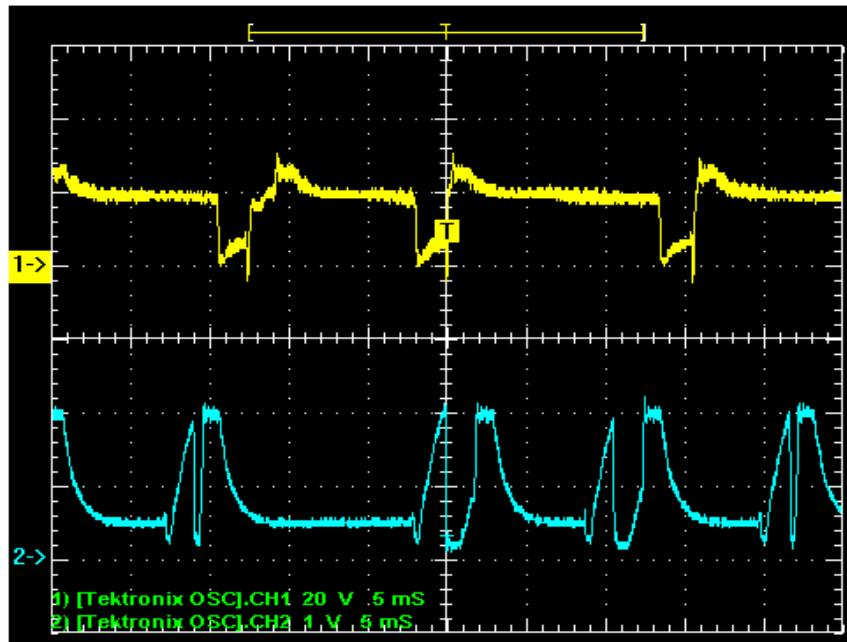
Slika 10. Dinamička karakteristika 1 – $u=f(t)$ ; 2 – $i=f(t)$  STT postupka [14]
