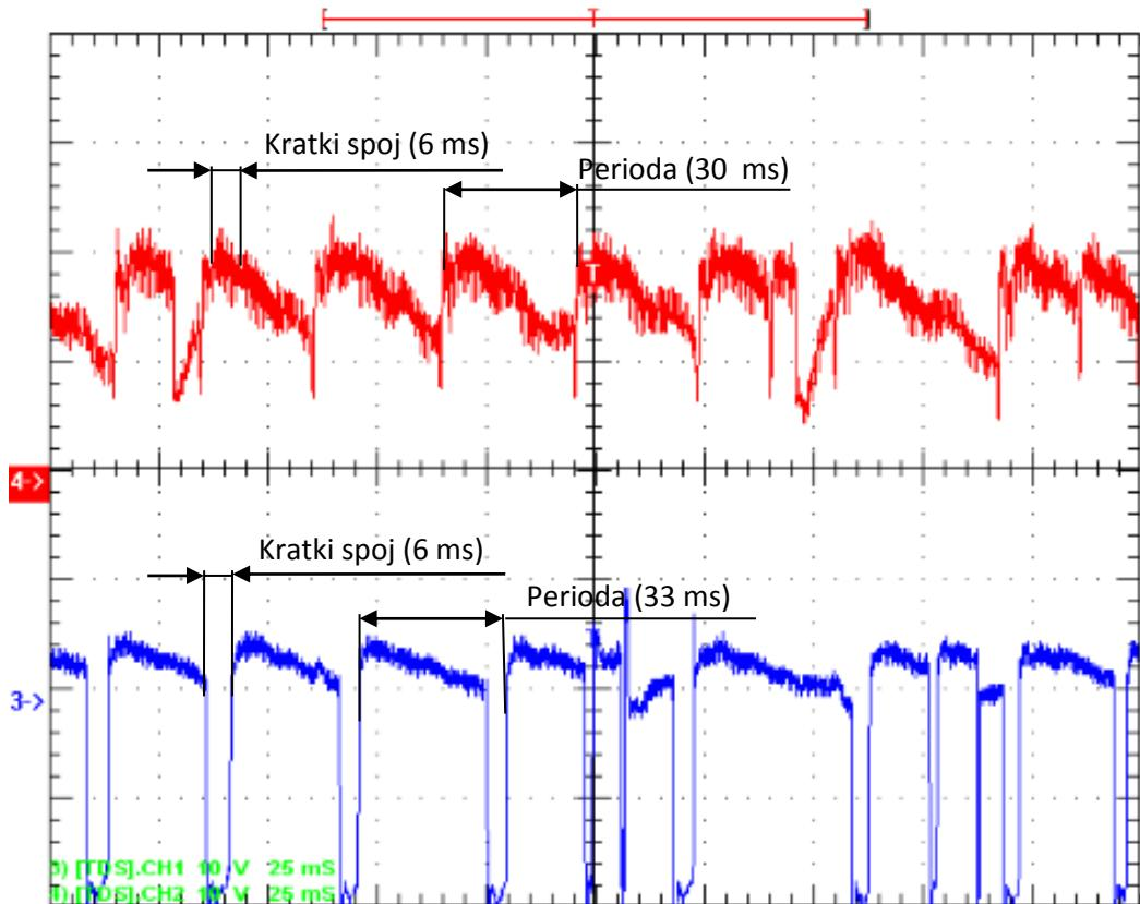
Slika 41. Oscilogram dinamičke karakteristike  $u,i=f(t)$  pri MAG navarivanju za slobodni kraj
