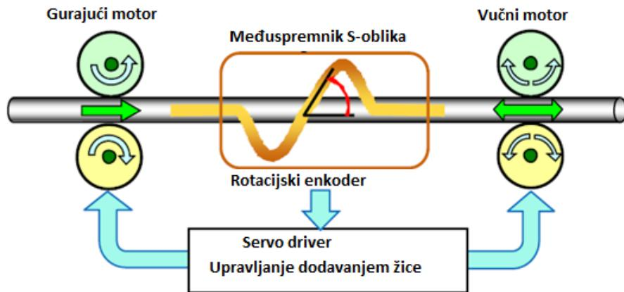
**Slika 27. Shematski prikaz BufferPositionControl sustava [22]**
