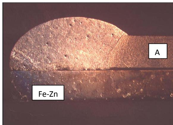
Slika 17. Makroizbrusak spoja aluminijskog i pocičanog lima izvedenog CMT postupkom [14]
