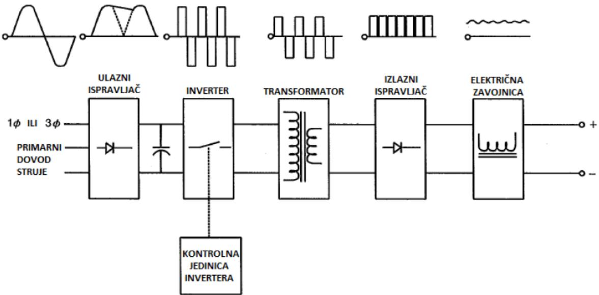
Slika 7. Blok dijagram inverterskog izvora struje [12]
