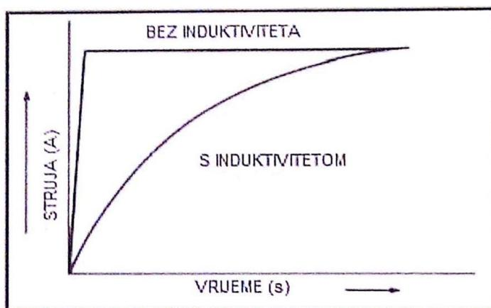
Slika 3. Utjecaj induktiviteta na promjenu struje [8]
