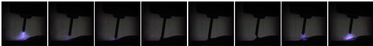
Slika 16. Slijed odvajanja kapljice kod CMT postupka [14]
