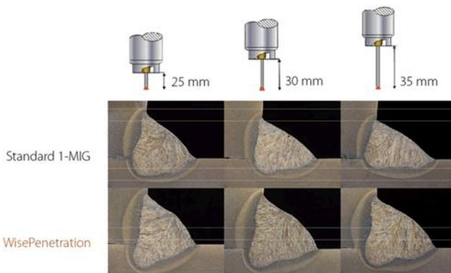
**Slika 22. Profil zavara uz promjene slobodnog kraja žice kod standardnog MAG postupka i primjenom WisePenetration funkcije [20]**
