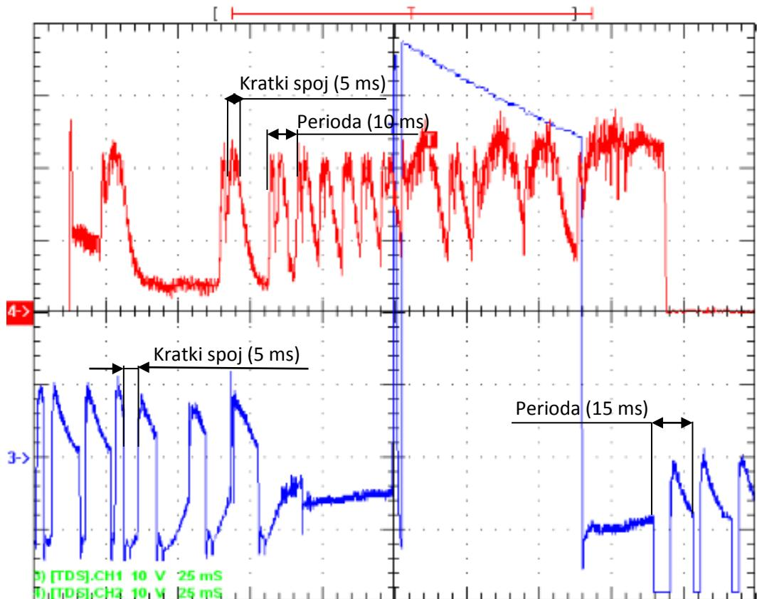
Slika 37. Oscilogram dinamičke karakteristike  $u,i=f(t)$  pri MAG navarivanju za slobodni kraj žice 12 mm i Korekcija visine luka za postavljenu vrijednost -10
