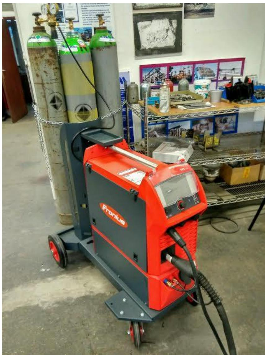
Slika 29. Izvor struje za zavarivanje Fronius TPS 320i
