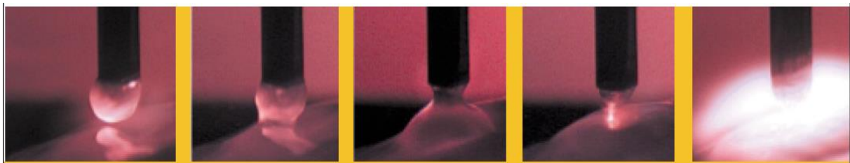
Slika 11. Slijed odvajanja kapljice pri STT zavarivanju [14]
