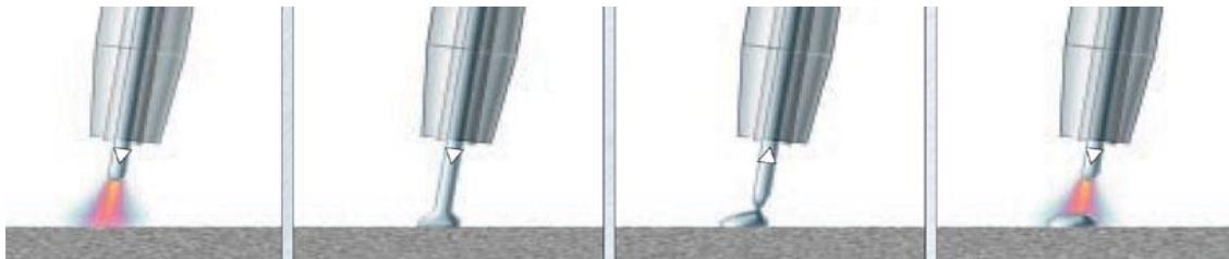
Slika 15. Shematski prikaz povratnog gibanja žice [14]
