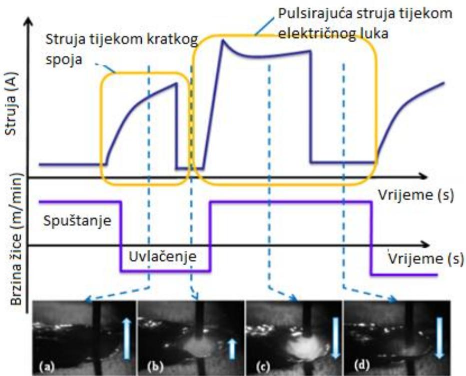
Slika 26. Princip PulsedDip Transfer Process pri zavarivanju u zaštiti CO<sub>2</sub> [22]
