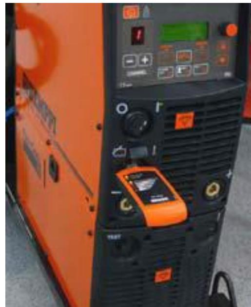
Slika 20. DataGun priključen na izvor struje za zavarivanje [19]
