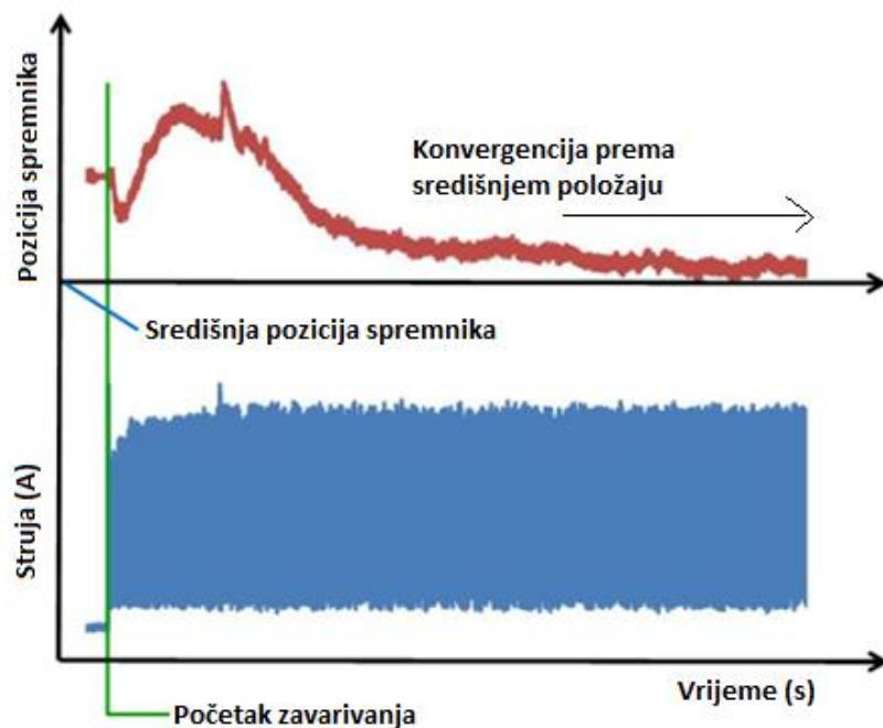
Slika 28. Efekt djelovanja BufferPositionControl-a [22]
