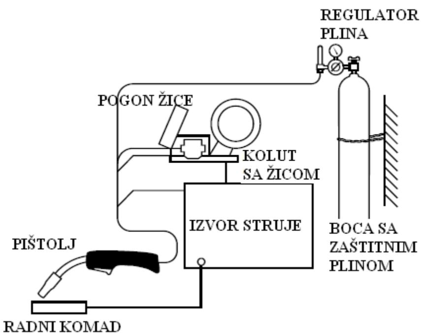
Slika 2. Oprema za MAG zavarivanje [4]
