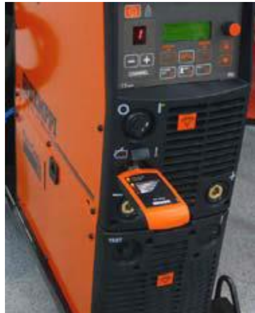
Slika 20. DataGun priključen na izvor struje za zavarivanje [19]
