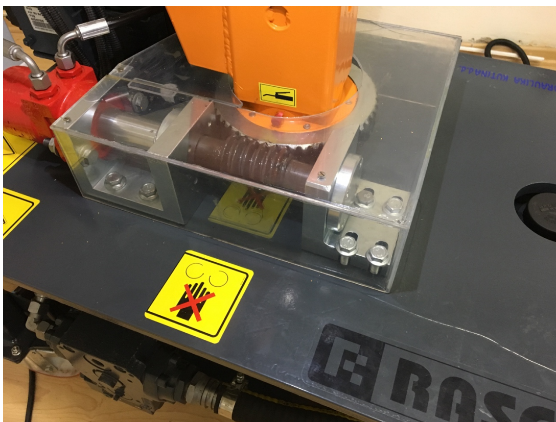
Slika 9. Spoj hidromotora i pužnog prijenosa za ostvarivanje rotacije postolja
