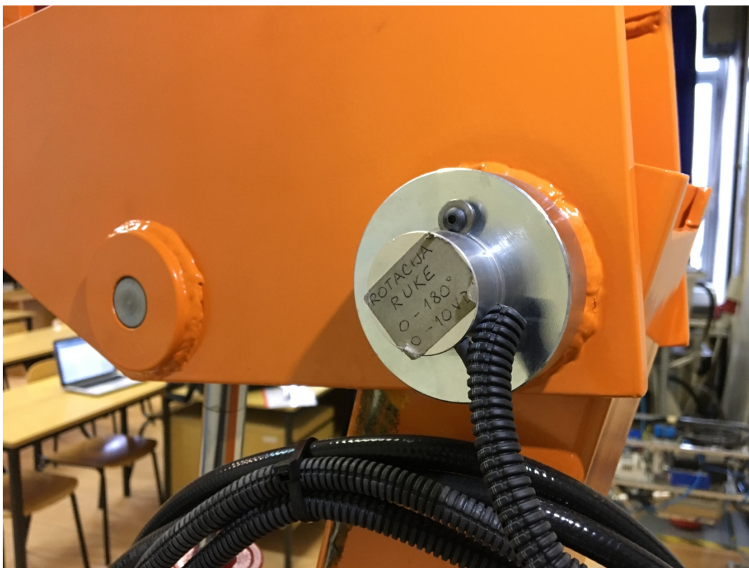
Slika 15. Rotacioni davač kuta zakreta ruke manipulatora
