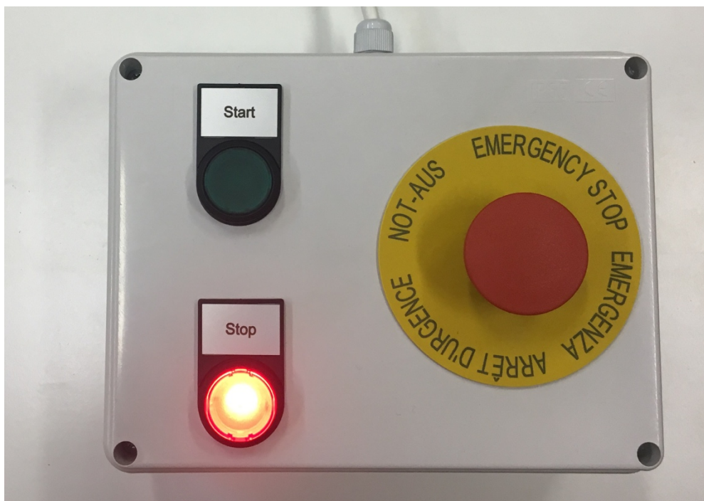
Slika 43. Signal isključenog napajanja ventilskog bloka
