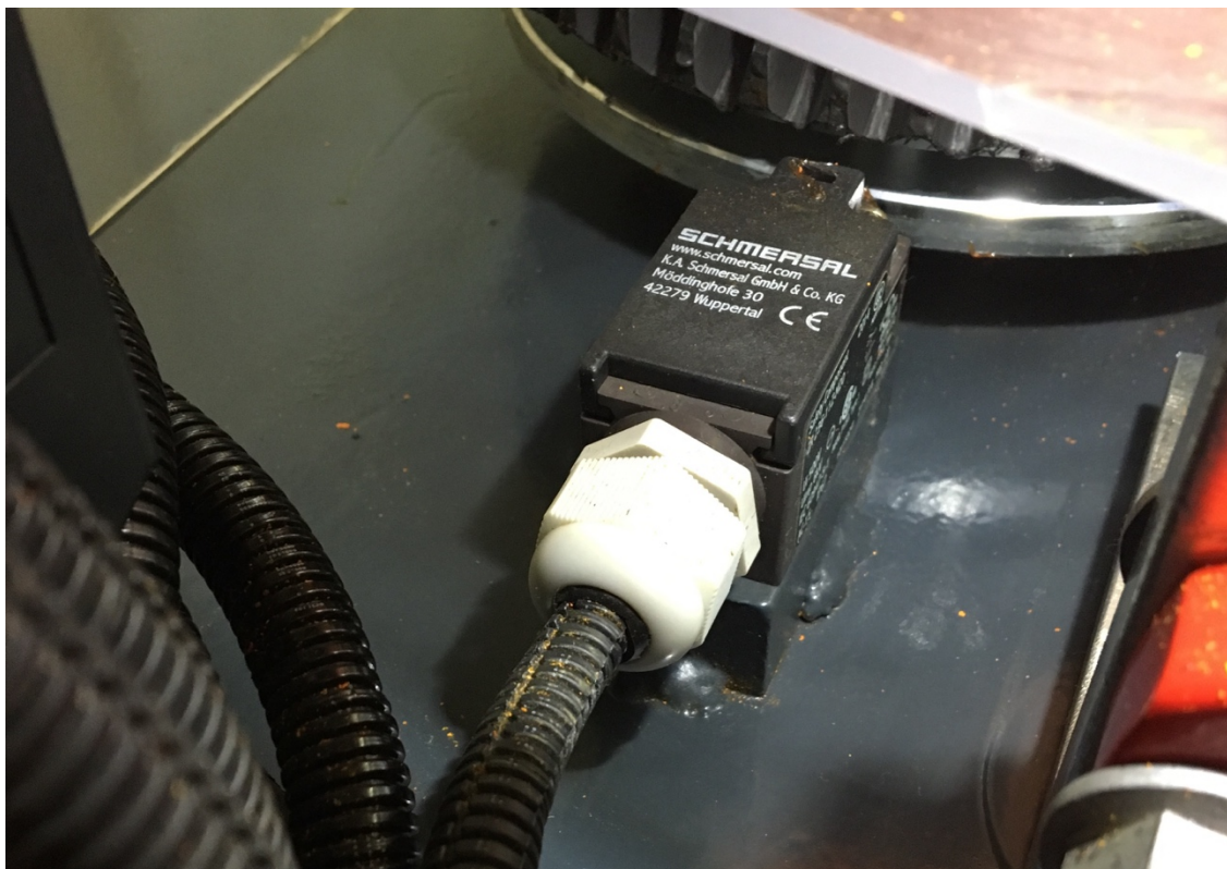
Slika 24. Schmersal prekidač graničnih položaja
