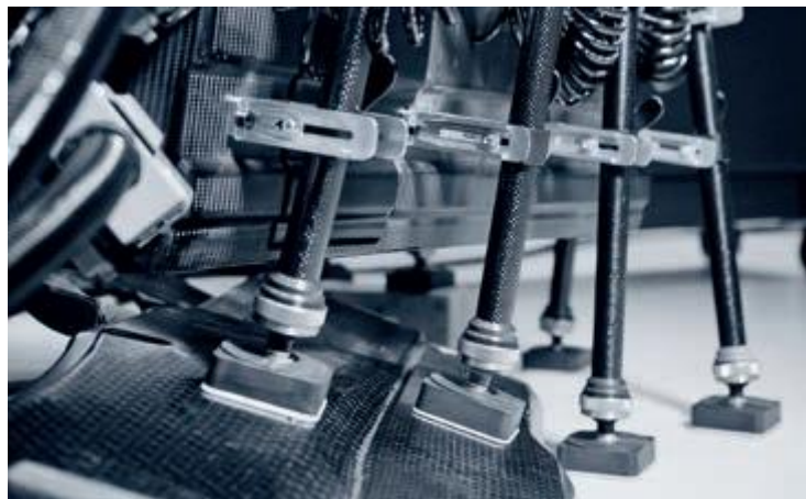
Slika 21. Vakuumske nožice s kuglastim zglobovima [13]
