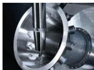
12: glodanje unutarnjih kružnih džepova
