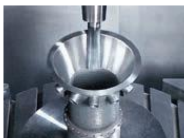
11: glodanje ruba i vanjske konture
