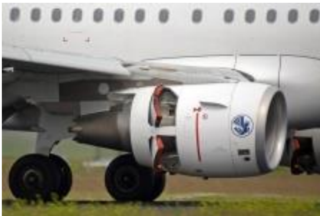
Slika 14. Obrnuti potisak motora [21]
