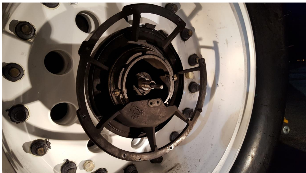
Slika 28. Skidanje nosača ventilatora
