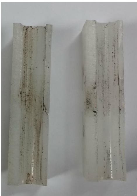
Slika 16. Alati nakon eksploatacije, s lijeva: polimerni (savijao bakar), polimerni (savijao nehrđajući čelik)
