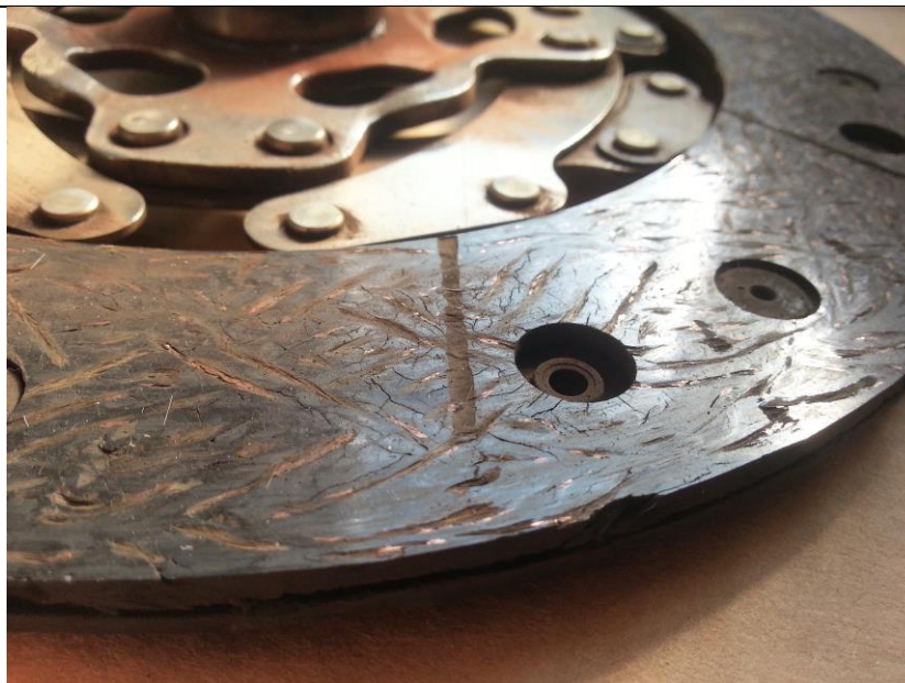
Slika 60. Tragovi trošenja na tanjuru tarne spojke
