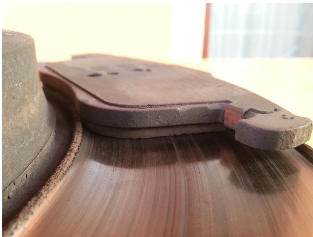
Slika 79. Prikaz kontakta tribološkog para kočionog diska i obloge
