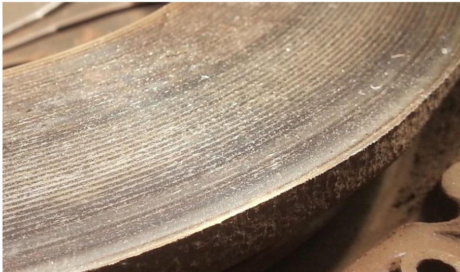
Slika 57. Tragovi trošenja na potisnoj ploči
