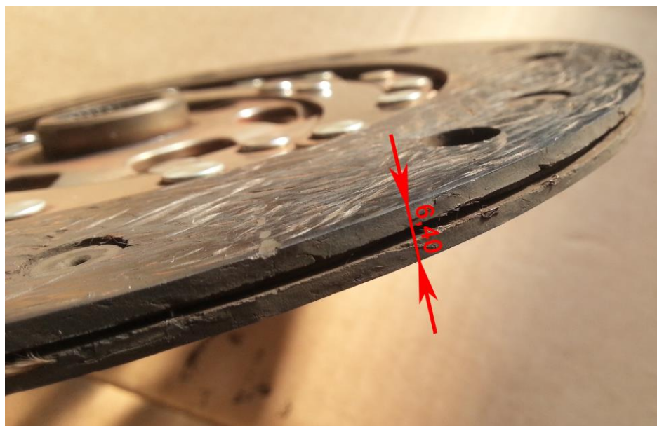
Slika 61. Debljina tanjura tarne spojke
