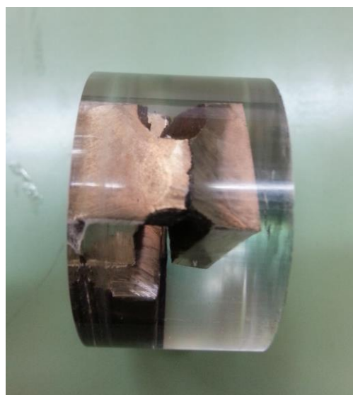
Slika 89. Napuknuće uzorka diska
