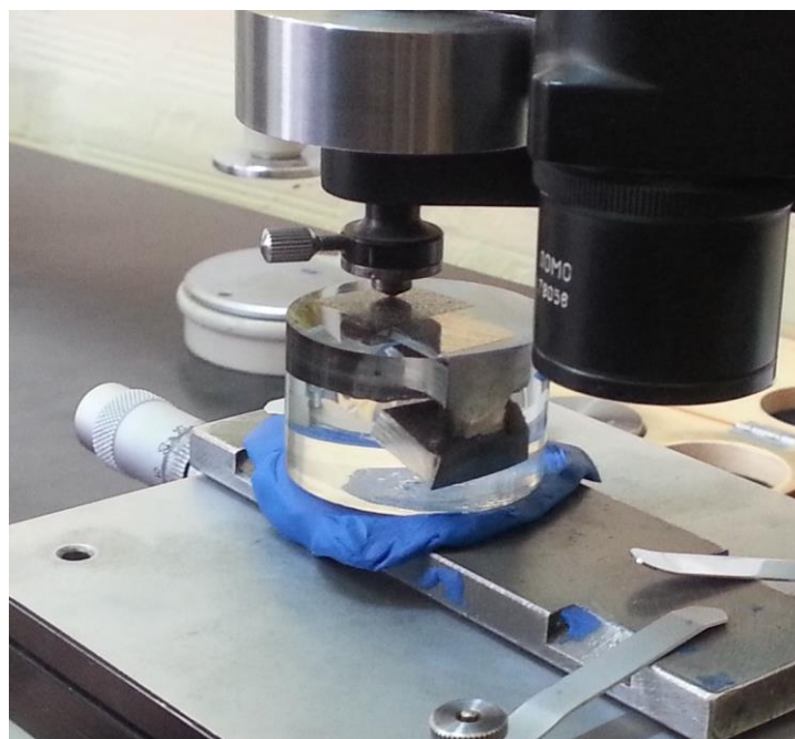
Slika 95. Uzorci tijekom ispitivanja tvrdoće
