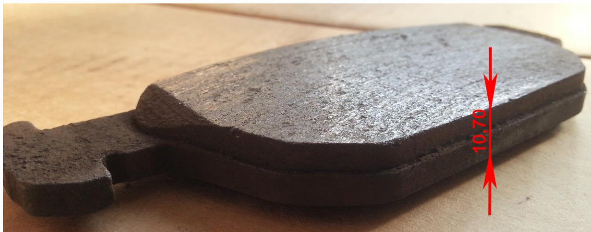
Slika 67. Debljina unutarnje strane vanjske kočione pločice 1
