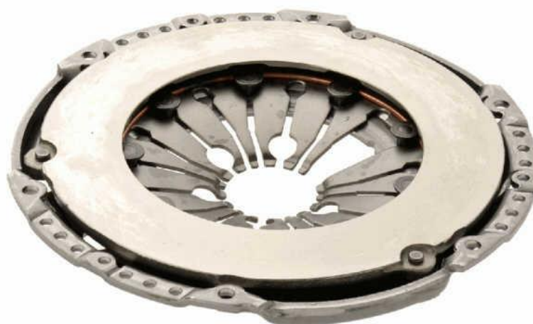
Slika 56. Novi set potisne ploče s potisnim ležajem
