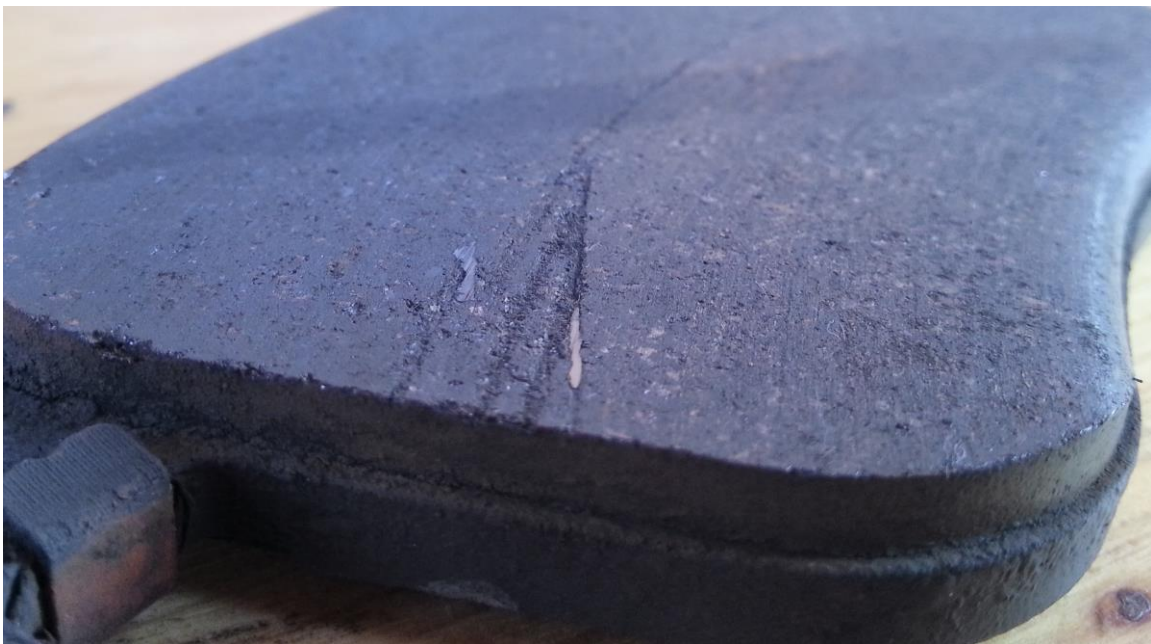
Slika 84. Trošena površina ispitivane kočione obloge
