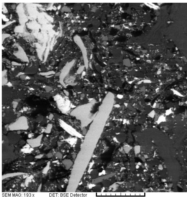
Slika 105. Prikaz površine uzorka kočione obloge
