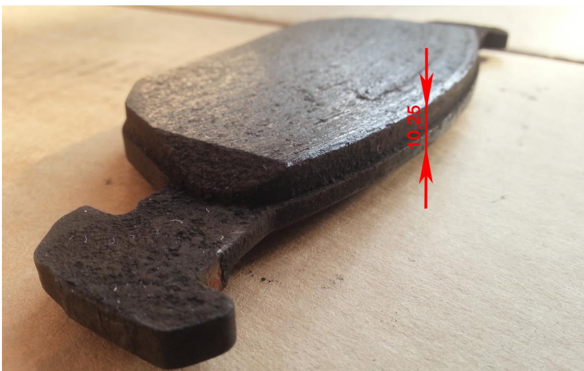
Slika 68. Debljina vanjske strane vanjske kočione pločice 1
