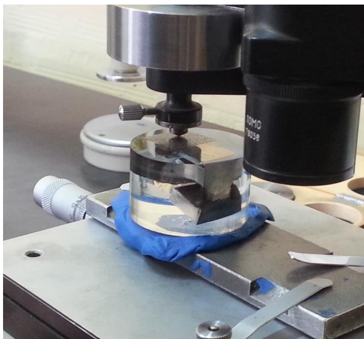
Slika 95. Uzorci tijekom ispitivanja tvrdoće
