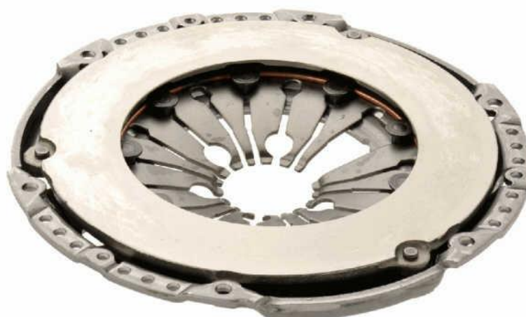
Slika 56. Novi set potisne ploče s potisnim ležajem
