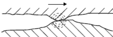
Slika 47. Faza I jediničnog događaja procesa klizanja [13]
