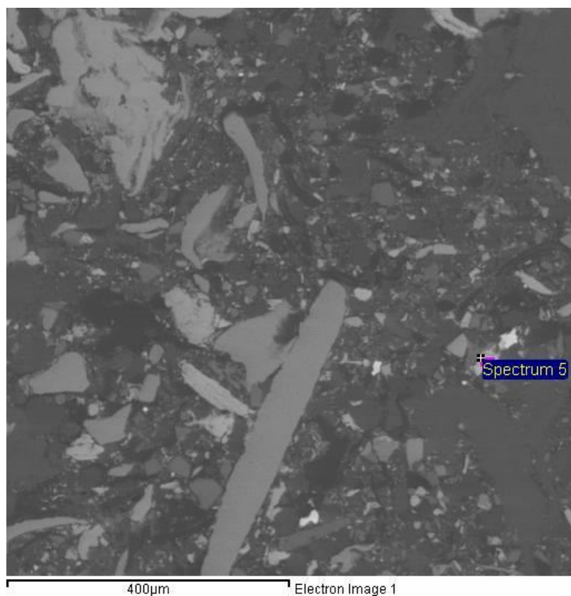
Slika 115. Područje četvrte analize površine uzorka kočione obloge
