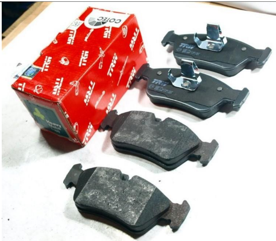
Slika 65. Nove kočione pločice [16]
