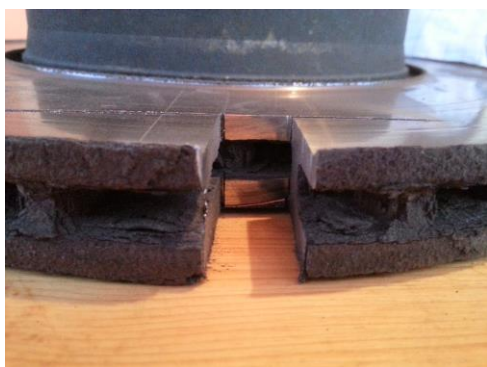
Slika 85. Mjesto izrezivanja uzorka diska
