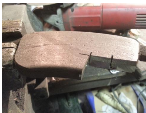
Slika 86. Mjesto izrezivanja uzorka obloge
