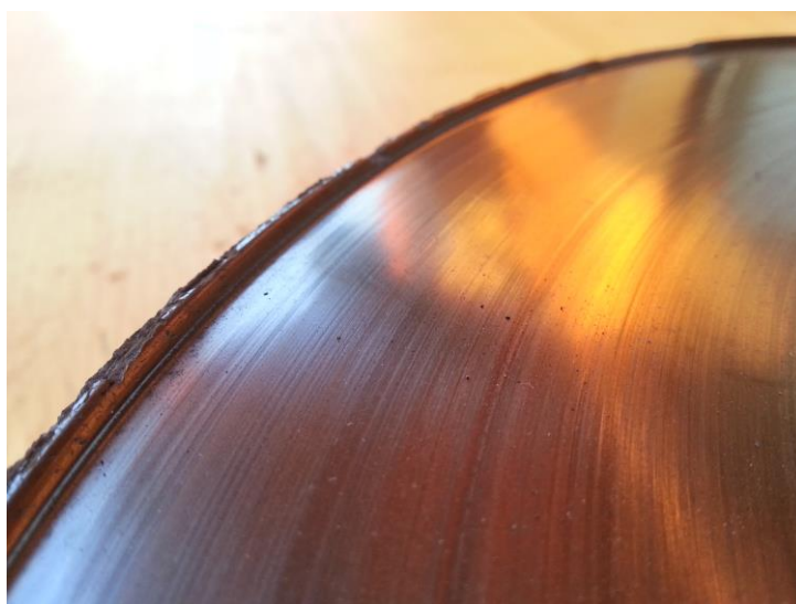
Slika 81. Trošena površina ispitivanog diska
