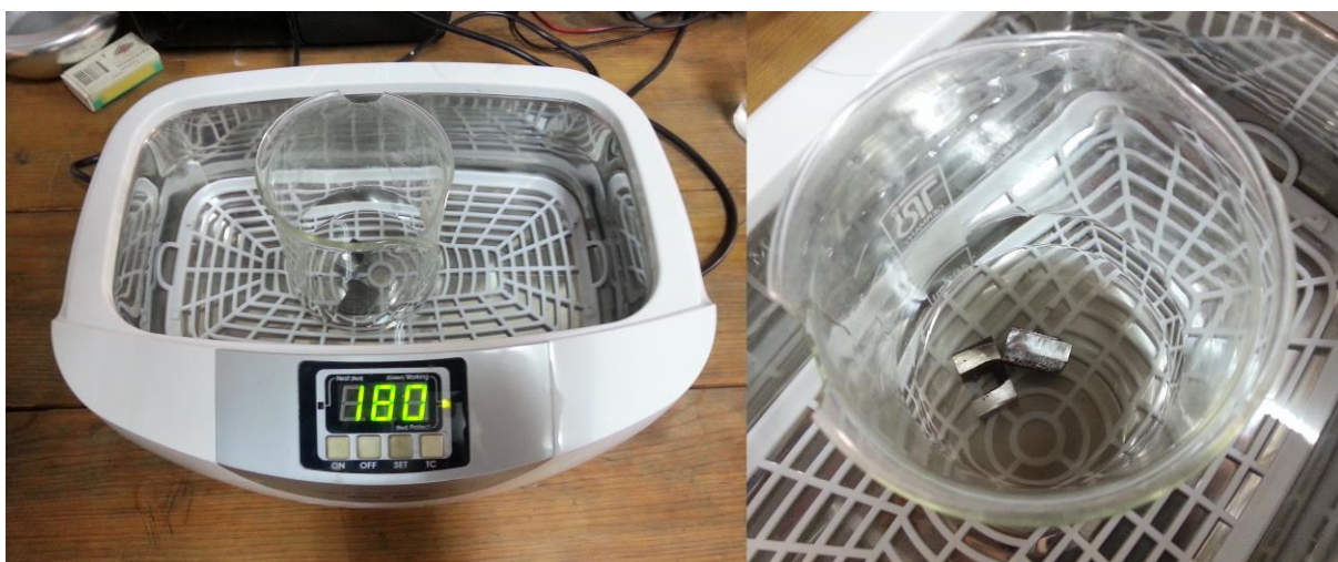
Slika 87. Ultrazvučni čistač s uzorcima u posudi – čišćenje 180 sekundi
