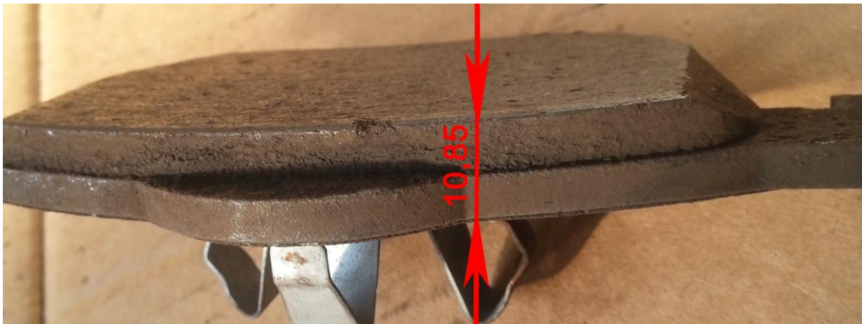
Slika 70. Debljina vanjske strane unutarnje kočione pločice 1
