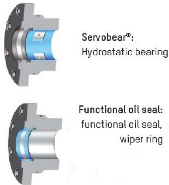
Slika 19. Sustav za vođenje i brtveni sustav cilindra [5]
