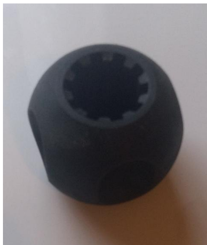
Slika 28. Glava homokinetičkog zgloba kardanskog vratila
