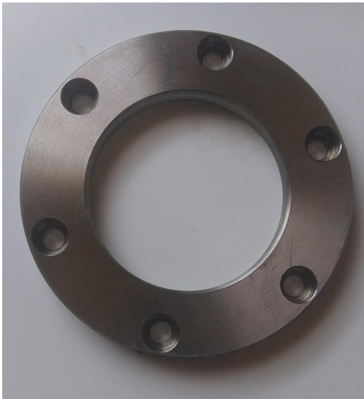
Slika 30. Poklopac kućišta kardanskog vratila
