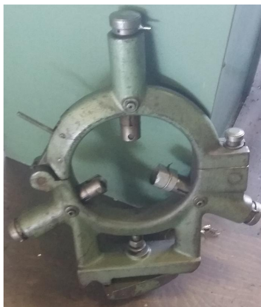
Slika 41. Stabilna (zatvorena) lineta
