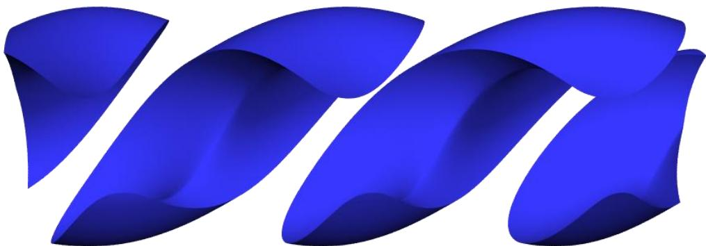
Slika 13. Prikaz šupljina unutar vijčano-ekscentrične pumpe [28]
