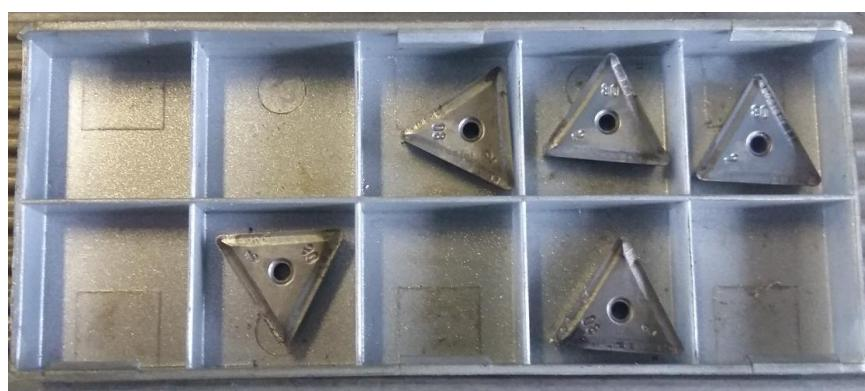
**Slika 47. Rezne pločice**
