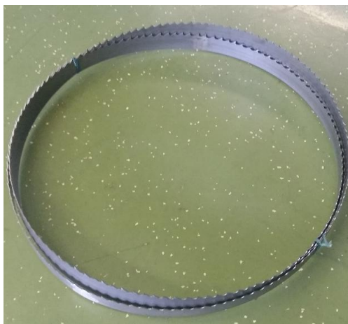
Slika 37. Rezna traka pile
