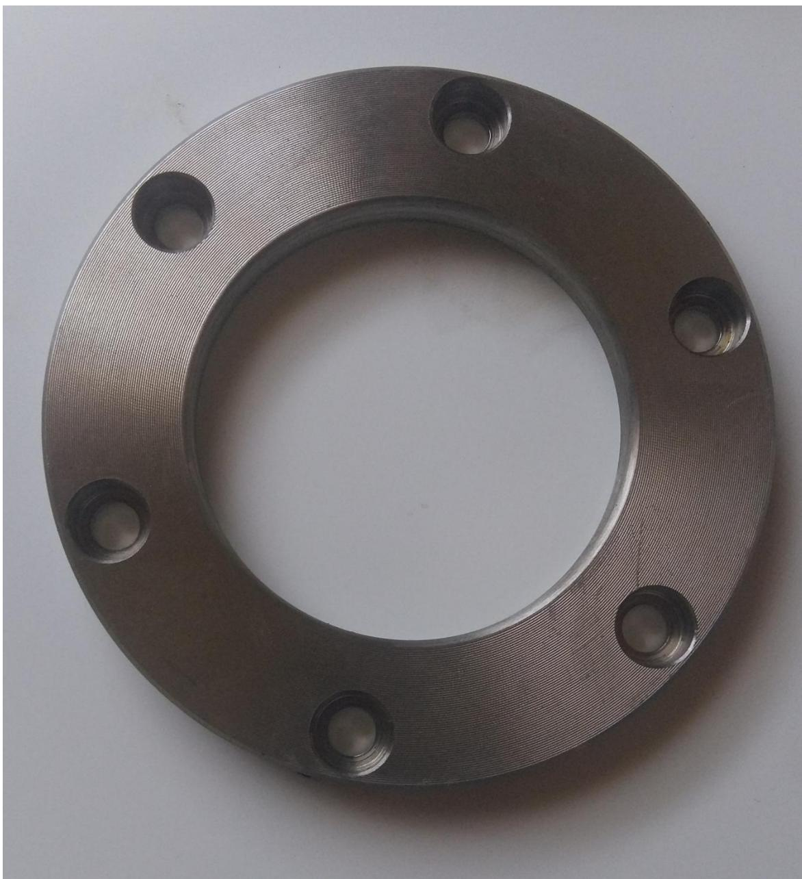
**Slika 30. Poklopac kućišta kardanskog vratila**
