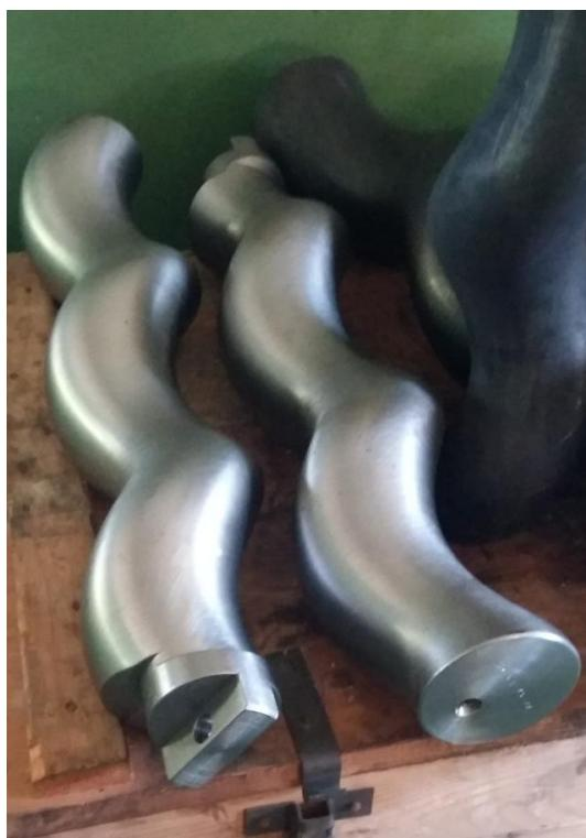
Slika 52. Konačni izgled rotora vijčano-ekscentrične pumpe
