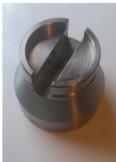
**Slika 23. Kućište kardanskog vratila**
