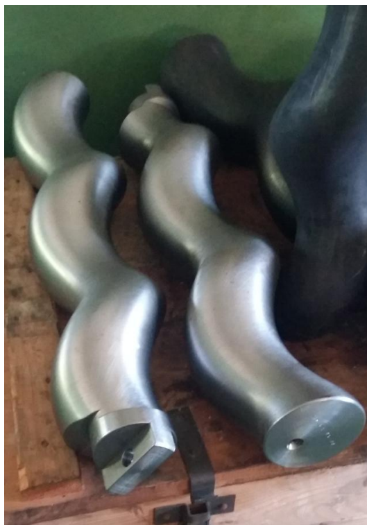
Slika 52. Konačni izgled rotora vijčano-ekscentrične pumpe
