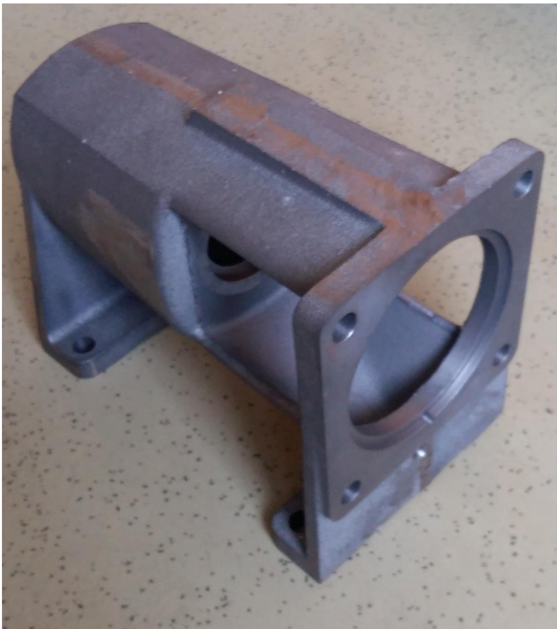
Slika 35. Kućište vijčano-ekscentrične pumpe
