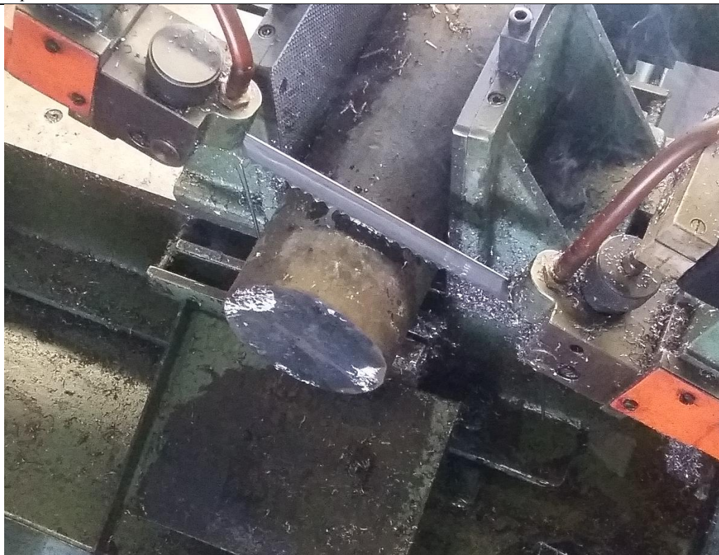
Slika 38. Tračno piljenje šipkastog materijala
