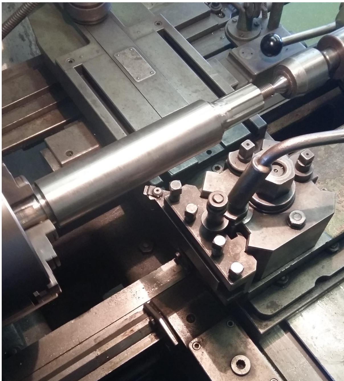
Slika 24. Tokarenje kardanskog vratila
