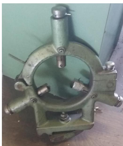
**Slika 41. Stabilna (zatvorena) lineta**
