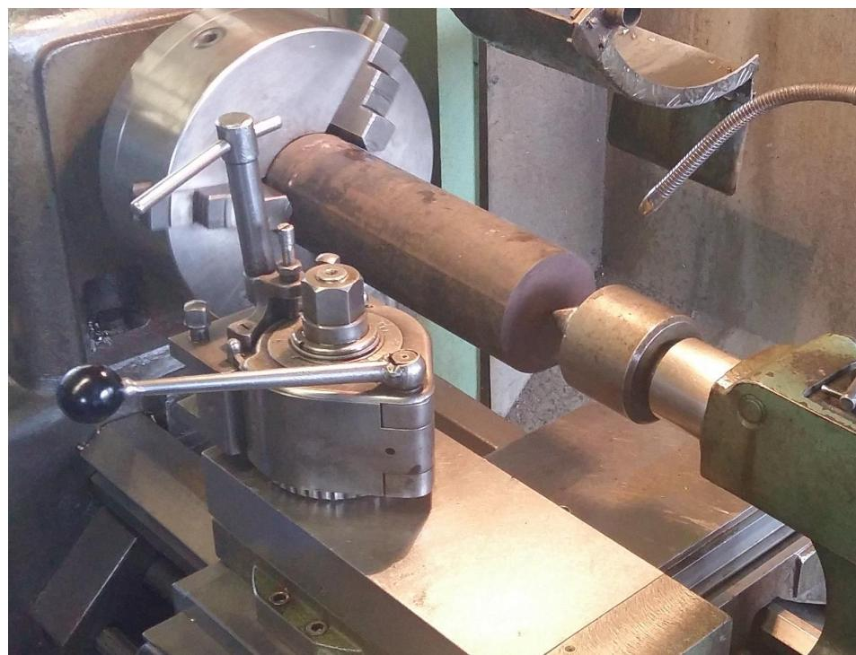
**Slika 39. Grubo tokarenje rotora vijčano-ekscentrične pumpe**
