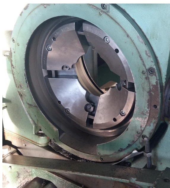
Slika 45. Ploča rotacijske naprave za obradu spirale rotora vijčano-ekscentrične pumpe
