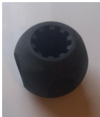
**Slika 28. Glava homokinetičkog zgloba kardanskog vratila**
