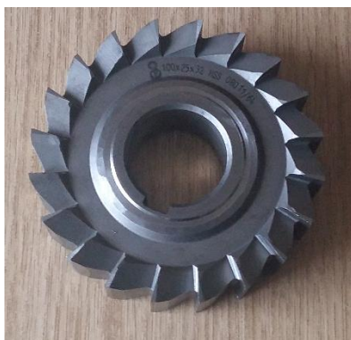
Slika 42. Glodalo za obradu glave rotora vijčano-ekscentrične pumpe
