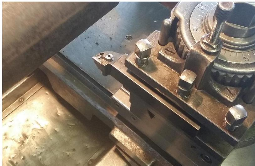
**Slika 40. Alat za grubo tokarenje rotora vijčano-ekscentrične pumpe**
