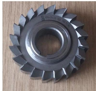
**Slika 42. Glodalo za obradu glave rotora vijčano-ekscentrične pumpe**
