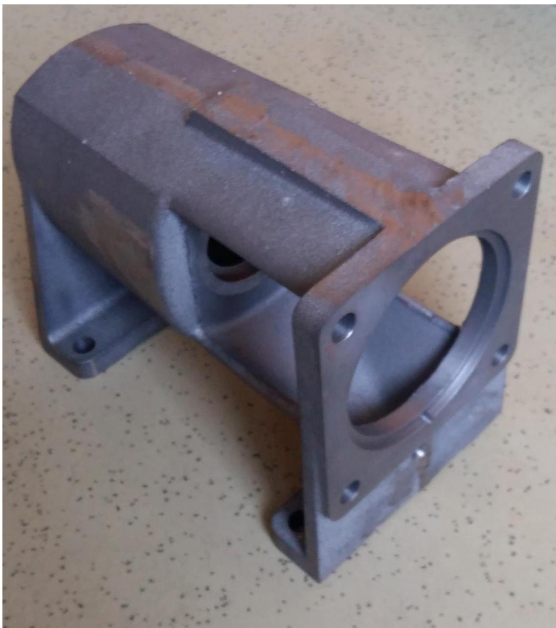
**Slika 35. Kućište vijčano-ekscentrične pumpe**
