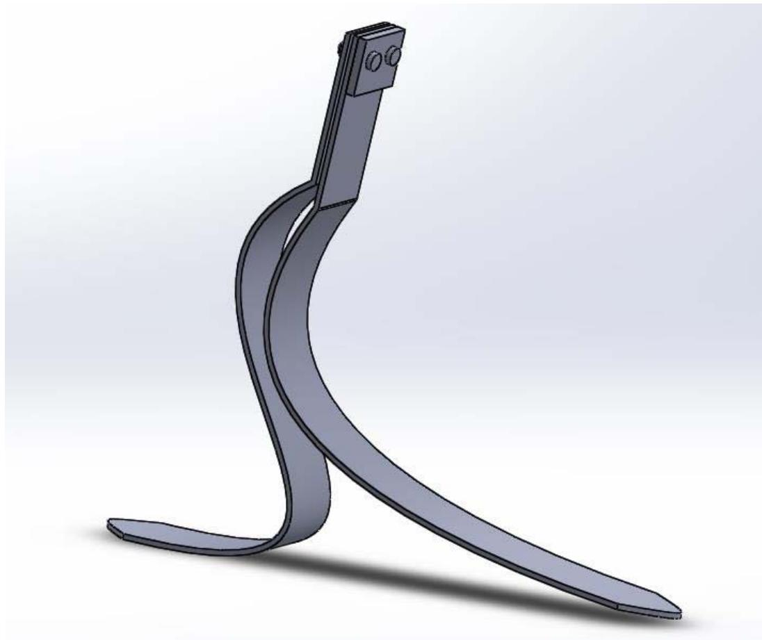
Slika 25. Izometrijski prikaz 3D modela montažne proteze
