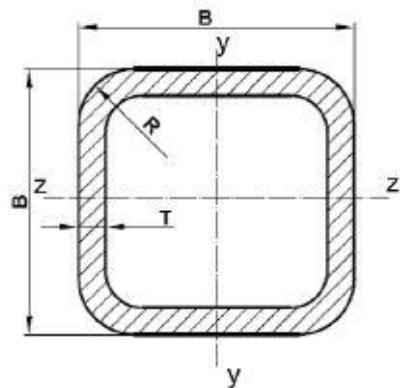
**Slika 41. Profil vertikalnog stupa**
