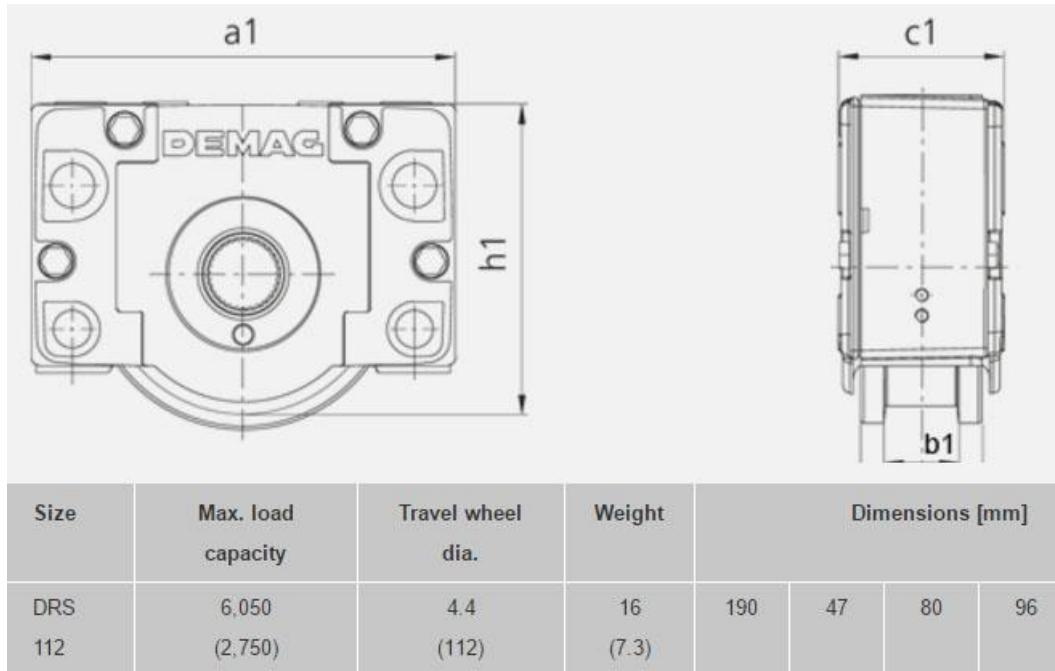
**Slika 40. Karakteristike kotača na gornjem uzdužnom nosaču**
