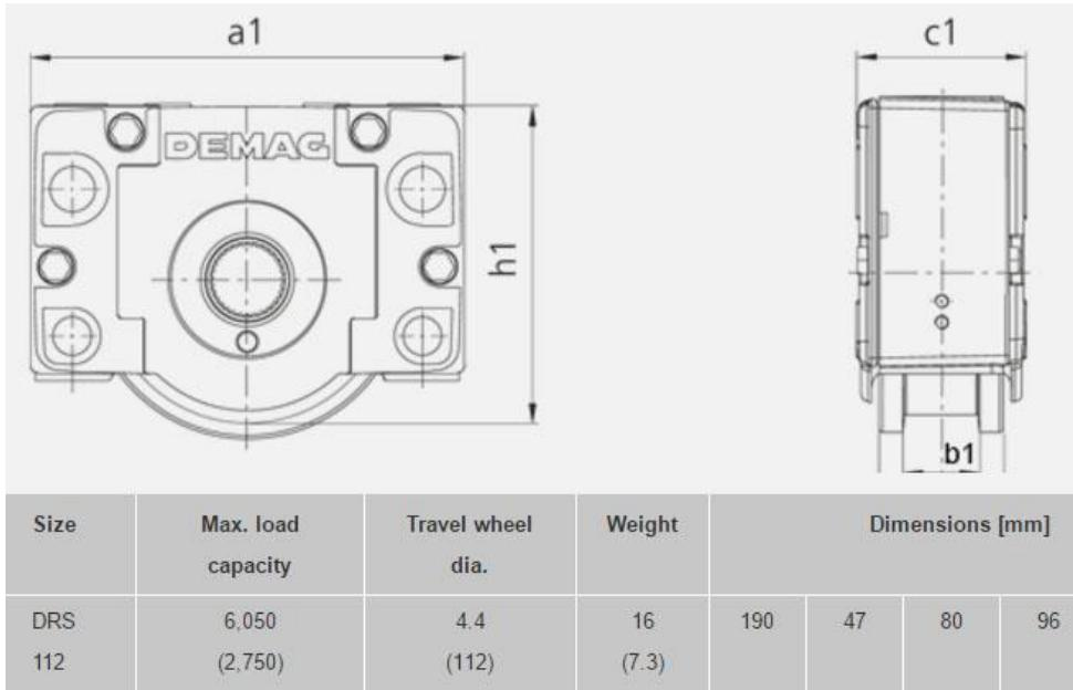
**Slika 43. Karakteristike bočnog kotača na donjem uzdužnom nosaču**
