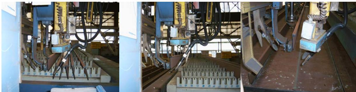
Slika 3.3.9 Dohvat i pozicioniranje profila
