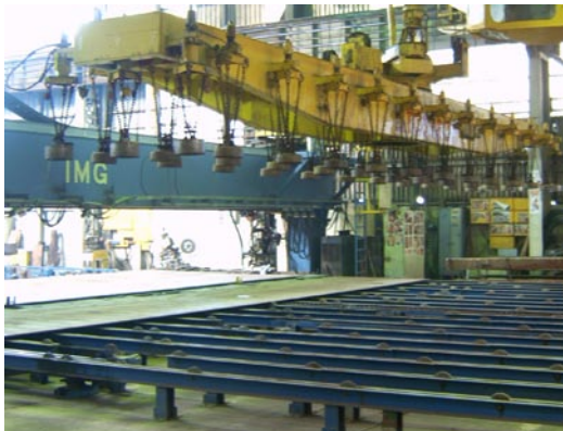
Slika 3.3.1 postavljanje drugog lima
