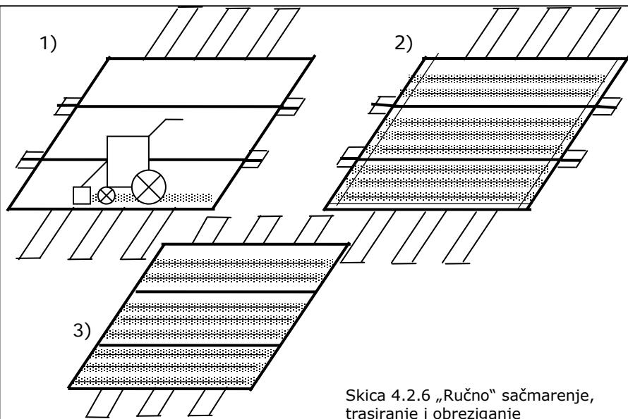
Skica 4.2.6 „Ručno“ sačmarenje, trasiranje i obrezivanje
