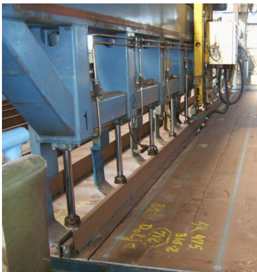
Slika 3.3.10 Pritiskivanje i privarivanje profila
