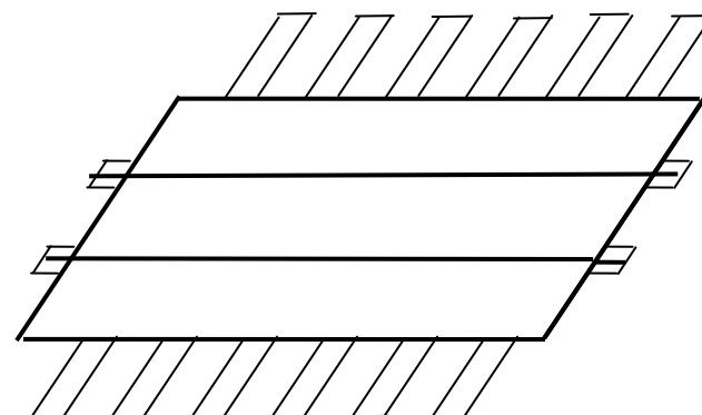
Skica 4.2.4 Opločenje panela nakon zavarivanja prve strane
