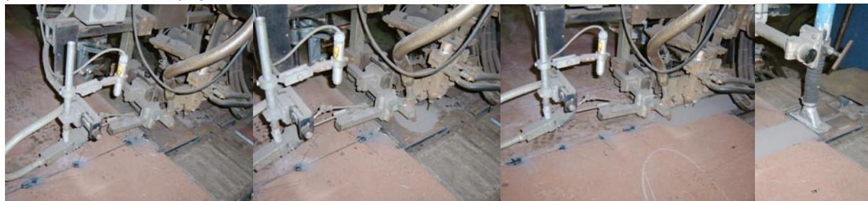
Slika 3.3.4 automatsko zavarivanje limova
