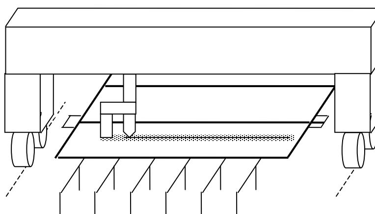
Skica 4.2.5 Stroj za sačmarenje, trasiranje i obrezivanje na panel liniji
