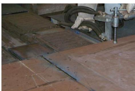
Slika 3.3.3 Priprema za zavarivanje lima
