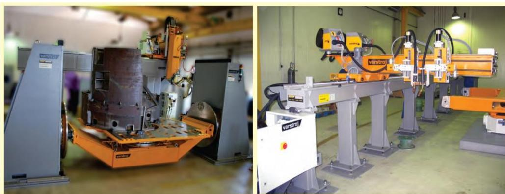
Slika 13. Primjer robotiziranog (lijevo) i automatiziranog (desno) zavarivanja [17]
