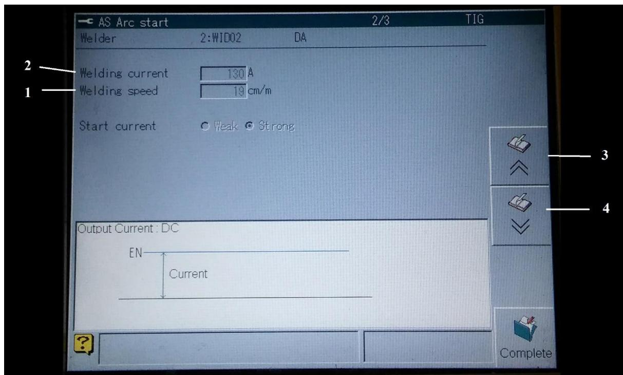
Slika 37. Određivanje parametara zavarivanja (stranica 2)
