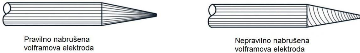
Slika 9. Izgled pravilno i nepravilno nabrušene volframove elektrode [10]
