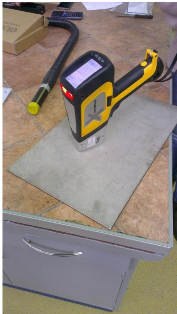
Slika 32. Ispitivanje kemijskog sastava ploče AISI 304
