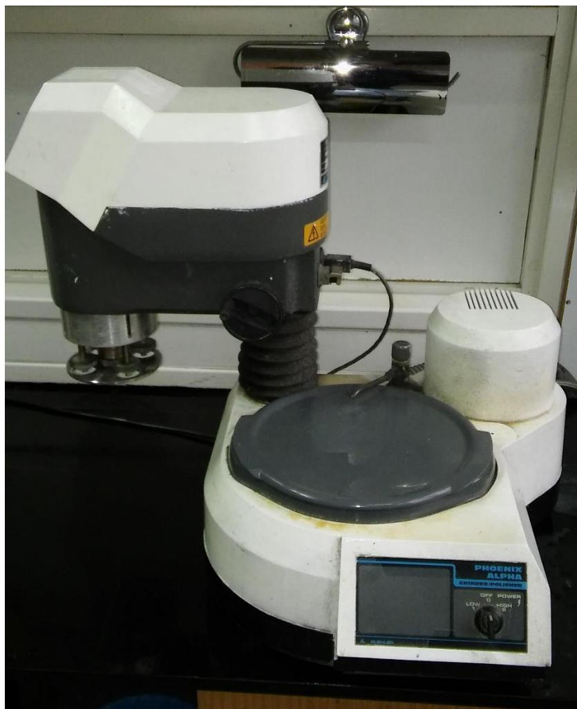
Slika 56. Poliranje uzorka na uređaju za poliranje Buehler Phoenix Alpha
