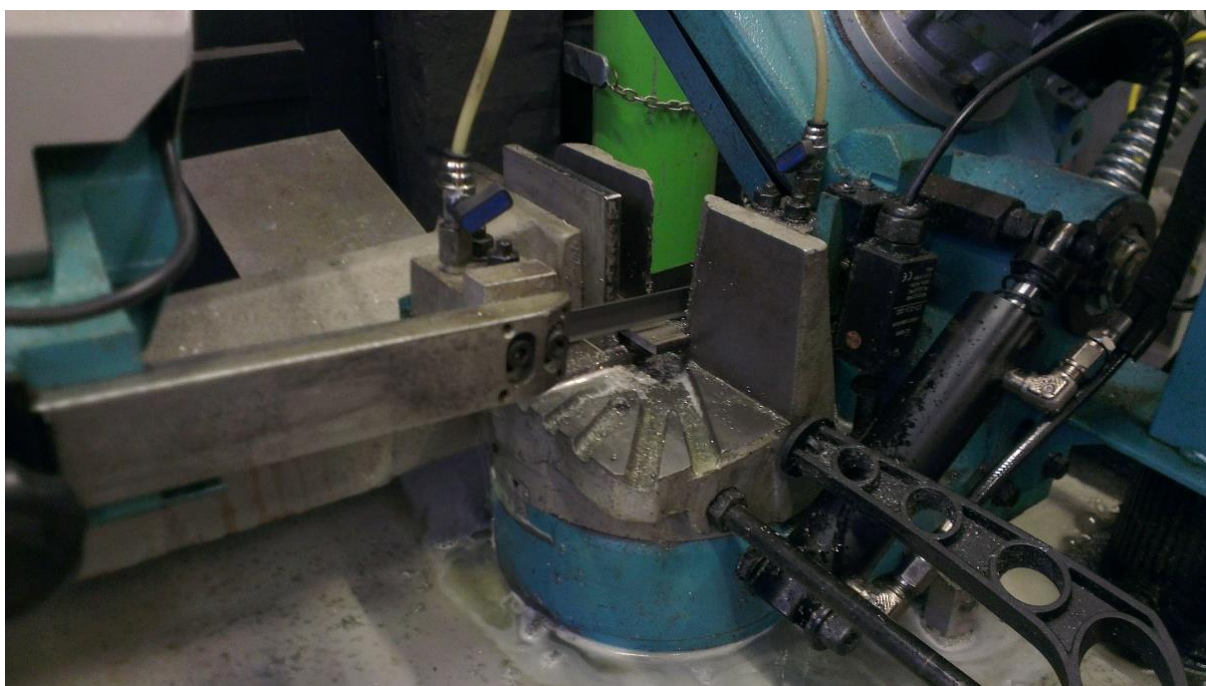
Slika 55. Izrezivanje makroizbrusaka na tračnoj pili IMET GBS 185 ECO
