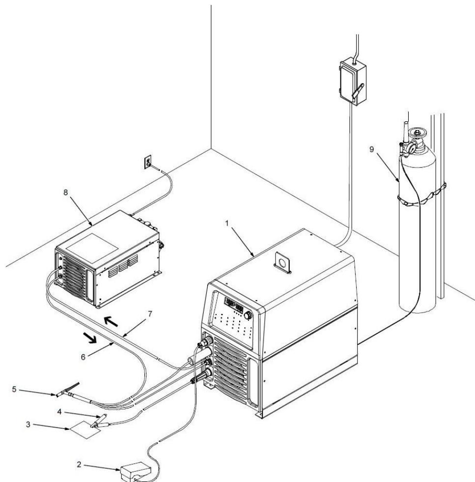
Slika 1. Osnovni dijelovi uređaja za ručno TIG zavarivanje [2]
