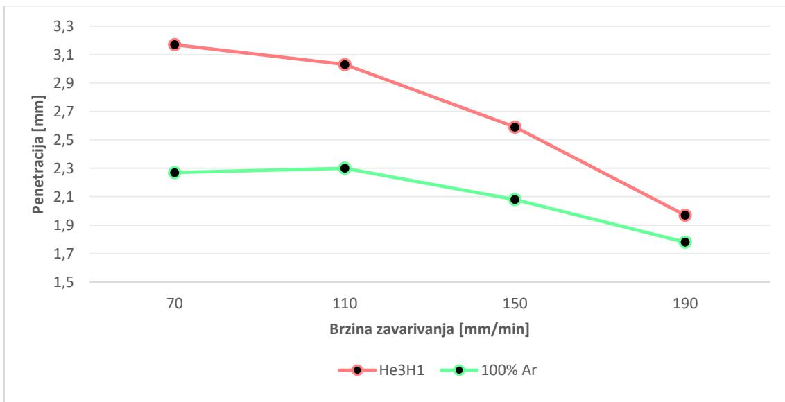
Slika 68. Grafički prikaz utjecaja penetracije o brzini zavarivanja
