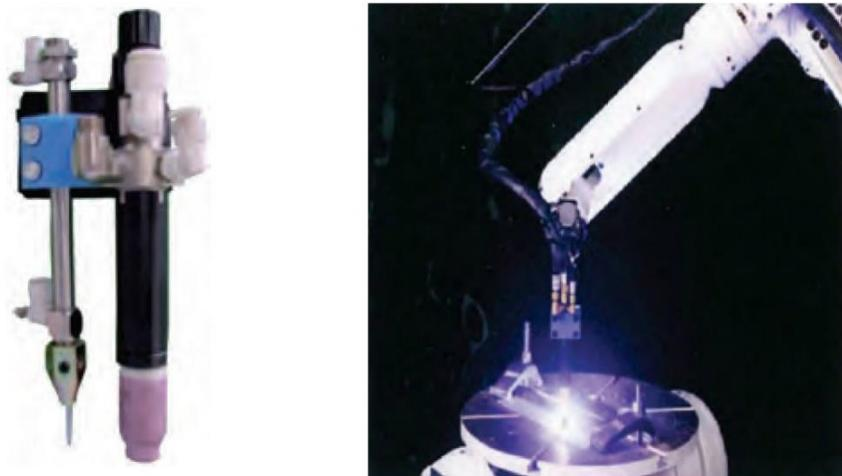
Slika 30. Mehanički kontaktni senzor (slika lijevo) i senzor za praćenje napona i struje električnog luka prilikom njihanja (slika desno) [17]
