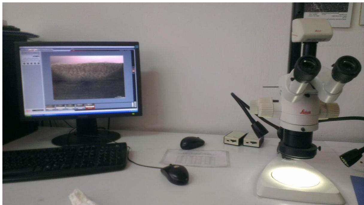
Slika 57. Snimanje makroizbrusaka korištenjem Leica MZ6 stereomikroskopa
