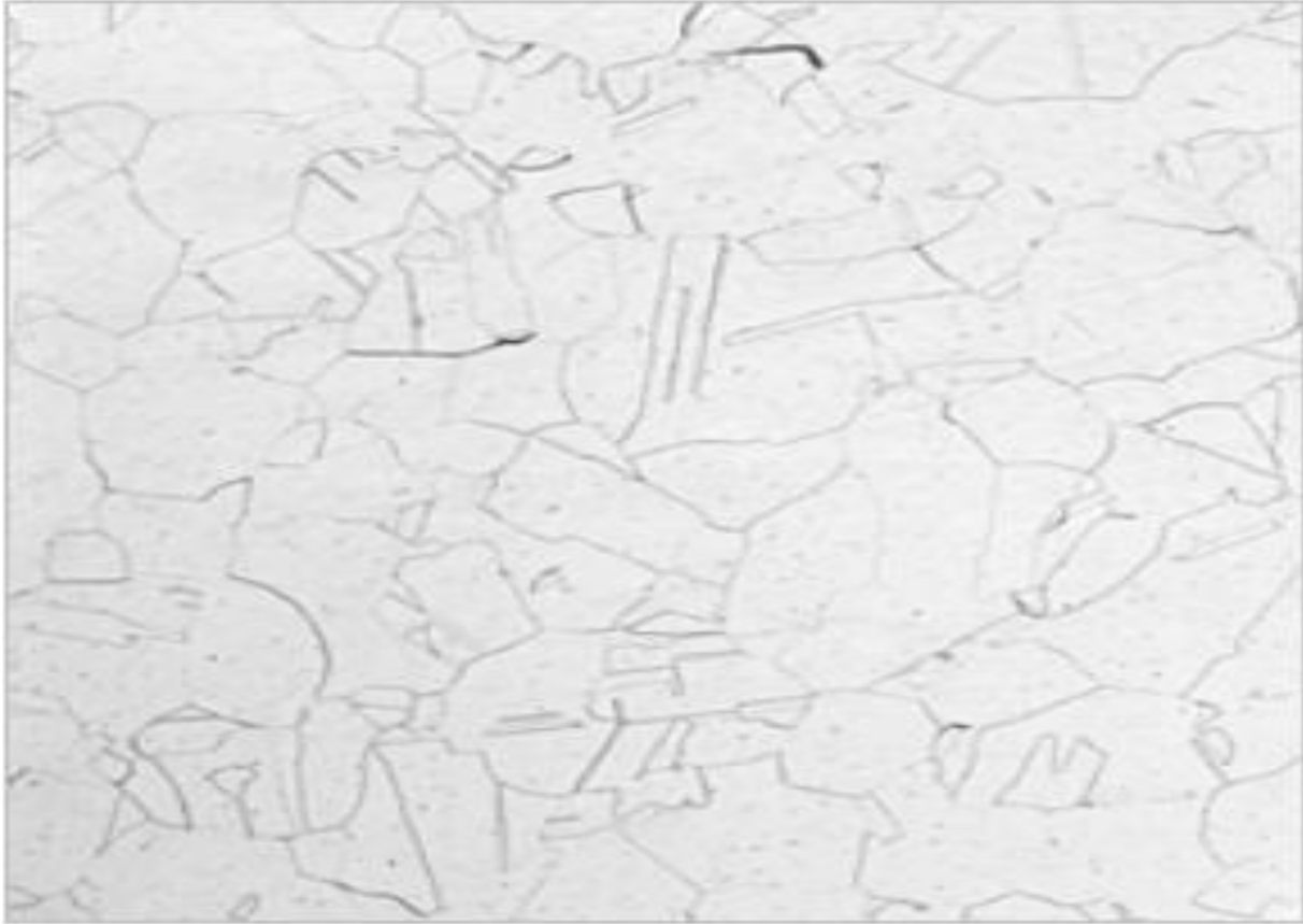
Slika 2. Mikrostruktura austenitnog nehrđajućeg čelika [4]
