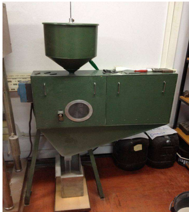
Slika 8. Uređaj za mjerenje otpornosti na abrazijsko trošenje metodom "suhi pijesak/gumeni kotač" (Laboratorij za tribologiju FSB-a)
