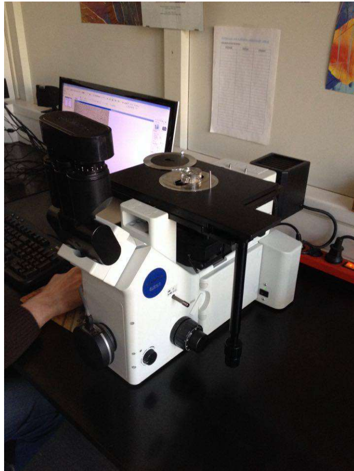
Slika 19. Svjetlosni mikroskop OLYMPUS GX51
