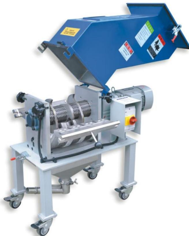
Slika 8. MTLS-250- podignuto kućište
