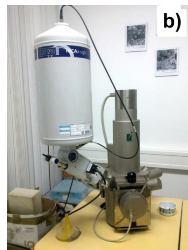
Slika 4.6 a) naporivač Quorum SC7620 i b) pretražni elektronski mikroskop Tescan Vega TS5136MM
