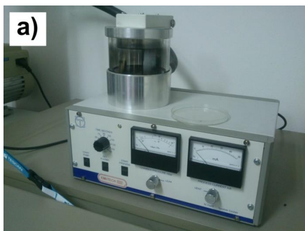
Slika 4.6 a) naporivač Quorum SC7620 i b) pretražni elektronski mikroskop Tescan Vega TS5136MM
