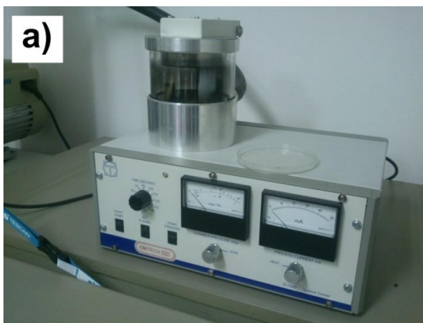
Slika 4.6 a) naporivač Quorum SC7620 i b) pretražni elektronski mikroskop Tescan Vega TS5136MM
