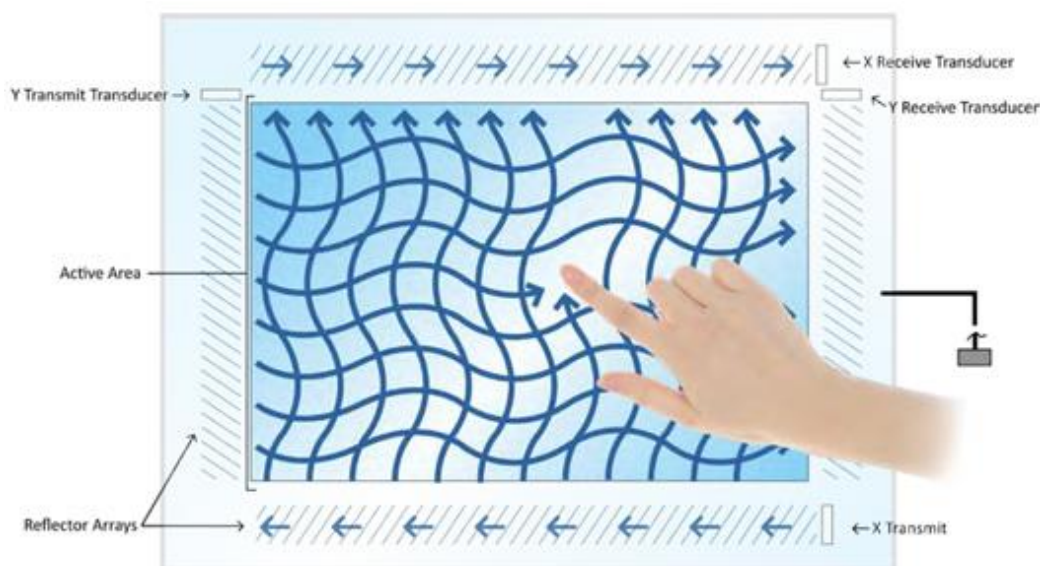
Slika 12. Zaslone sa površinskim zvučnim valovima [14]
