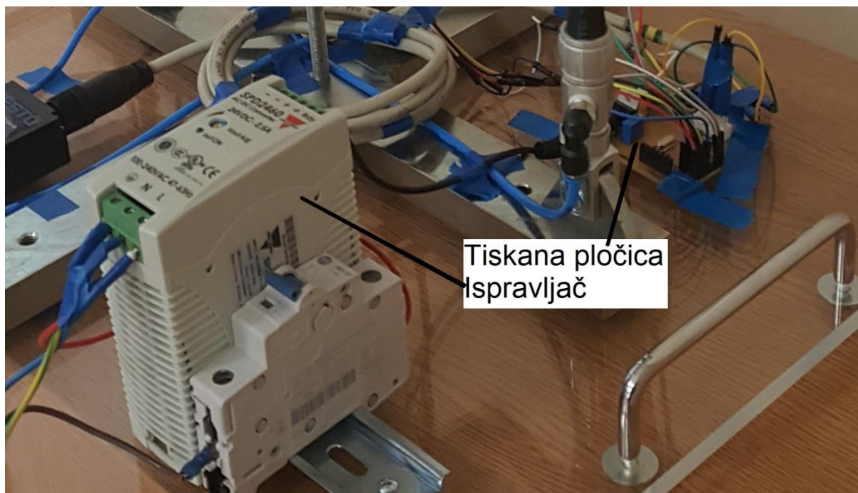
Slika 22. Ispravljač i tiskana pločica
