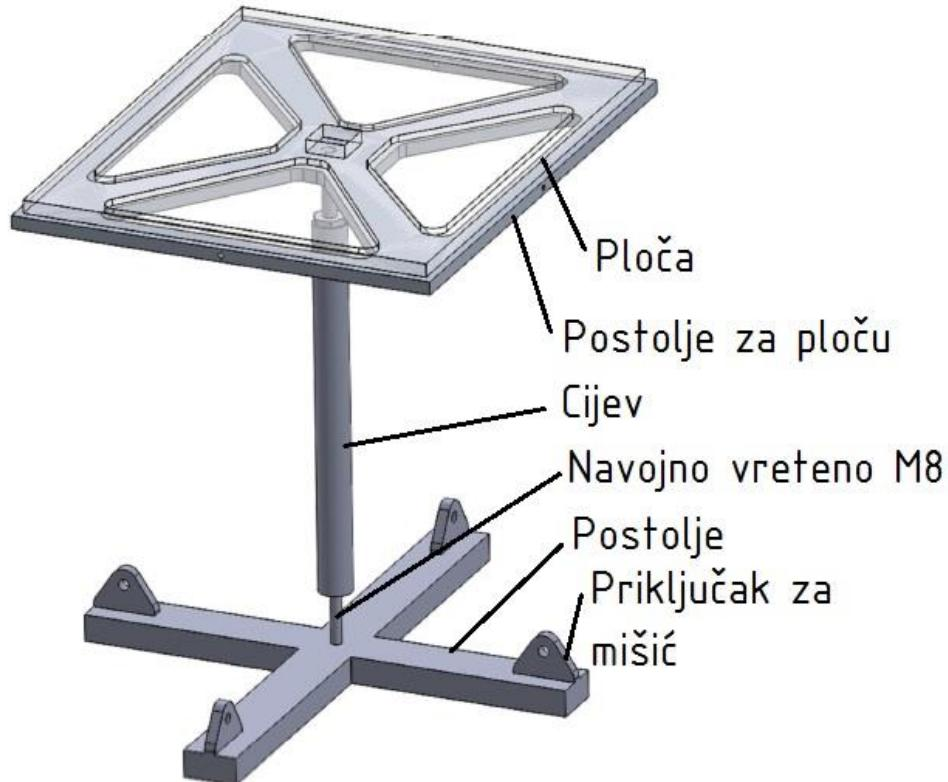
**Slika 2. Konstrukcija sustava kuglice na ploči**
