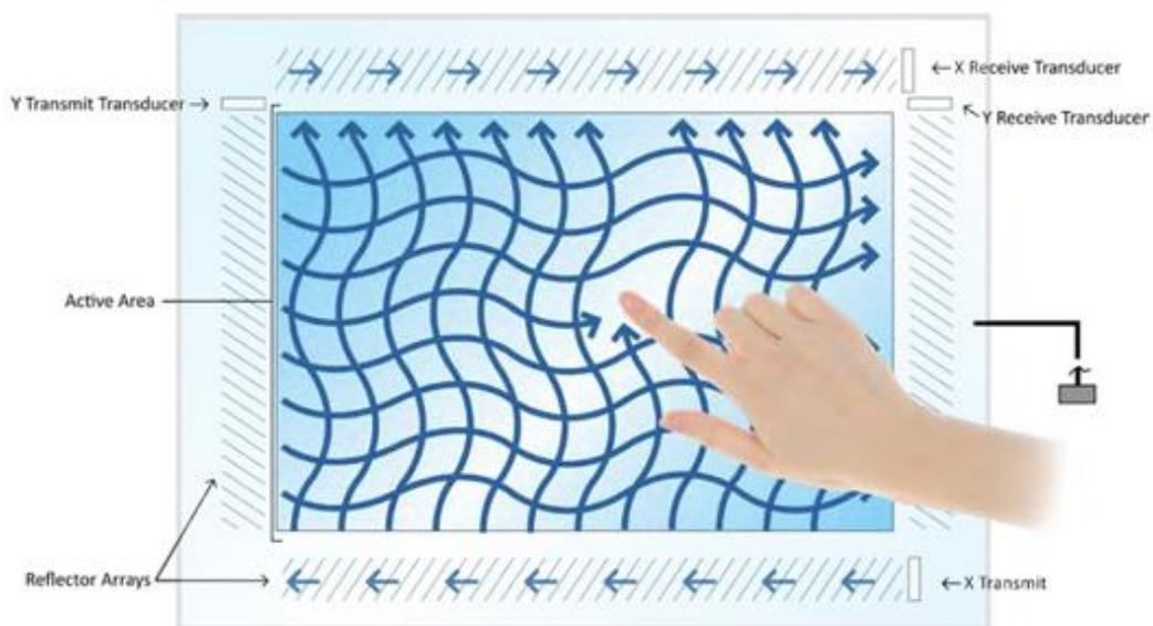
**Slika 12. Zaslon sa površinskim zvučnim valovima [14]**
