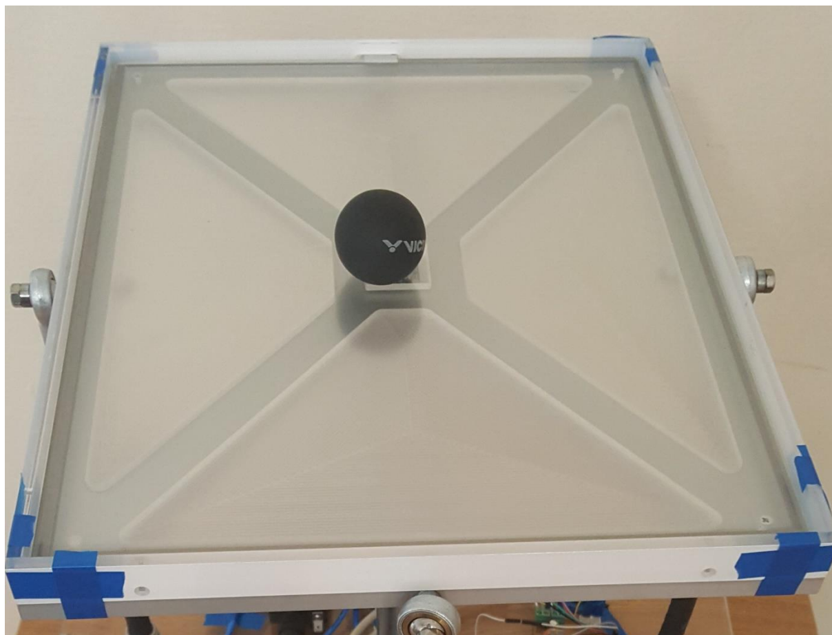
Slika 21. Zaslou osjetljiv na dodir na nastavnoj maketi
