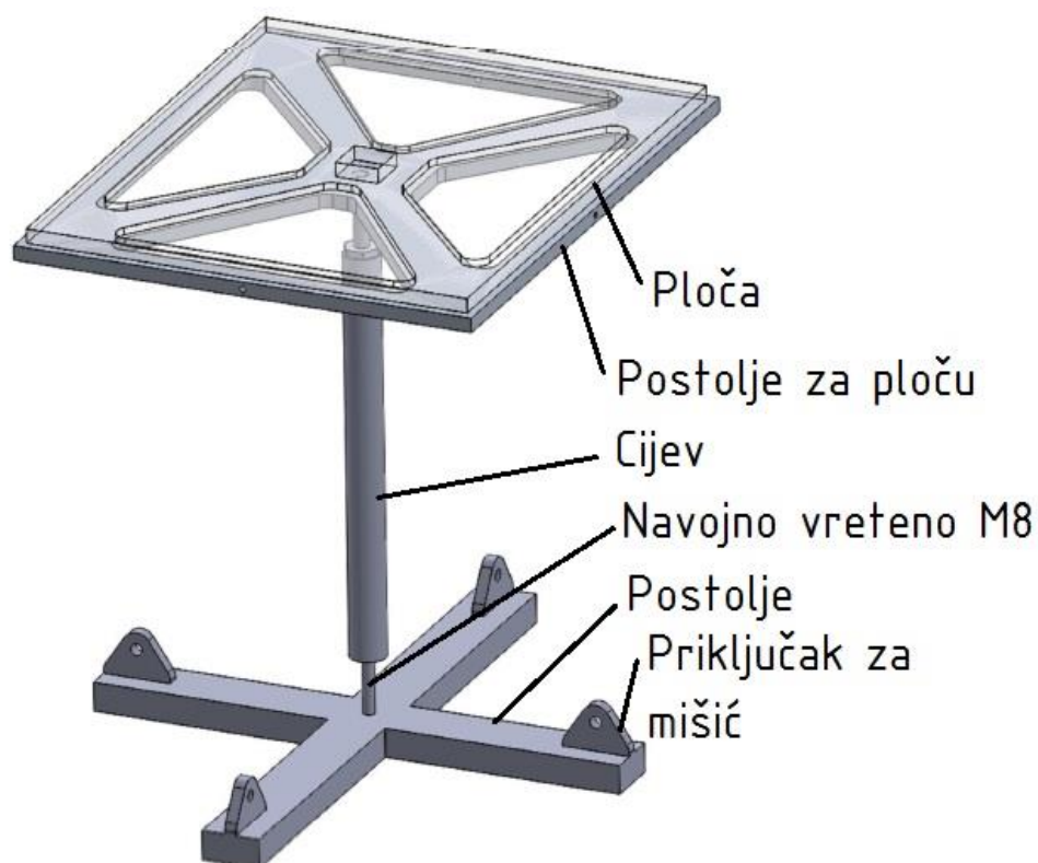
Slika 2. Konstrukcija sustava kuglice na ploči
