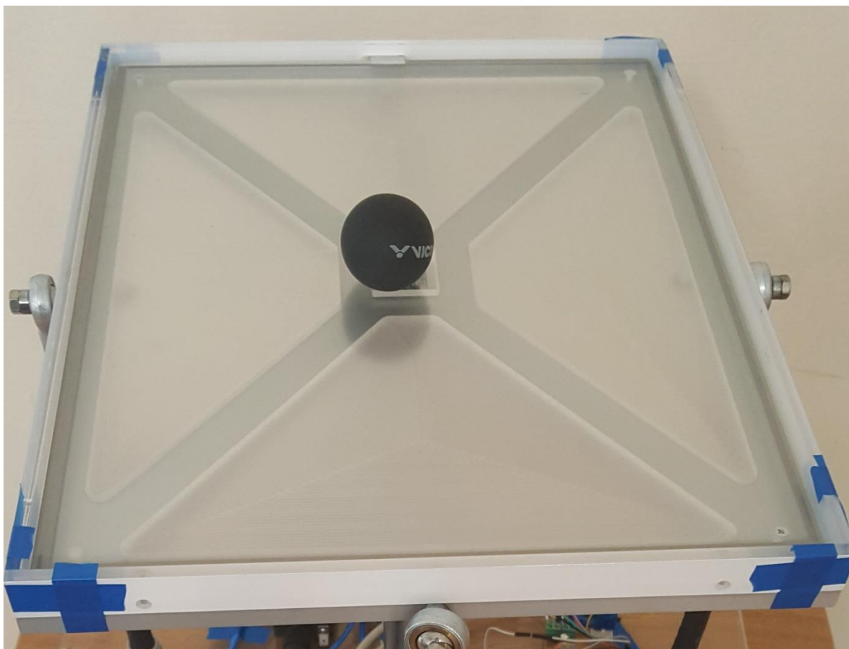
Slika 21. Zaslou osjetljiv na dodir na nastavnoj maketi
