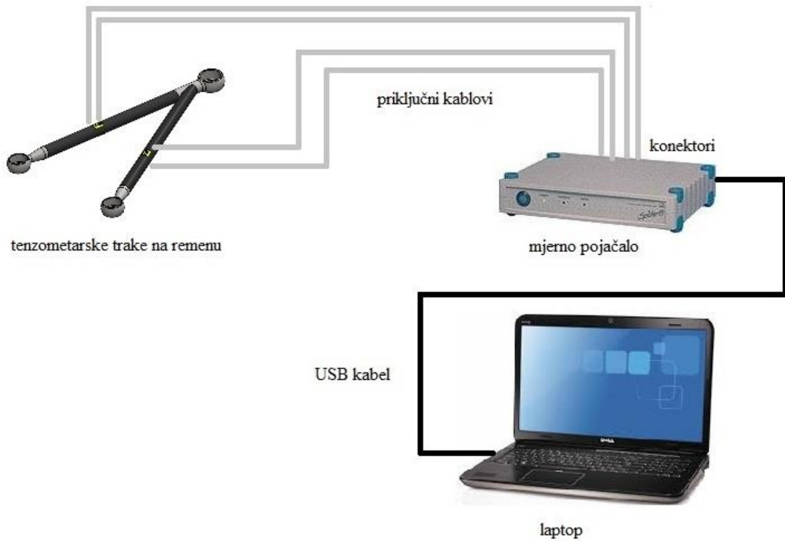
Slika 4.19. Shema ispitivanja naprežanja ramena ovjesa.
