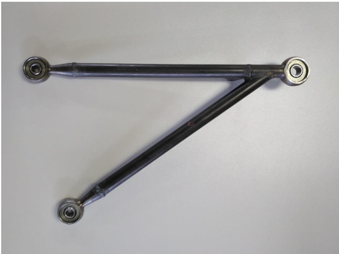
Slika 3.18. Prikaz gornjeg lijevog ramena prednjeg ovjesa bolida Strix .
