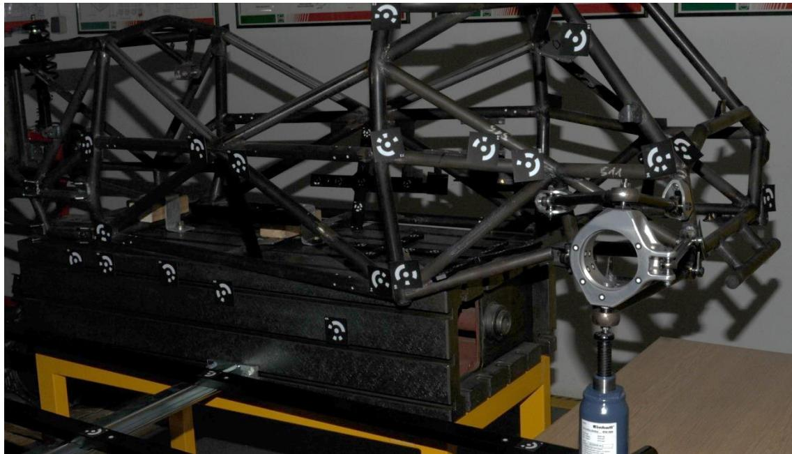
Slika 50. Šasija bolida pripremljena za mjerjenje kinematičkih veličina kotača
