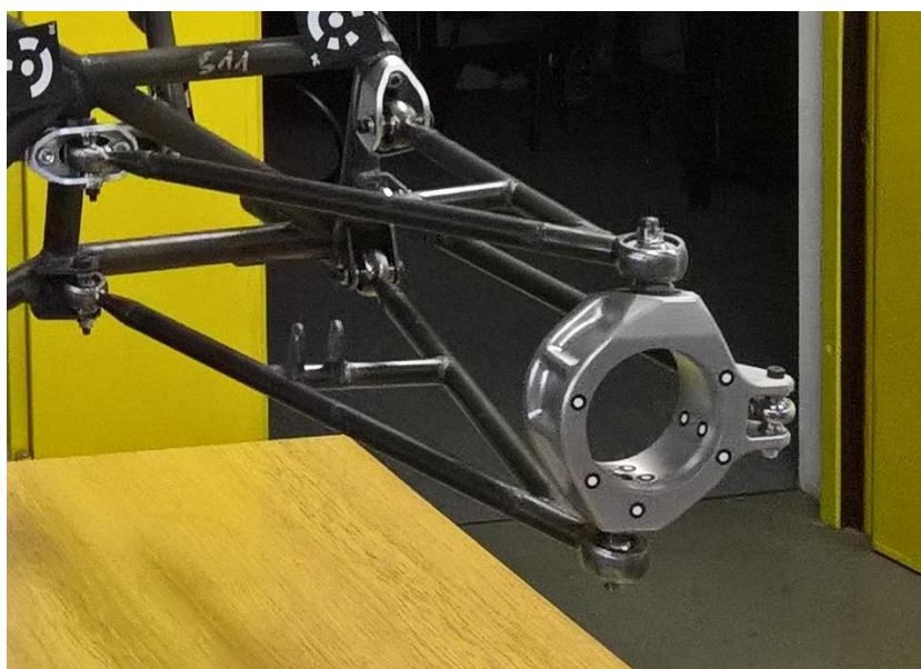
Slika 49. Upright pripremljen za mjerjenje
