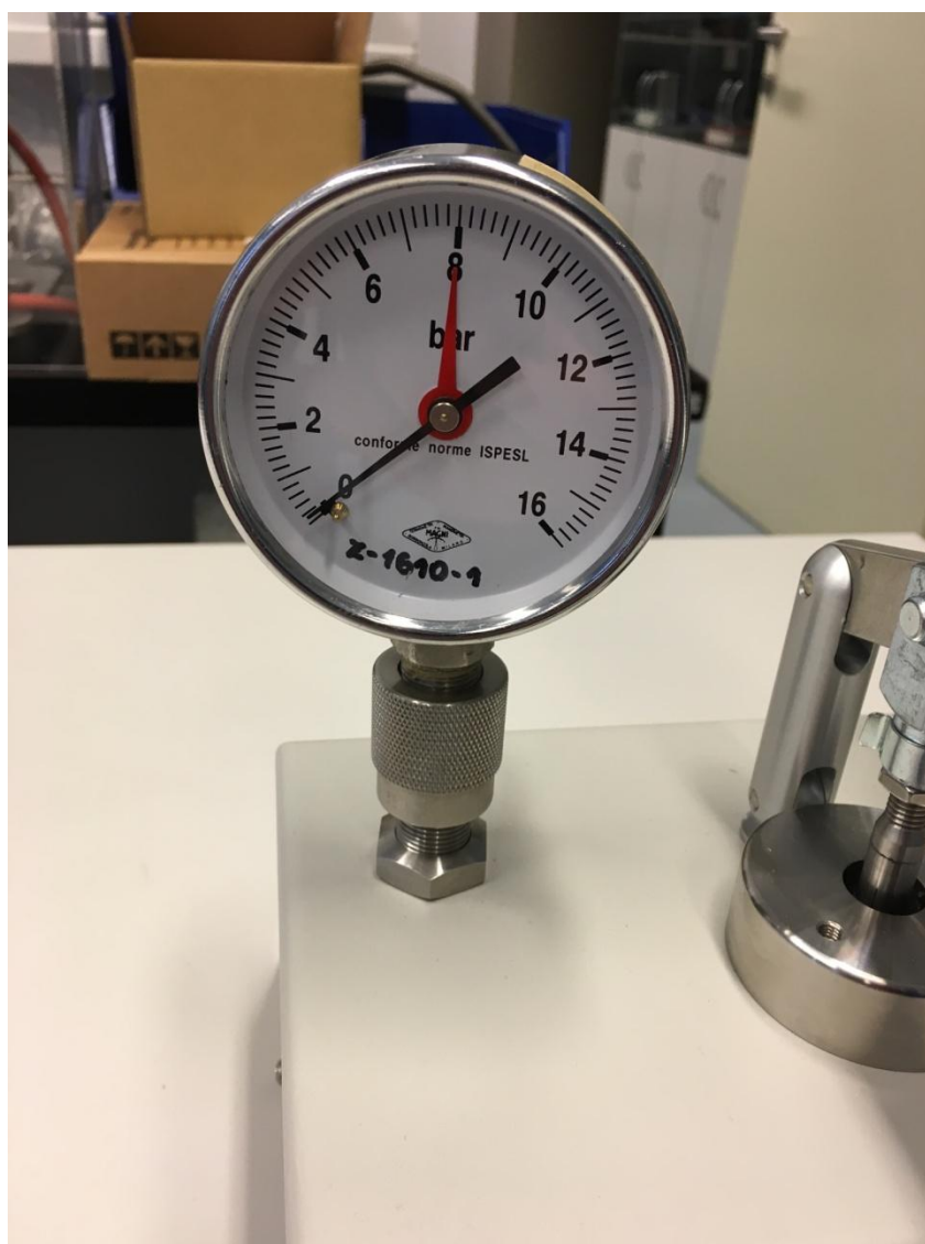
Slika 14: Ispitivani opružni manometar
