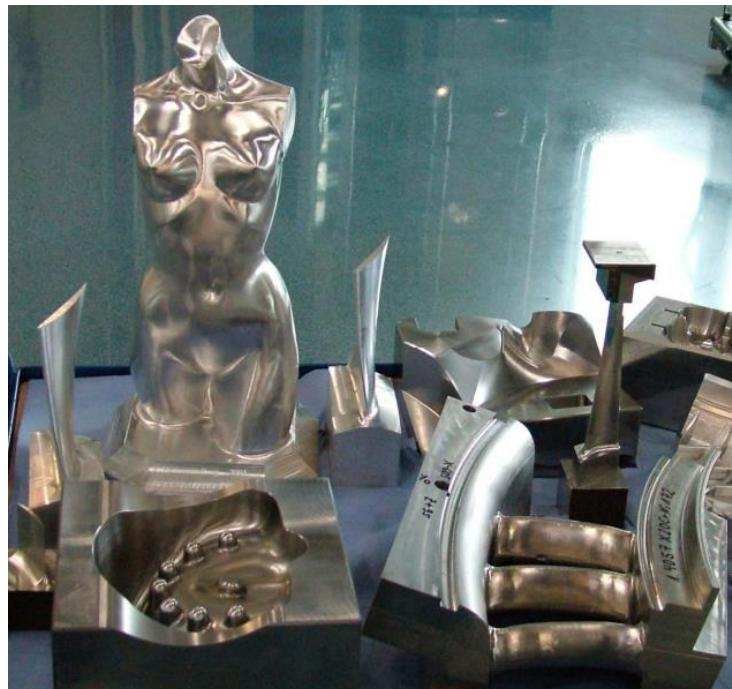
**Slika 10. Primjeri proizvoda dobivenih glodanjem [7]**
