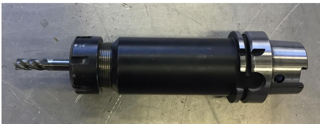
**Slika 44. Ravno glodalo  $\Phi 10$  u držaču alata HSK 63**
