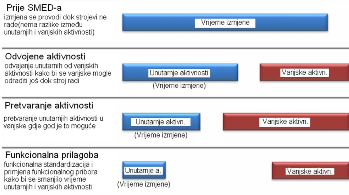
Slika 10. Utjecaj SMED-a na skraćenje vremena izmjene alata[11]
