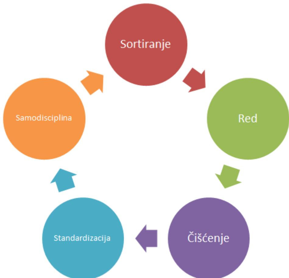
Slika 9. 5S dijelovi
