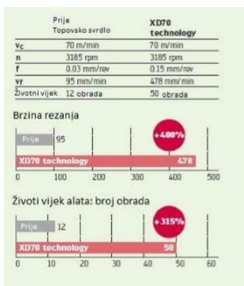
Slika 25. Usporedba XD tehnologije i topovskog svrdla [7]
