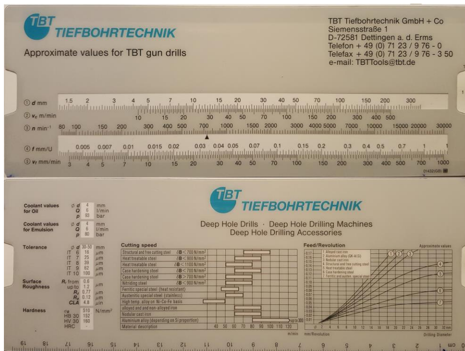
Slika 17. Klizni katalog za izbor režima obrade
