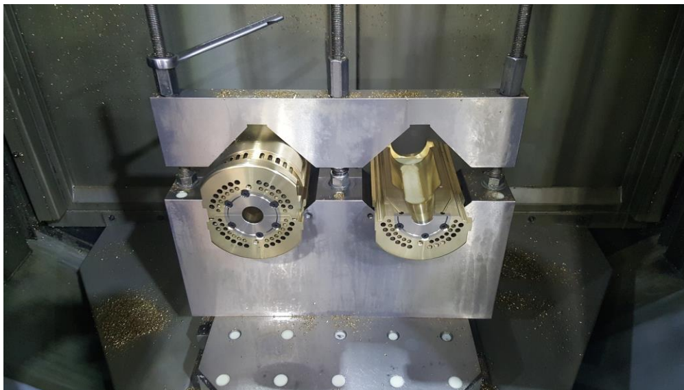
Slika 24. Prikaz stezanja kalupa na postolje
