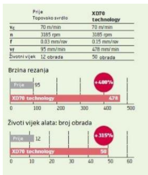
Slika 25. Usporedba XD tehnologije i topovskog svrdla [7]
