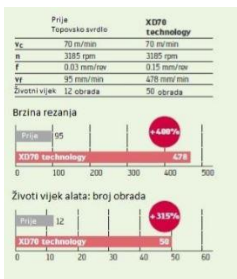
Slika 25. Usporedba XD tehnologije i topovskog svrdla [7]
