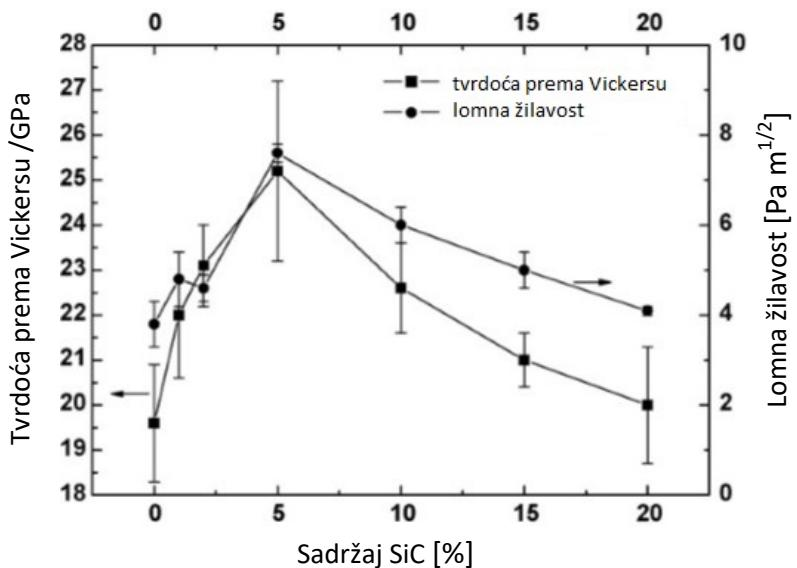
Slika 18. Promjene tvrdoće prema Vickersu i lomne žilavosti u odnosu na udjel silicijevog karbida u SiC/Al<sub>2</sub>O<sub>3</sub> kompozitima [18]
