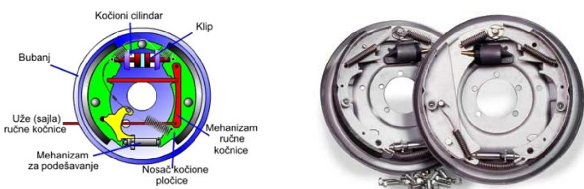
Slika 12. Dijelovi bubanj (čeljusne) kočnice [13]
