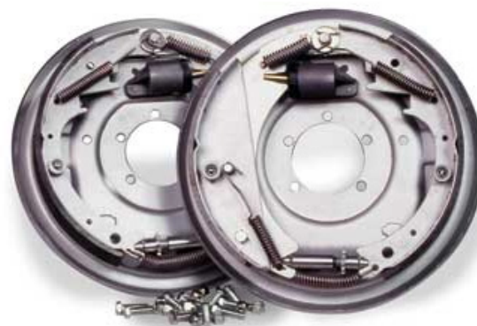
Slika 12. Dijelovi bubanj (čeljusne) kočnice [13]
