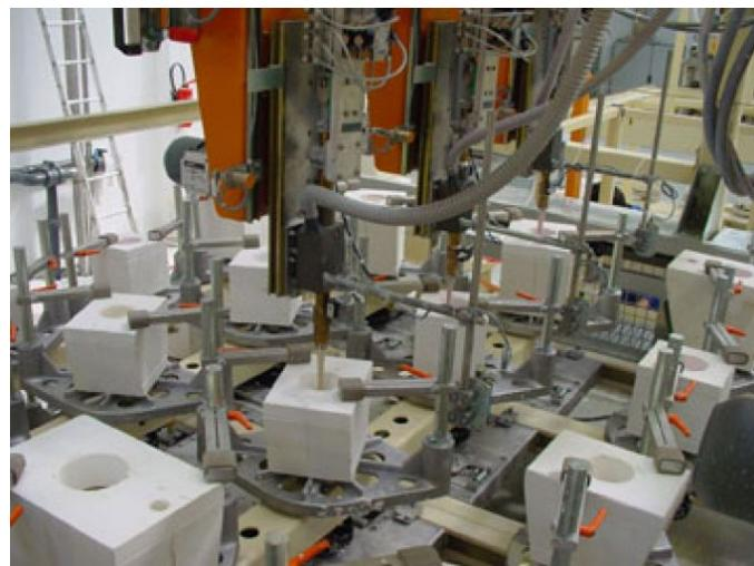
Slika 11. Izgled linije automatiziranog postupka lijevanja suspenzije [11]
