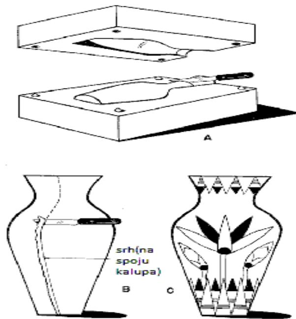
Slika 9. Otvaranje kalupa i vađenje proizvoda [9]
