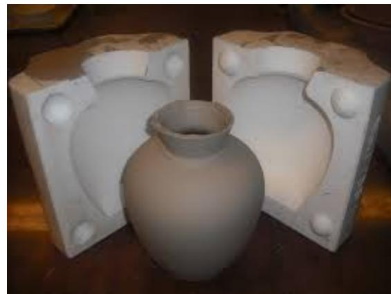
Slika 10. Primjer proizvoda dobivenog lijevanjem suspenzije [11]
