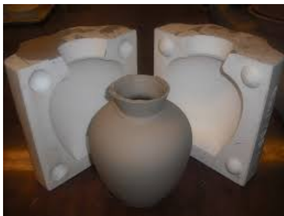
Slika 10. Primjer proizvoda dobivenog lijevanjem suspenzije [11]
