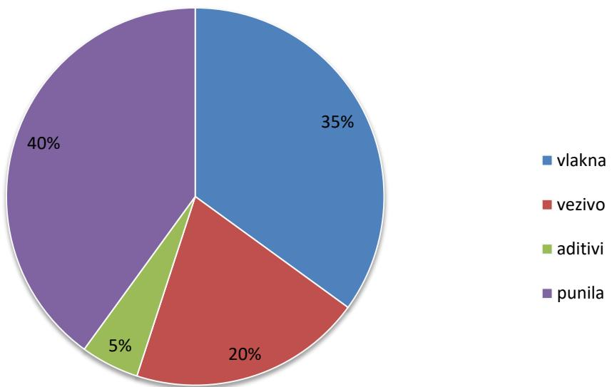
Slika 14. Približan udjel pojedine od četiri osnovne skupine materijala u kočnim pločicama [15]
