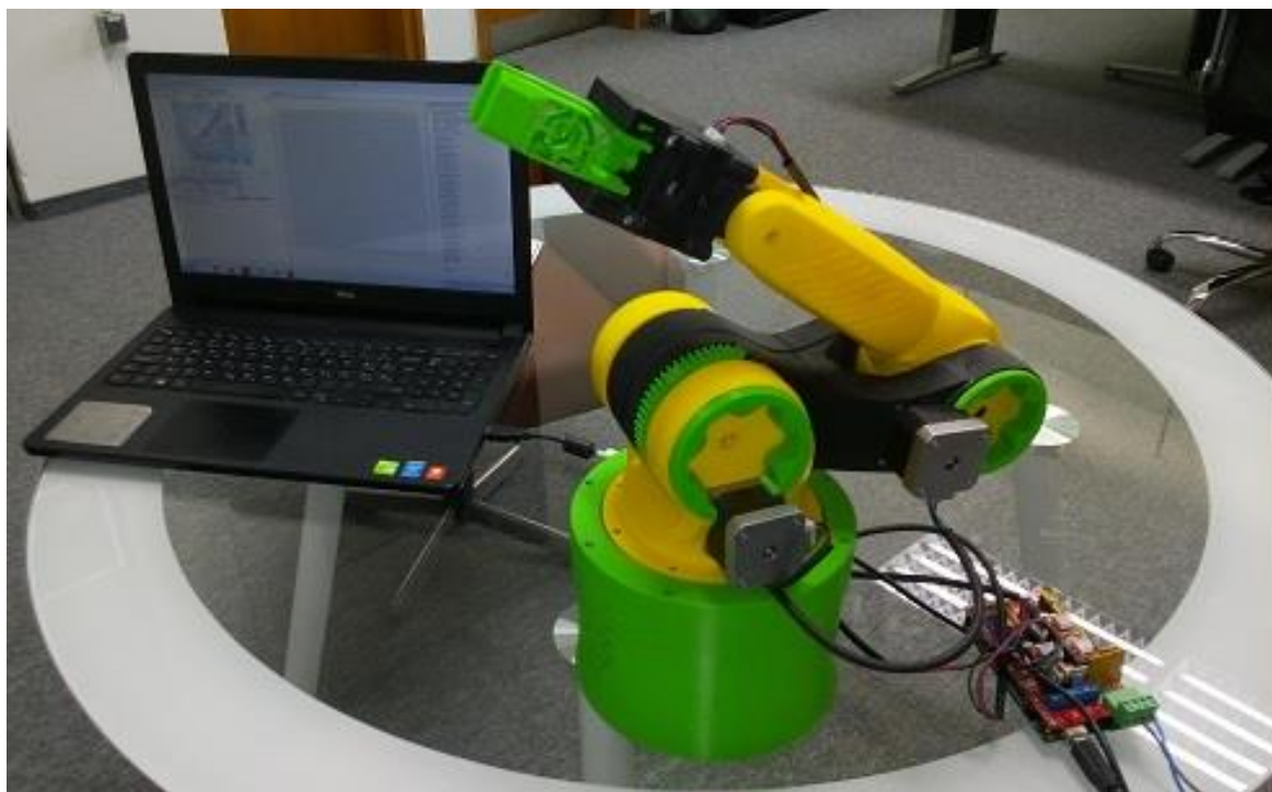
Slika 34. Robotski manipulator sa prihvatnicom i upravljačkim sustavom
