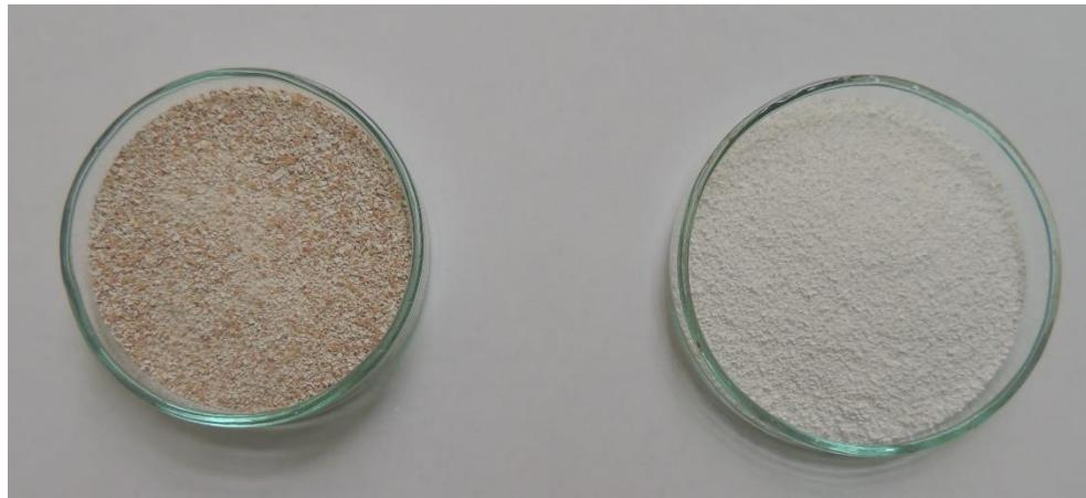
Slika 10. Usitnjene ljske jajeta: (A)  $\text{CaCO}_3$  - prije toplinske obrade; (B)  $\text{CaO}$  - nakon toplinske obrade pri 1000 °C
