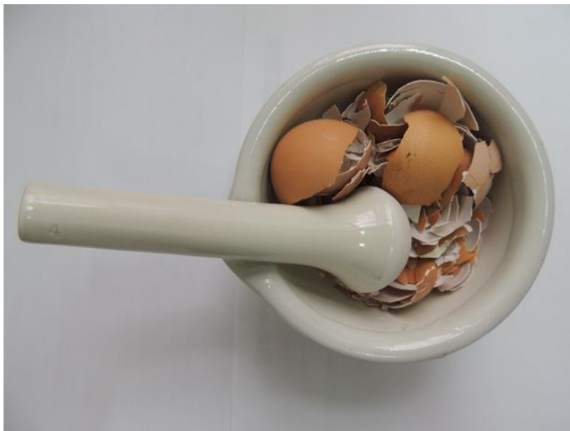
Slika 8. Usitnjavanje osušenih ljsaka jajeta u keramičkom tarioniku
