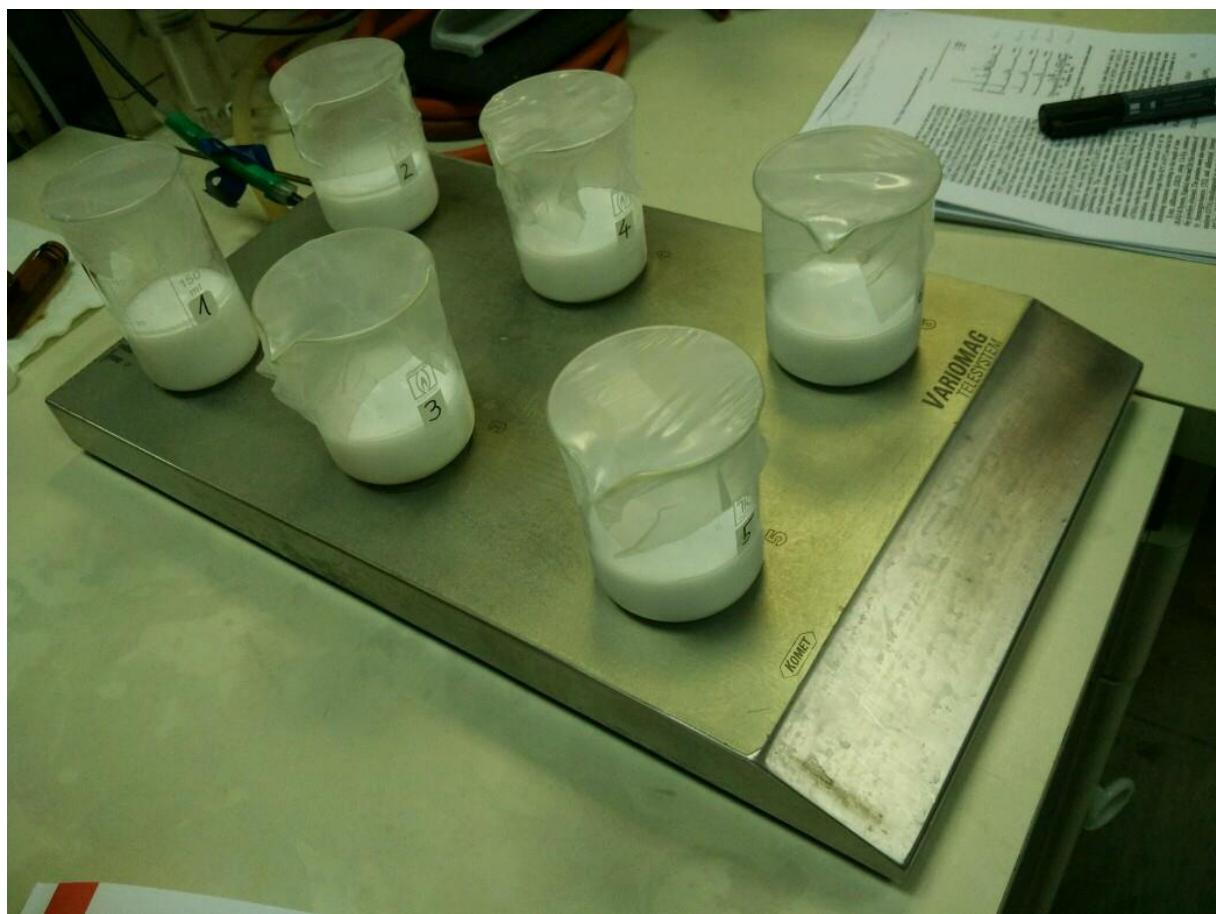
Slika 12. Sinteza kalcijevog hidroksida na magnetnoj miješalici
