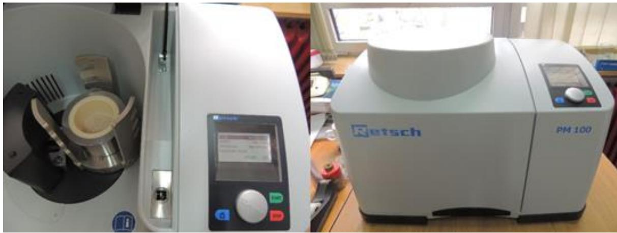
Slika 9. Usitnjavanje ljsaka jajeta u planetarnom kugličnom mlinu
