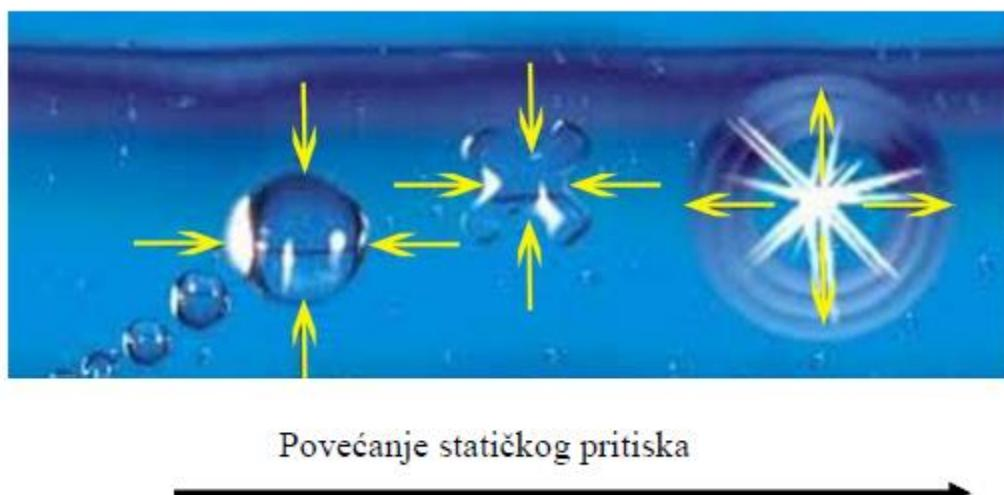
Slika 4. Prikaz jediničnog događaja kavitačijske erozije [15]
