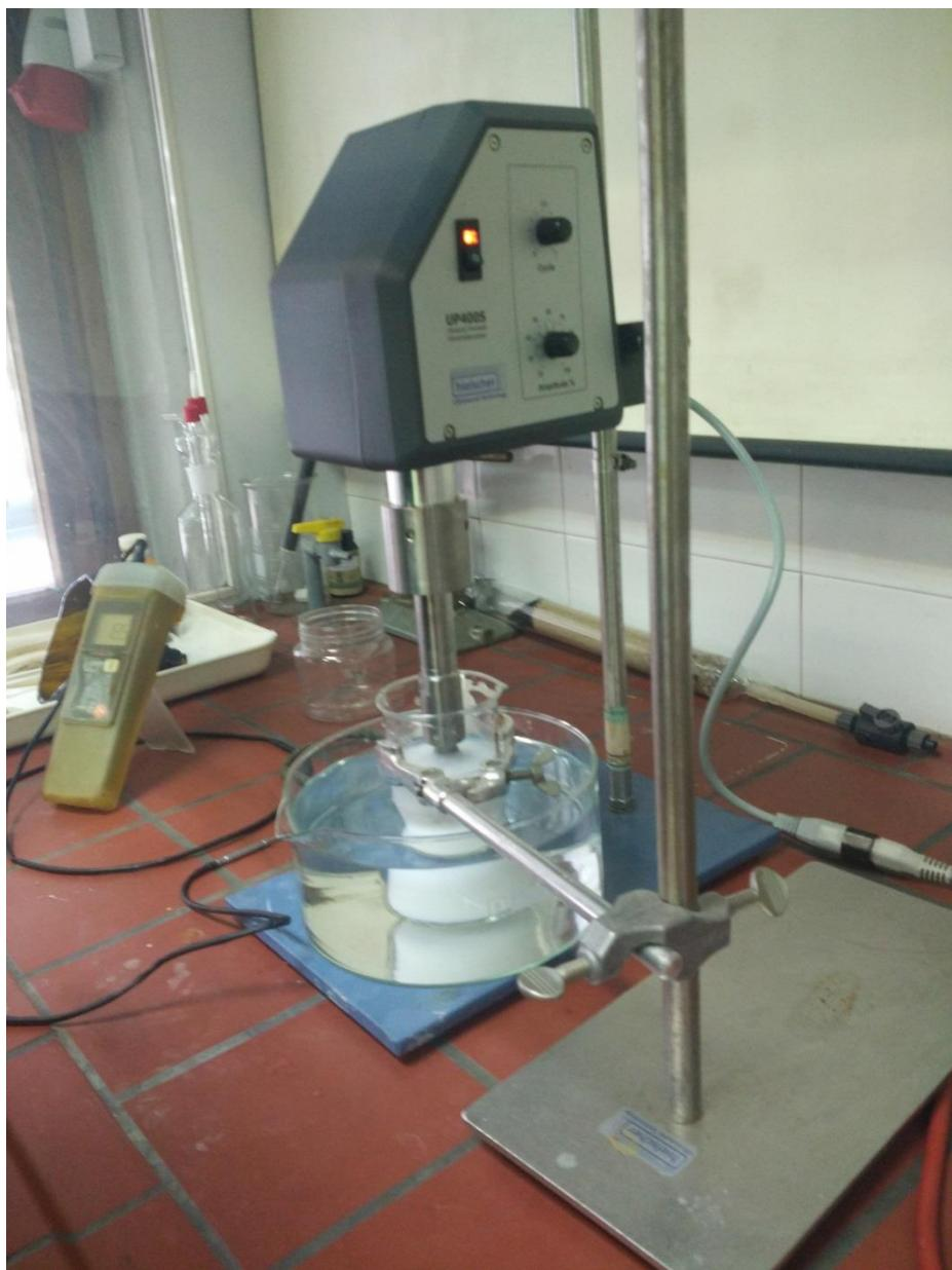
Slika 13. Tretiranje smjese kalcijevog hidroksida i fosfatne kiseline ultrazvučnom sondom
