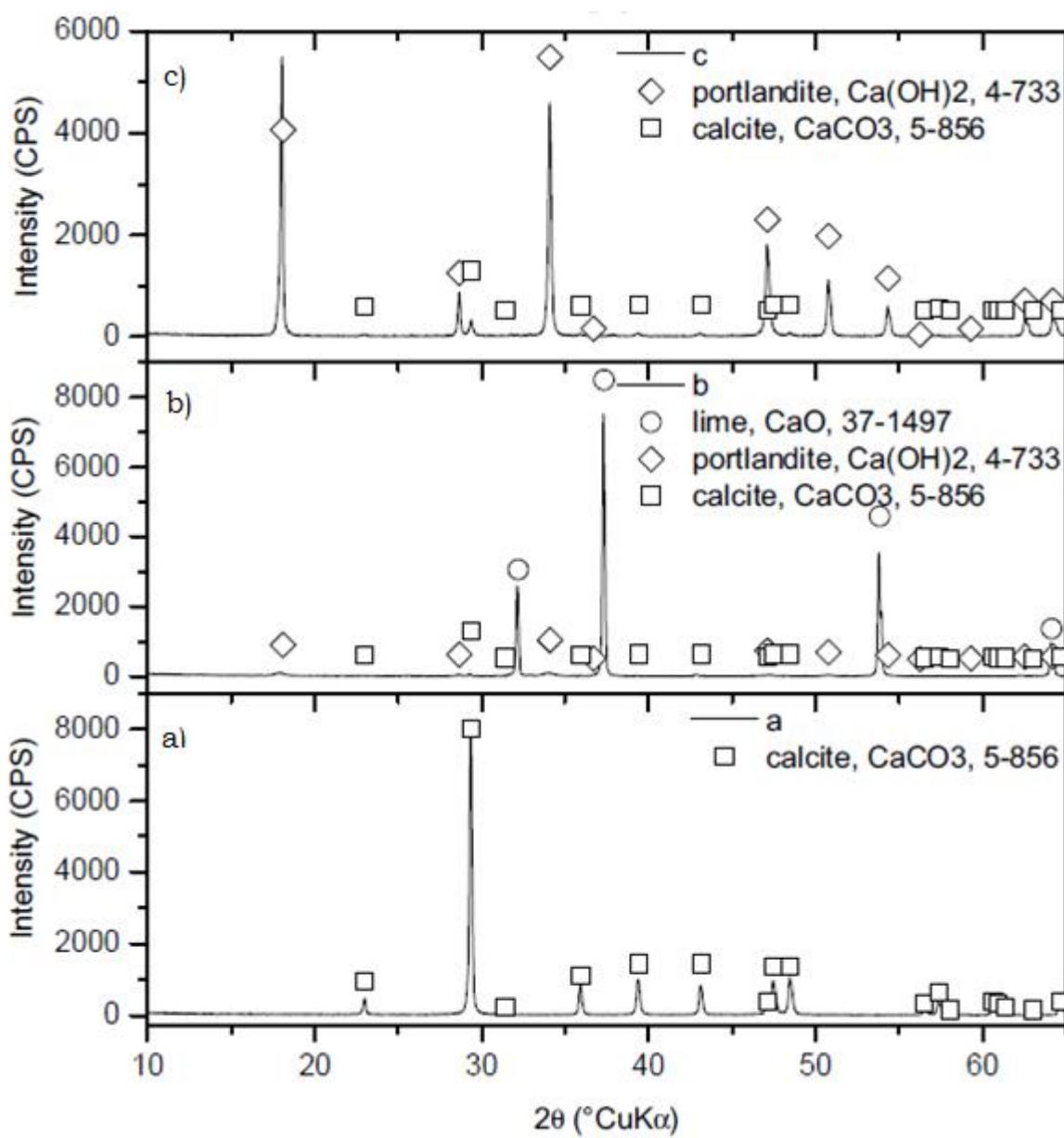
Slika 15. XRD analiza uзорака a) лјусака јажа; б) CaO насталог топлинском обрадом лјусака јажета и в) калцијевог хидрооксида
