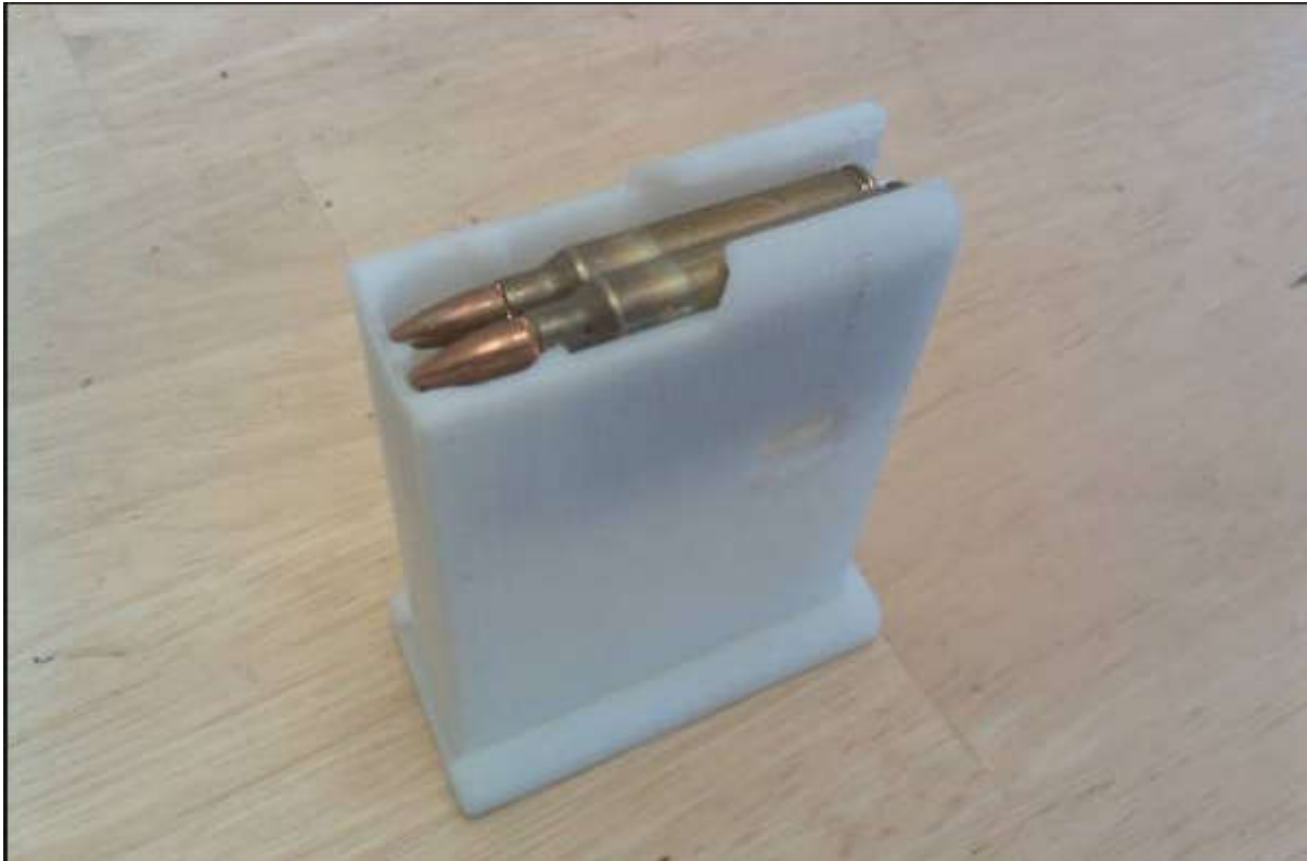
Slika 13. Okvir za metke izrađen 3D printanjem[21]
