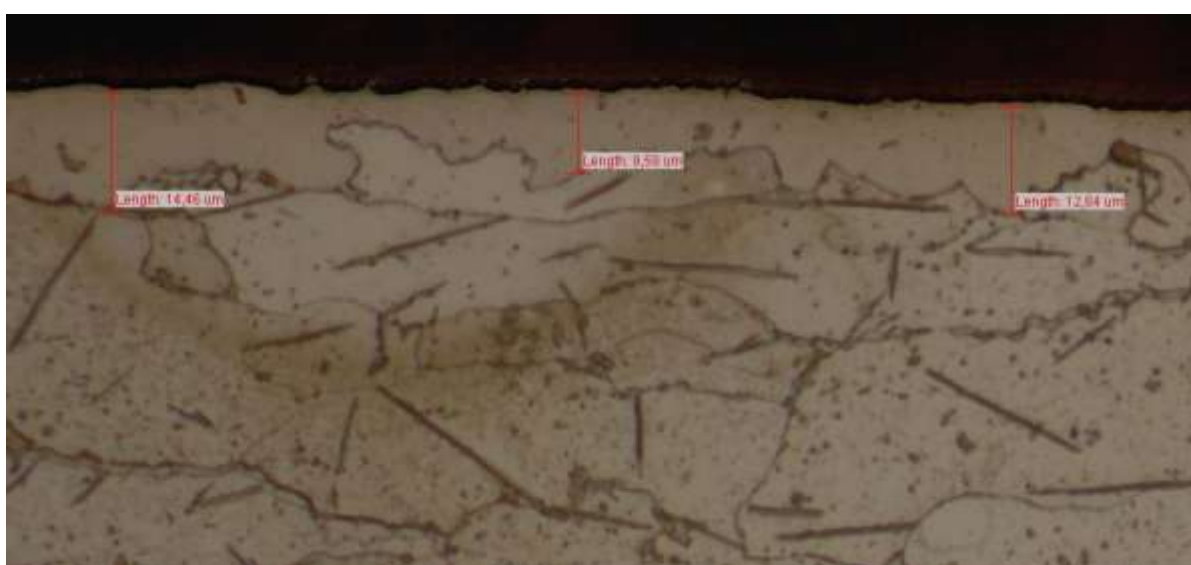
Slika 38. Zona spojeva, uzorak 2 pozicija 5, povećanje 500x
