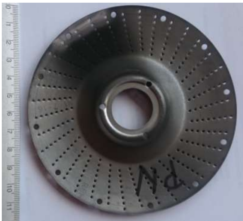
Slika 19. Izgled ispitnog uzorka nakon postupka plazmatskog nitriranja (uzorak 2)
