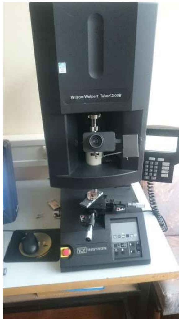
Slika 27. Mikrotvrdomjer Instron Wilson Wolpert Tukon 2100b
