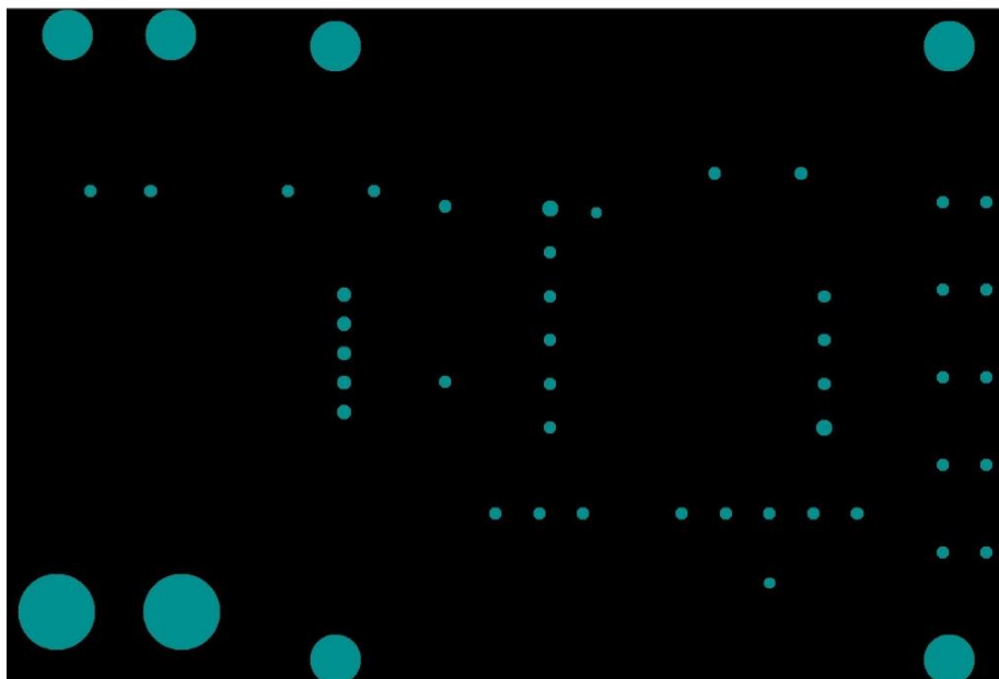
Slika 65. Lokacije i veličine rupa na tiskanoj pločici
