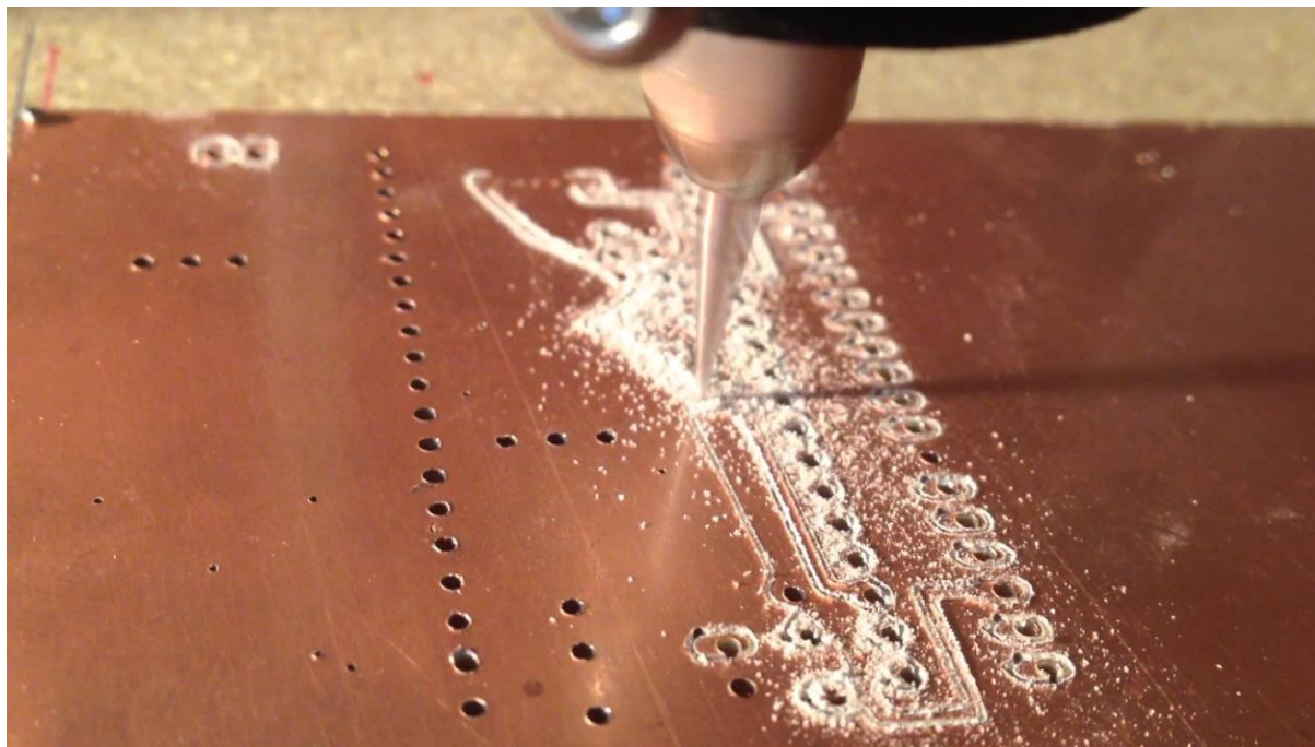
Slika 22. Proces glodanja tiskane pločice [17]
