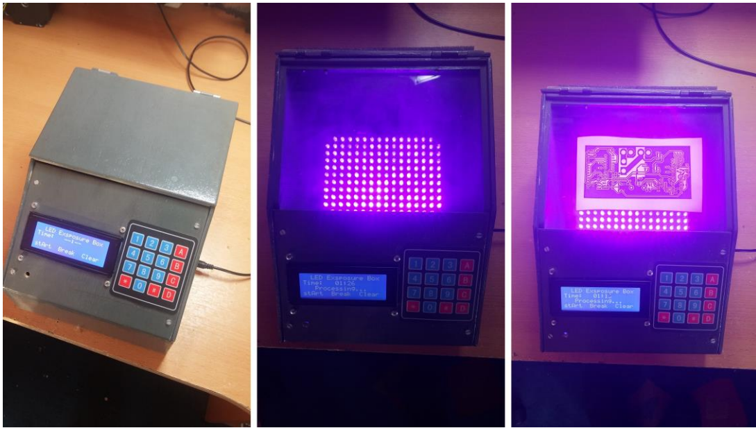
Slika 15. Osvjetljavanje tiskane pločice
