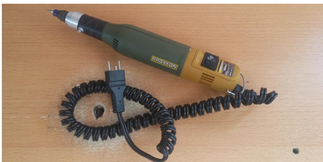
Slika 19. Bušilica za bušenje rupa na tiskanim pločicama
