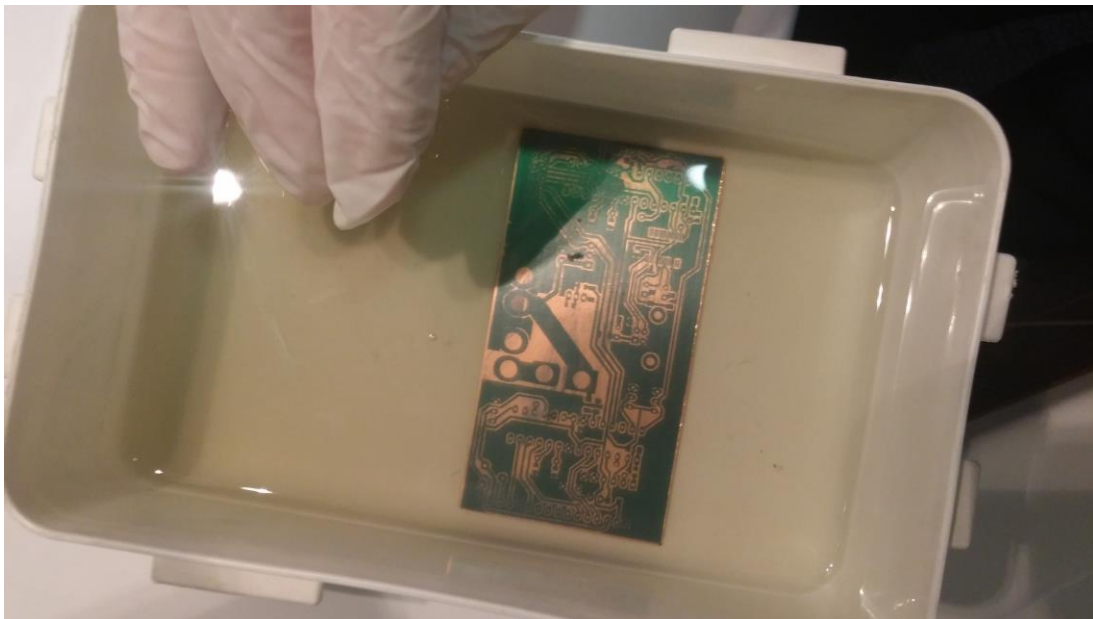
Slika 16. Razvijanje tiskane pločice
