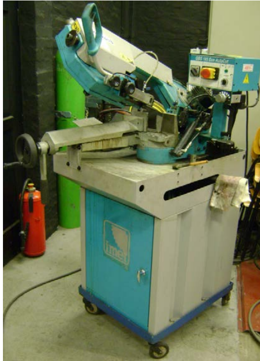
Slika 7.24. Tračna pila GBS 185 Eco AutoCut
