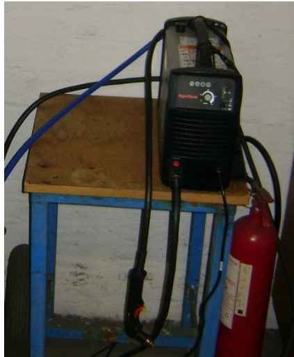
Slika 7.5. Uređaj za plazma rezanje Powermax30 XP Plasma System
