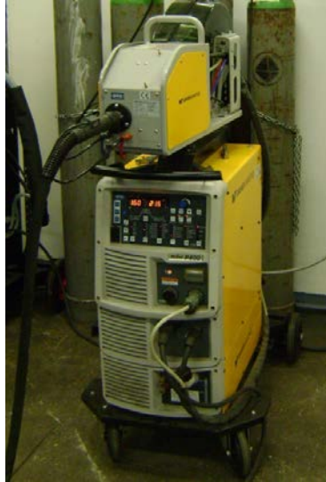
Slika 7.9. Izvor struje za zavarivanje Welbee P400
