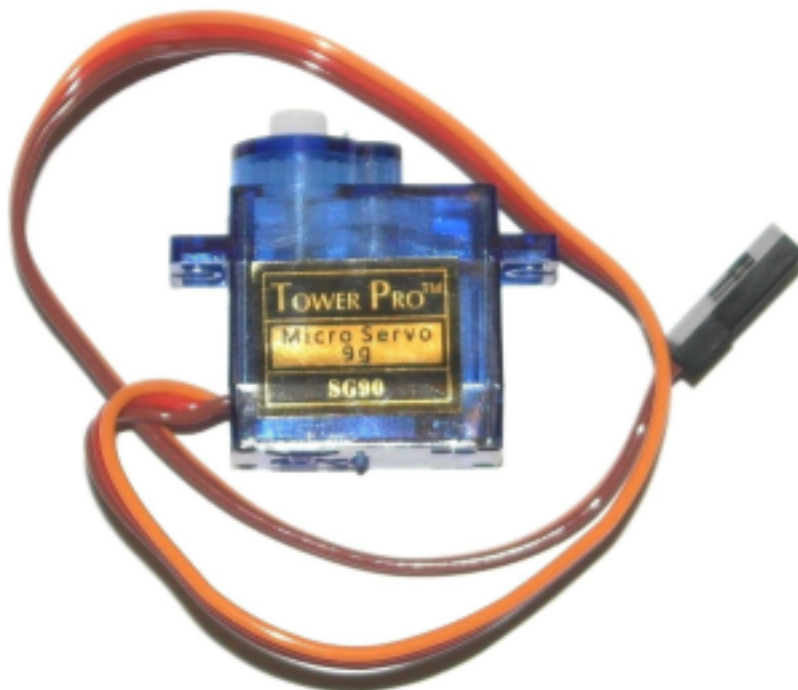
Slika 9: Tower Pro SG90 servo motor [11]
