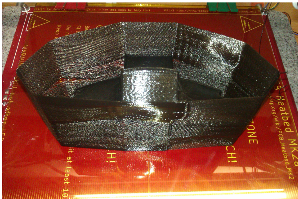
Slika 25: Printanje centralnog dijela kacige
