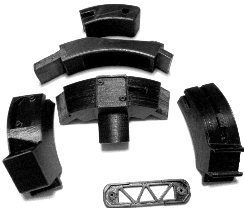
Slika 26: Isprintani dijelovi kacige
