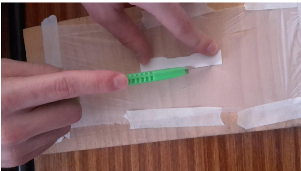
Slika 8. Izrada epruveta za ispitivanje vlačne žilavosti
