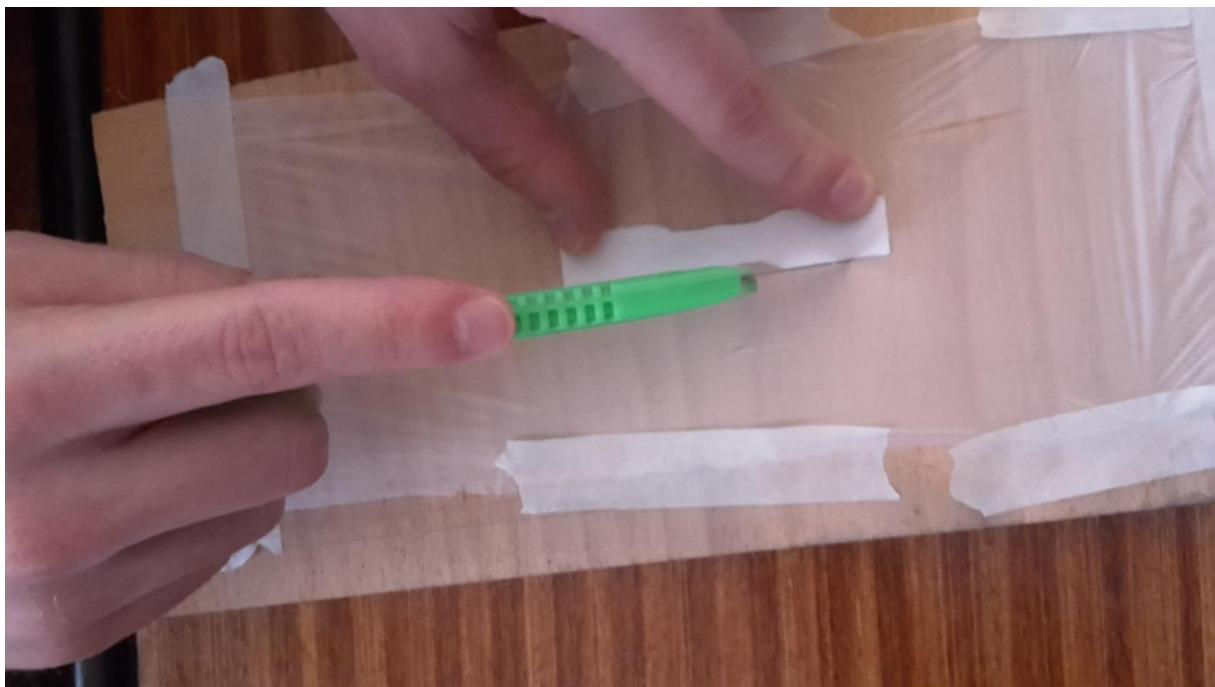
**Slika 8. Izrada epruveta za ispitivanje vlačne žilavosti**
