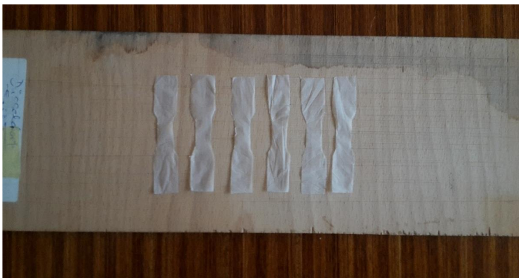
Slika 25. Izrezane epruvete za ispitivanje vlačne žilavosti
