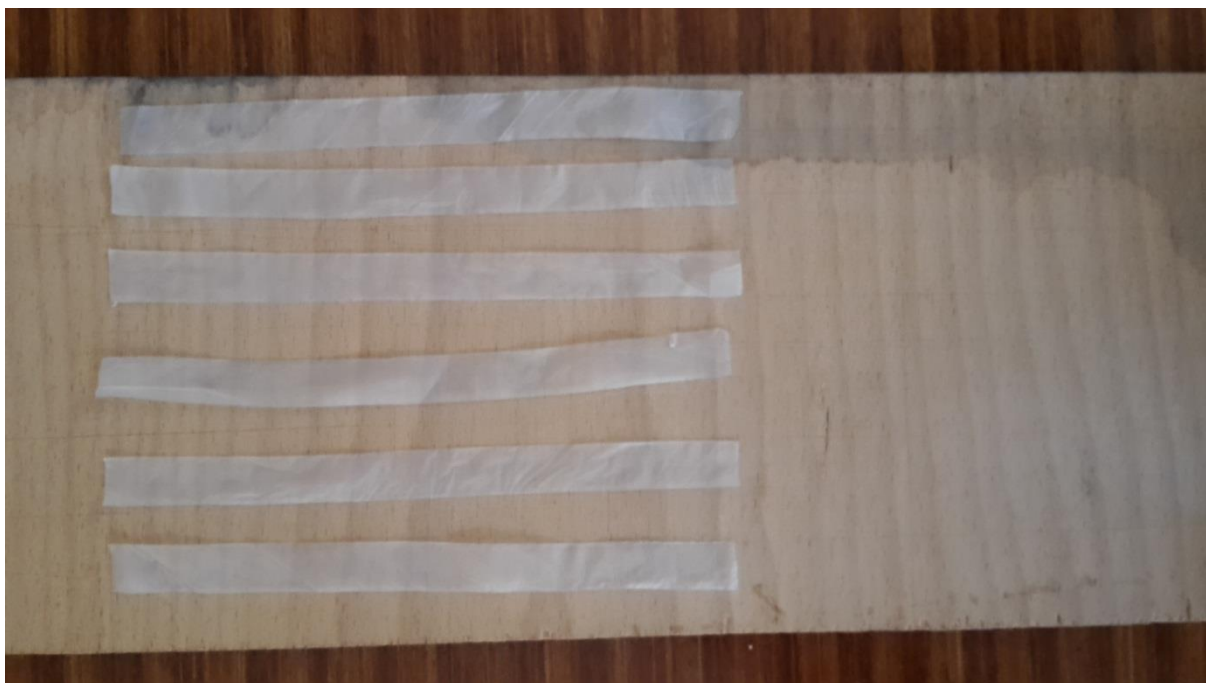
Slika 19. Izrezane epruvete za ispitivanje vlačne čvrstoće i relativnog produljenja
