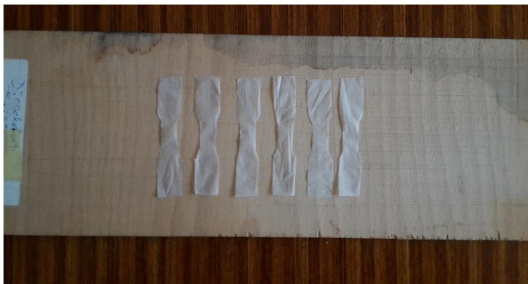
Slika 25. Izrezane epruvete za ispitivanje vlačne žilavosti
