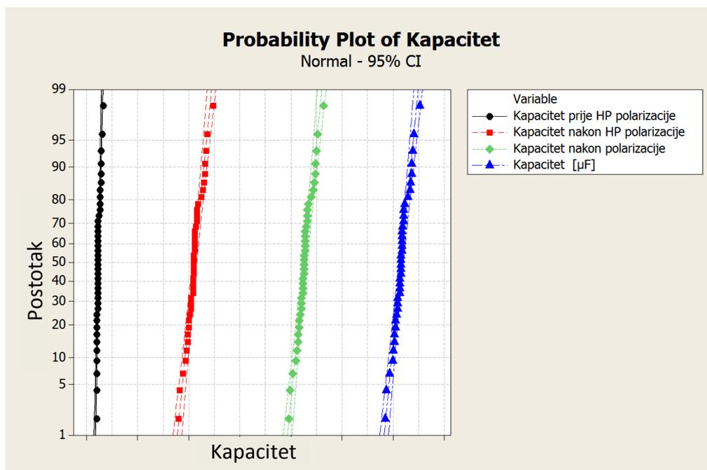
*Slika 43: Dijagram vjerojatnosti za promjenu kapaciteta piezokeramičkog aktuatora*
