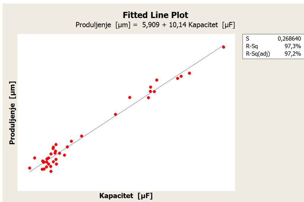
*Slika 40: Dijagram ovisnosti produljenja o kapacitetu piezokeramičkog aktuatora*
