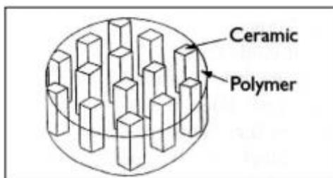
**Slika 17: Piezoelektrični kompozitni materijal [4]**
