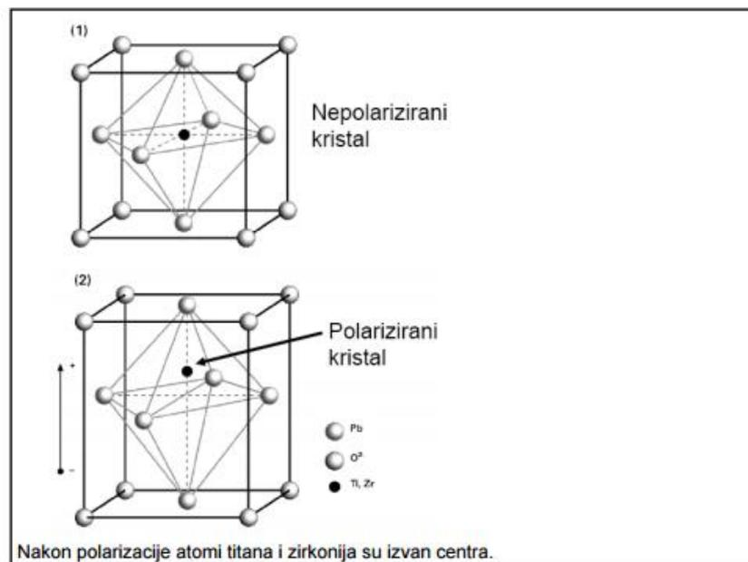
**Slika 13: Prikaz polariziranog i nepolariziranog kristala olovnog cirkonat-titanata [5]**
