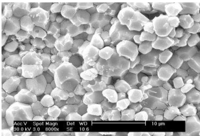
**Slika 15: Mikrostruktura PZT keramike snimljena SEM mikroskopom [8]**
