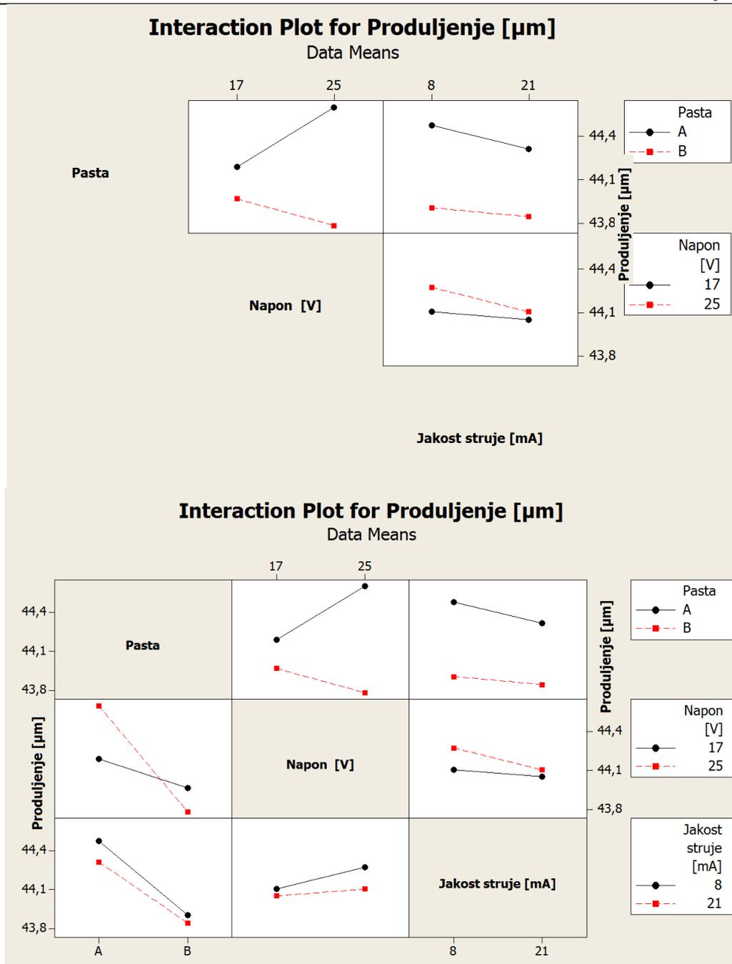
Slika 51: Graf interaktivnih utjecaja na produljenje piezokeramičkog aktuatora
