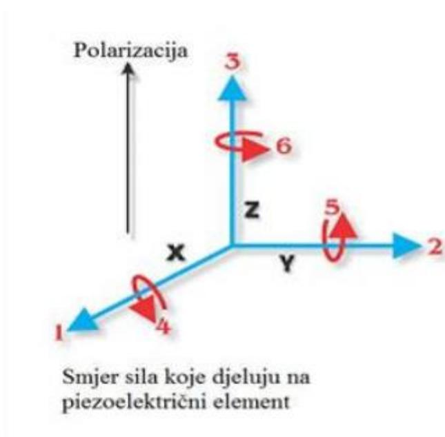
**Slika 5: Smjer sile koje djeluju na piezoelektrični element [3]**
