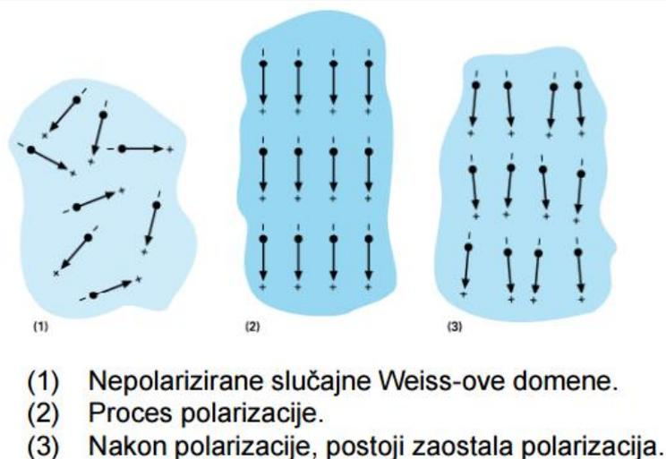
**Slika 29: Polarizacija Weiss-ovih domena piezoelektrične keramike [10]**
