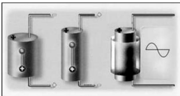
*Slika 4: Inverzni piezoelektrični efekt [4]*
