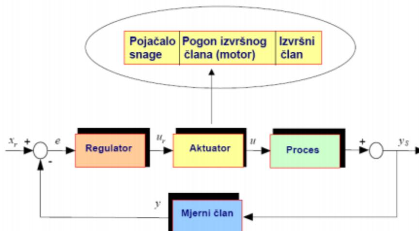
*Slika 23: Položaj aktuatora u regulacijskom krugu [11]*
