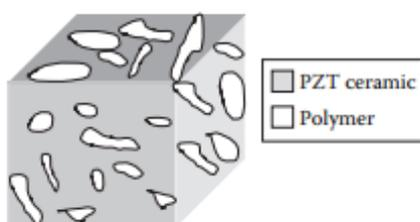
a) 3-3 piezoelektrični kompozit,
