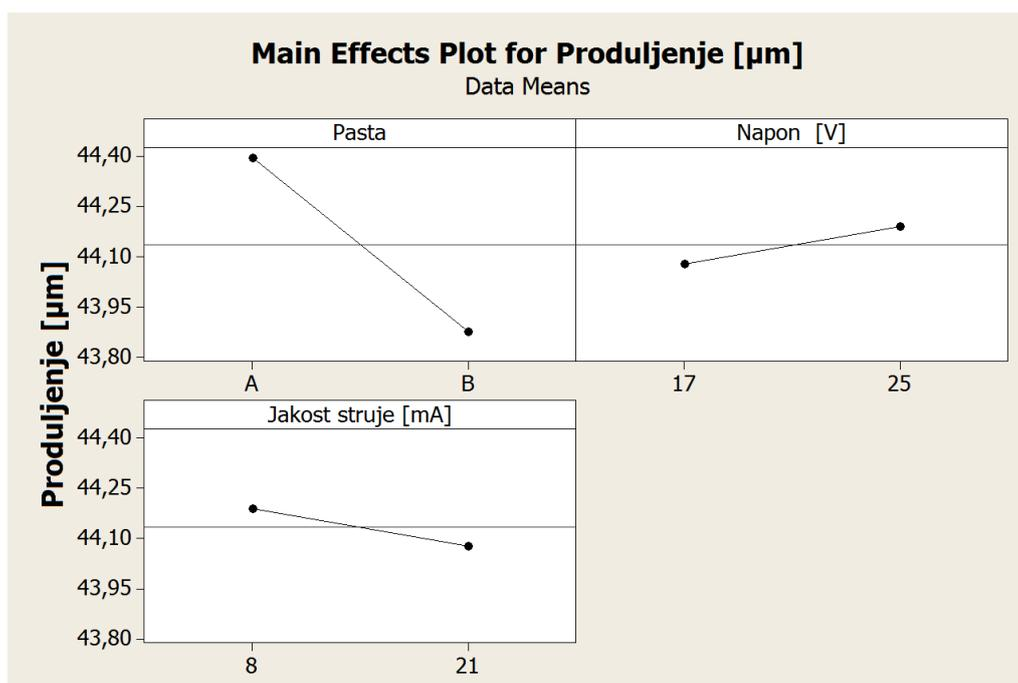
Slika 50: Graf glavnih utjecaja na produljenje piezokeramičkog aktuatora
