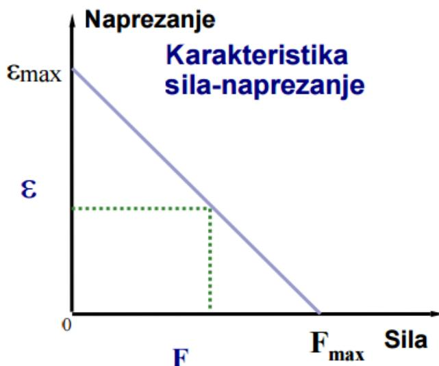
Slika 32: Naprezanje piezoelektričnog aktuatora u ovisnosti o sili blokiranja[13]
