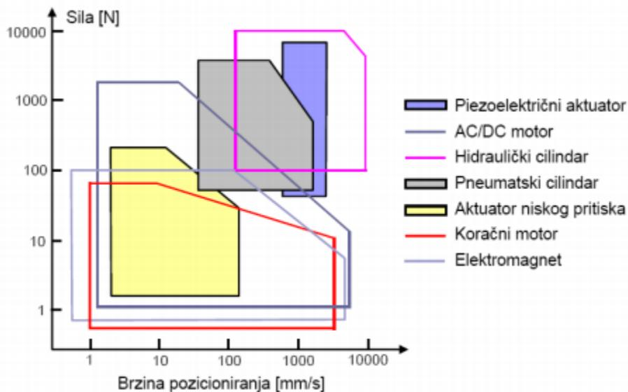
*Slika 24: Ovisnost sile o brzini pozicioniranja [11]*
