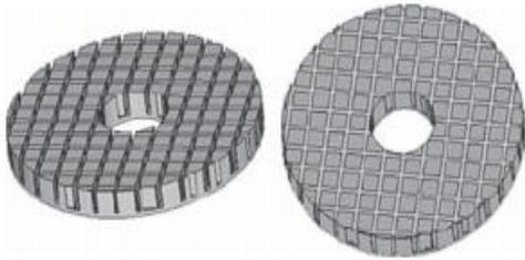
b) 1-3 piezoelektrični kompozit.
