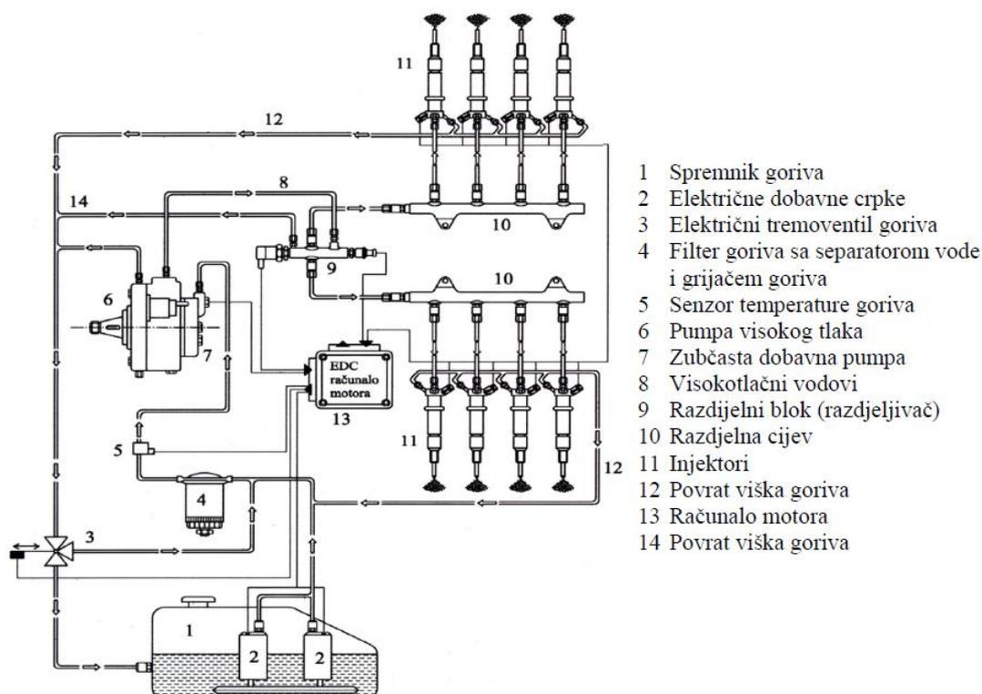
**Slika 36: Common rail sustav treće generacije s piezokeramičkim aktuatorom za V8 dizelski motor [17]**
