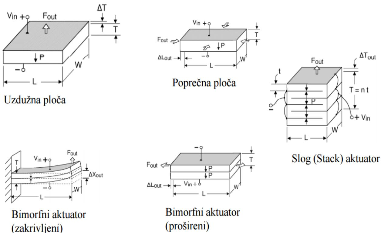
Slika 34: Tipovi piezoelektričnih aktuatora [10]
