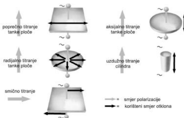
**Slika 10: Temeljni oblici titranja piezokeramičkih materijala [6]**
