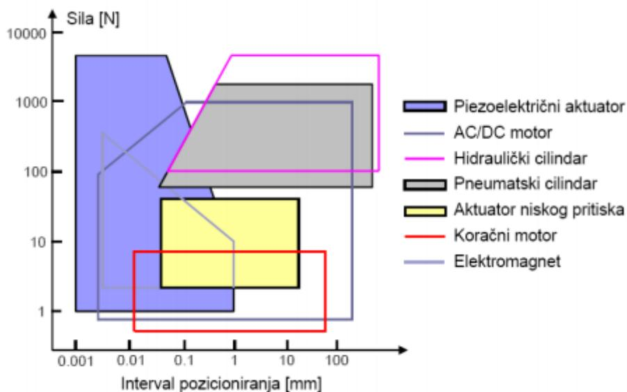
*Slika 25: Ovisnost sile o intervalu pozicioniranja aktuatora [11]*
