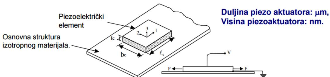
**Slika 31: Koordinatni sustav na primjeru piezoelektričnog aktuatora [10]**
