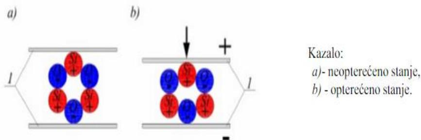
**Slika 8: Piezoelektrični efekt na primjeru kristala kvarca [3]**
