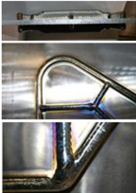
Slika 38: Okvir izrađen WAAM sustavom [21]
