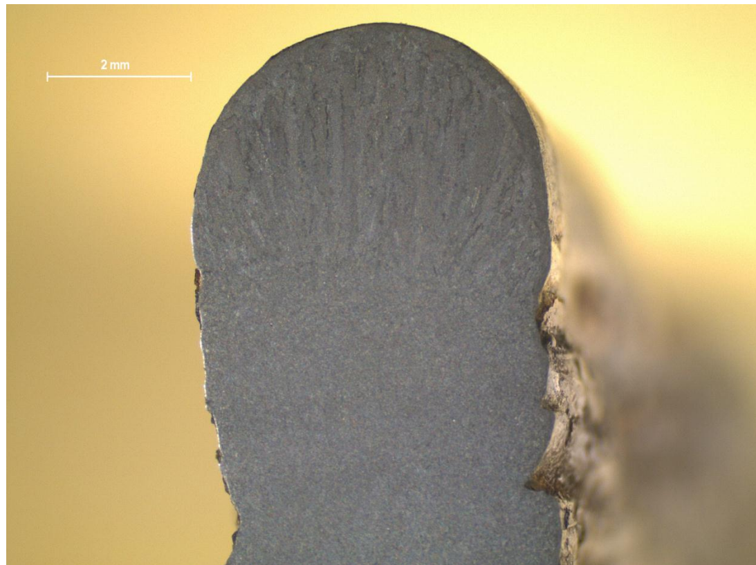
Slika 55: Završni prolazi uzorka 3 (povećanje 12,5 x)
