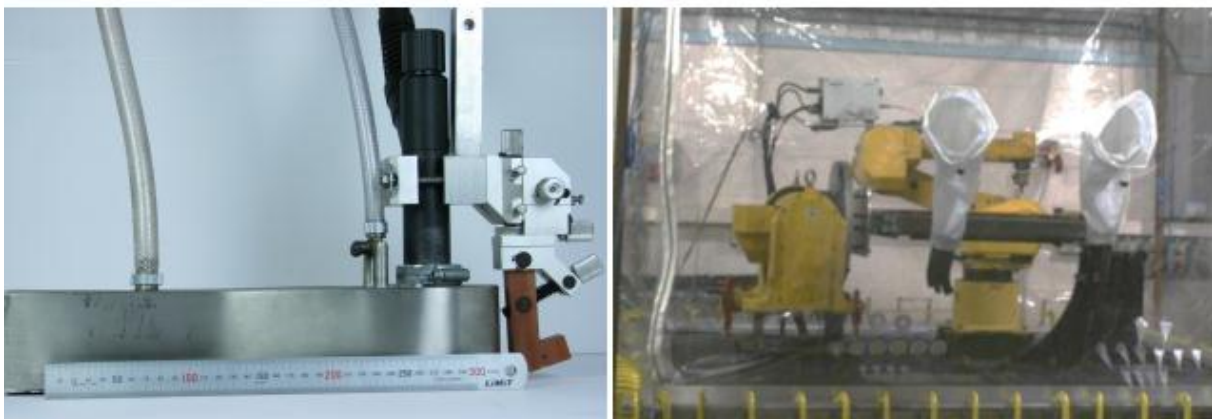
Slika 6: a) lokalni uređaj za zaštitu; b) zatvoreni šator u kojem se nalazi zaštitni plin [5]
