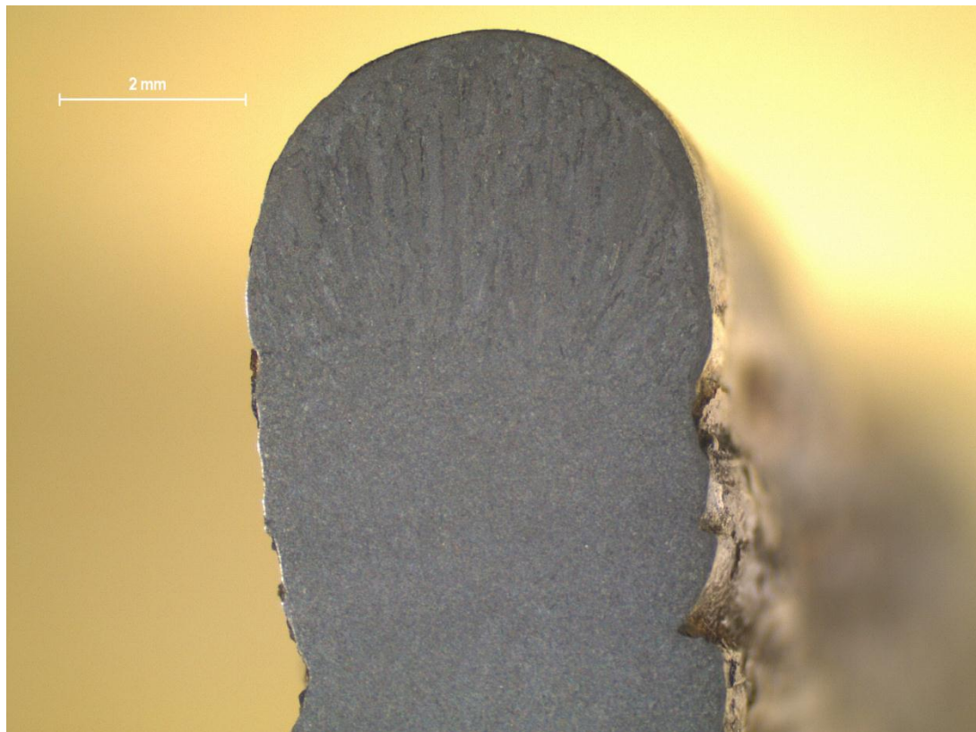
Slika 55: Završni prolazi uzorka 3 (povećanje 12,5 x)
