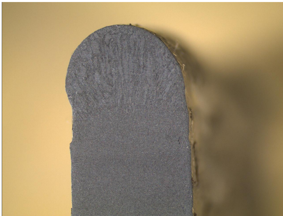
Slika 49: Završni prolazi uzorka 1 (povećanje 12,5 x)
