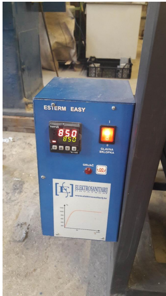
Slika 45. Display peći (zelena-zadana temperatura, crvena boja-postignuta temperatura)
