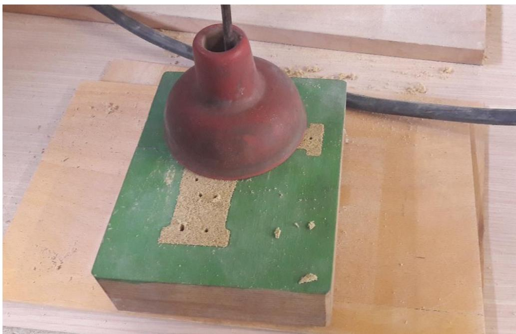
**Slika 37. Propuhivanje jezgrene mješavine sa CO<sub>2</sub> plinom**
