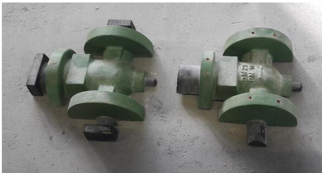
**Slika 25. Dvodjelni model odljevka.**
