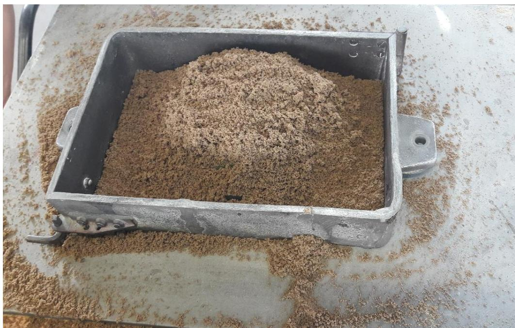
**Slika 27. Stavljanje modelne kalupne mješavine.**
