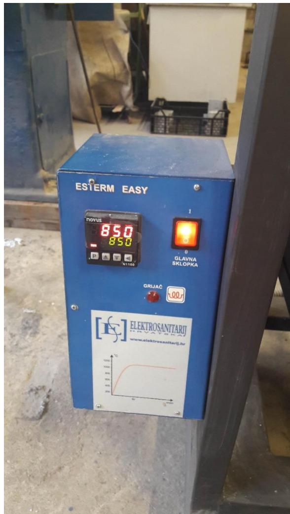
**Slika 45.** Display peći (zelena-zadana temperatura, crvena boja-postignuta temperatura)
