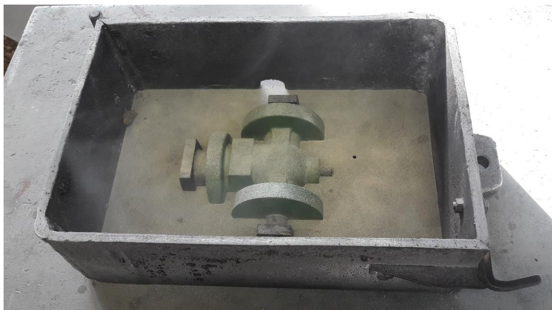
Slika 26. Donji dio modela posipan likapodijem.
