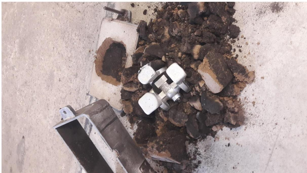
**Slika 50. Odvajanje odljevka od kalupne mješavine.**
