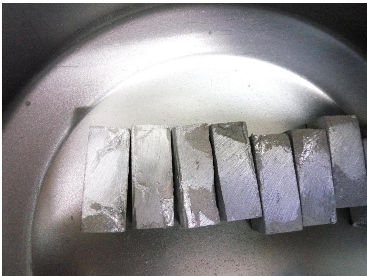
Slika 4.13. Brušeni hladno izostatski prešani uzorci
