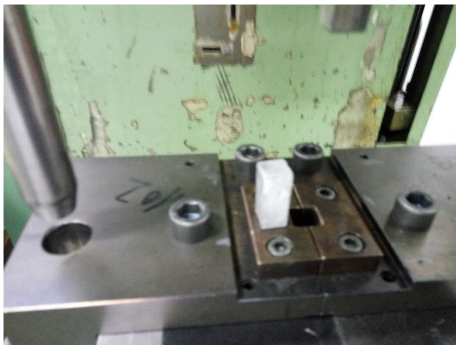
Slika 4.14. Uzorak pokraj ulaza u kalup za ECAP
