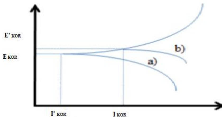
Slika 12. Utjecaj katodnih inhibitora na korozijski proces [13]
