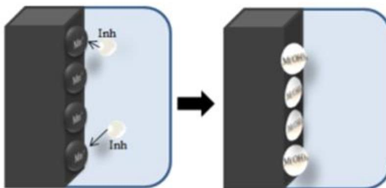
Slika 15. Mehanizam djelovanja mješovitih inhibitora [13]
