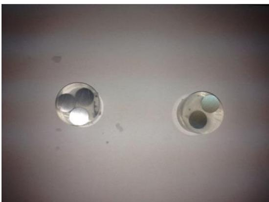
Slika 26. Uzorci Ø16 mm nakon brušenja
