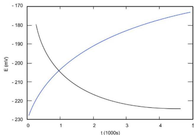
Slika 19. Određivanje potencijala otvorenog strujnog kruga  $E_{ok}$  [3]
