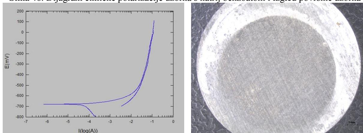
Slika 47. Dijagram cikličke polarizacije uzorka s medom i izgled površine uzorka
