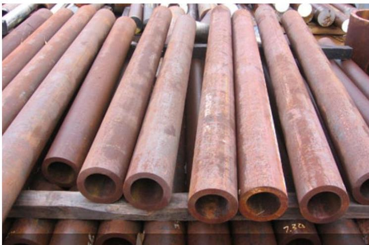
Slika 4. Opća korozija cijevi [5]
