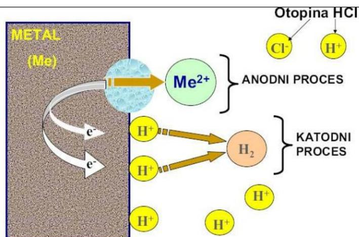
Slika 2. Shematski prikaz elektrokemijske korozije u kiseljoj otopini [3]
