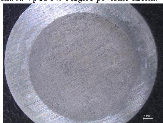
Slika 45. Dijagram cikličke polarizacije uzorka sa ružmarinom i izgled površine uzorka
