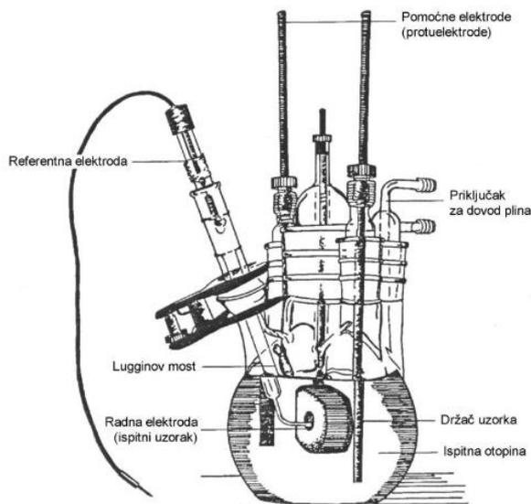
Slik 18. Raspored elektroda pri elektrokemijskom ispitivanju [3]
