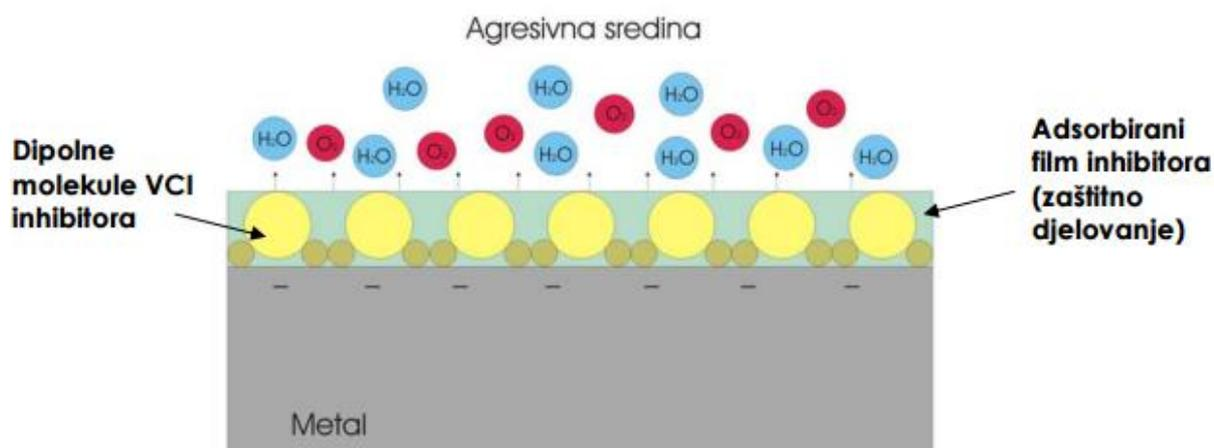
Slika 16. Mehanizam djelovanja hlapivog inhibitora korozije [3]
