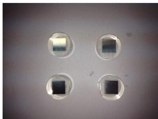
Slika 27. Uzorci 20x20mm nakon brušenja
