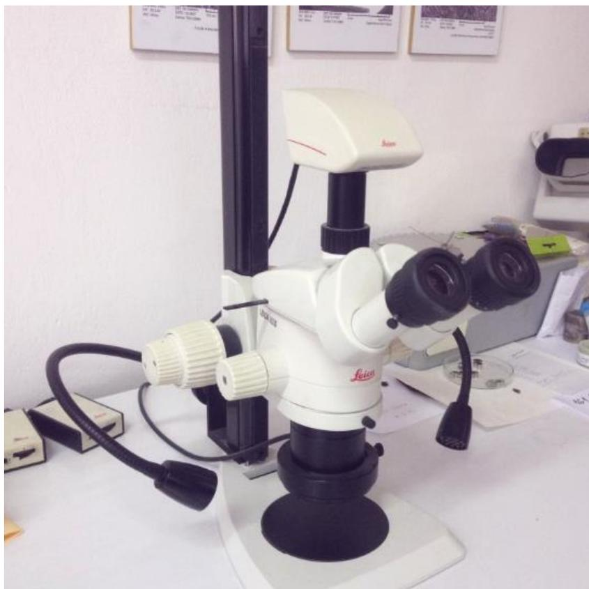
Slika 33. Stereomikroskop Leica MZ6
