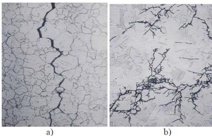
Slika 8. a) Interkristalna korozija b) Transkristalna [10]
