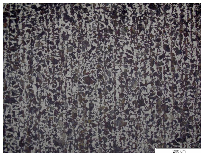
Slika 49. Mikrostruktura jezgre uzorka A2, 200x
