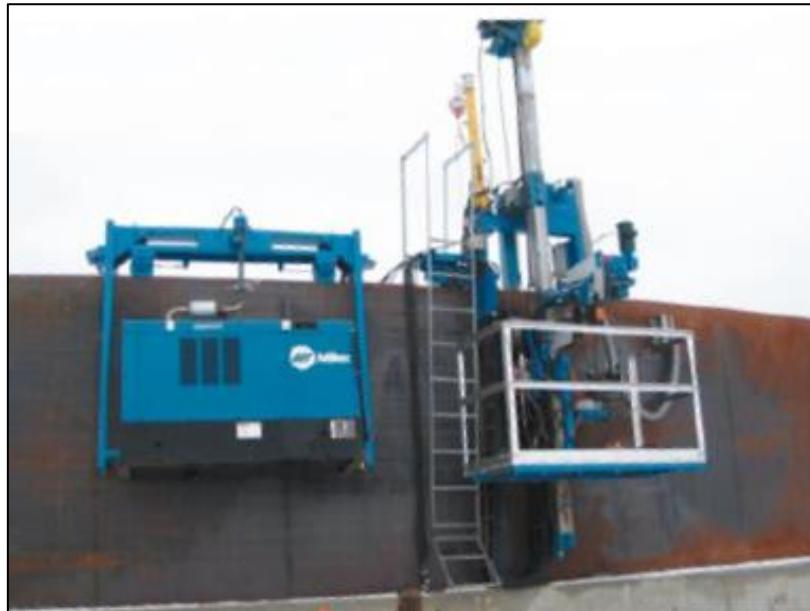
Slika 10. Oprema za EPZ na spremniku s pokretnim izvorom napajanja [7]
