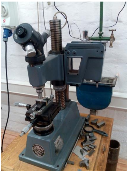
Slika 35. Uređaj za mjerenje tvrdoće
