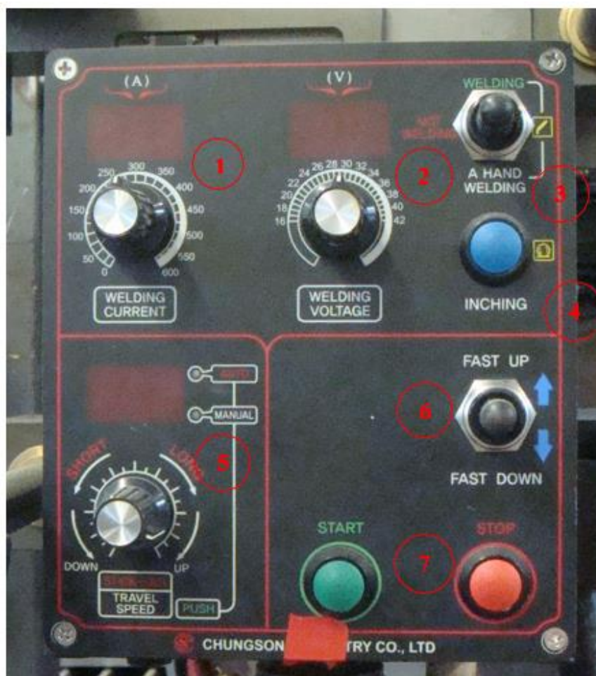
Slika 22. Kontrolna ploča glave za zavarivanje
