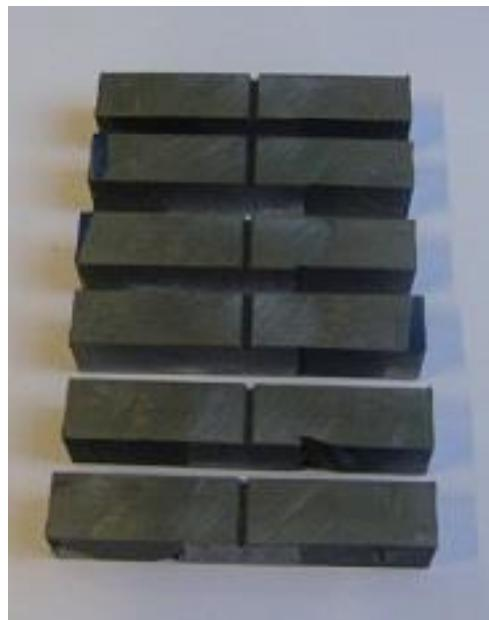
Slika 44. Epruvete za ispitivanje udarne radnje loma
