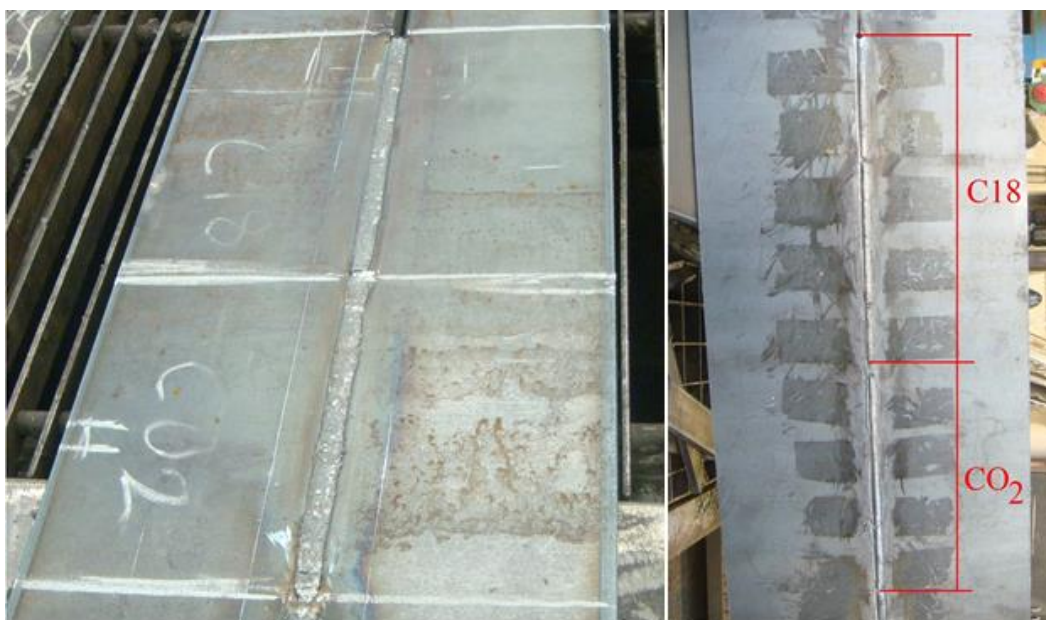
Slika 30. Izgled ploče s prednje i stražnje strane nakon zavarivanja
