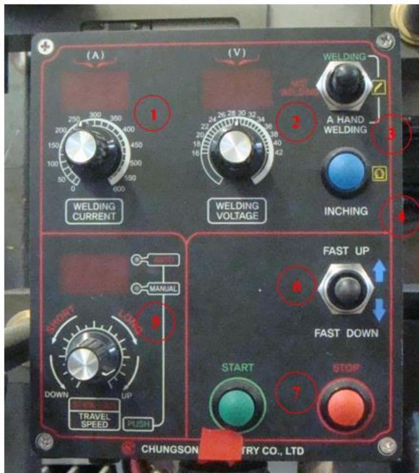
Slika 22. Kontrolna ploča glave za zavarivanje
