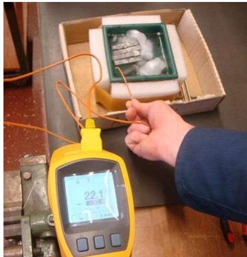
Slika 46. Ohlađivanje uzorka na -40°
