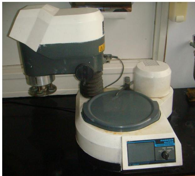
Slika 32. Uređaj za izradu makroizbrusaka
