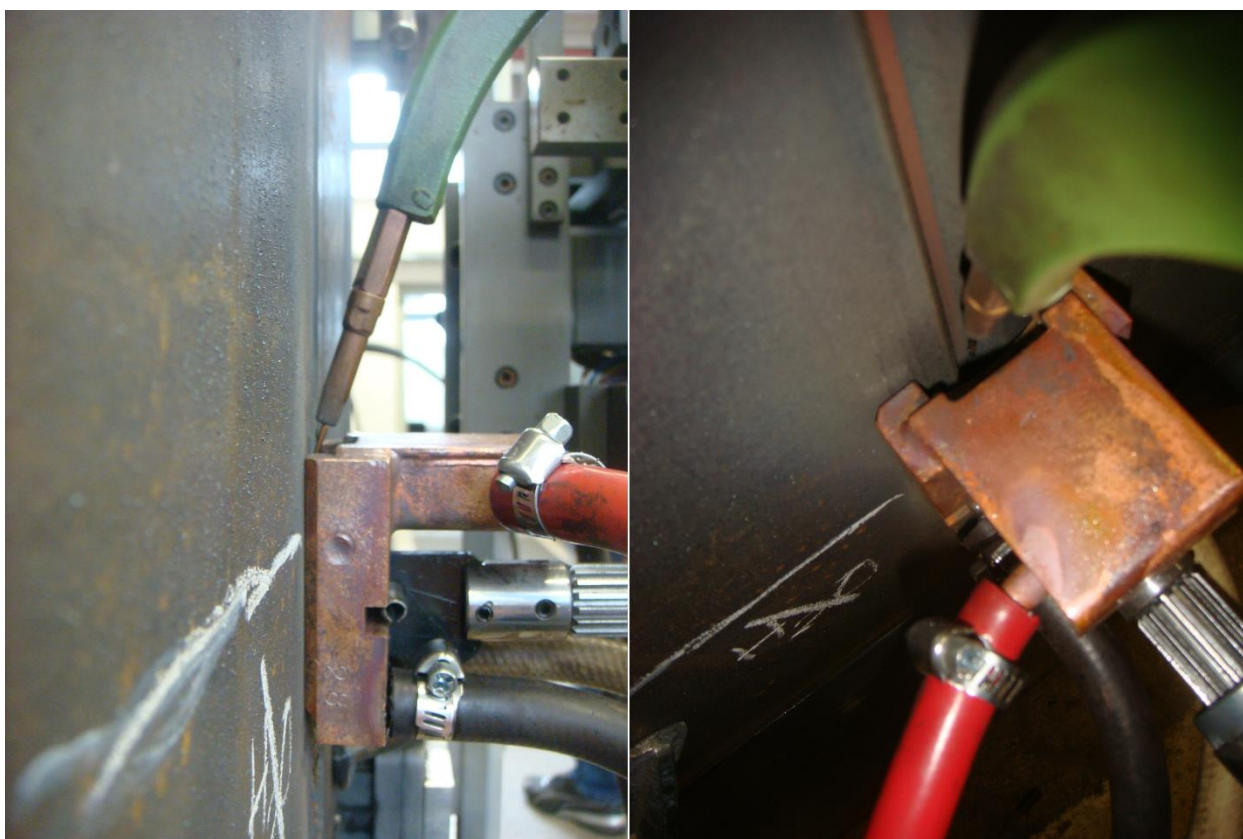
Slika 27. Položaj elektrode prije zavarivanja
