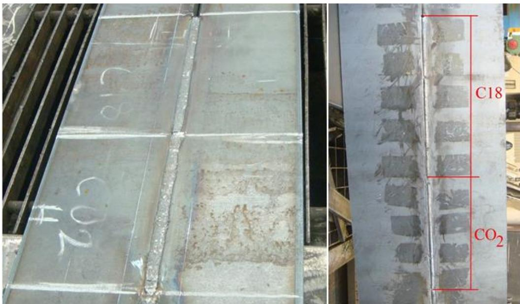
Slika 30. Izgled ploče s prednje i stražnje strane nakon zavarivanja
