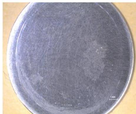
Slika 36. Dijagram cikličke polarizacije i površine nakon ispitivanja za AISI 304 pri 15±2 °C
