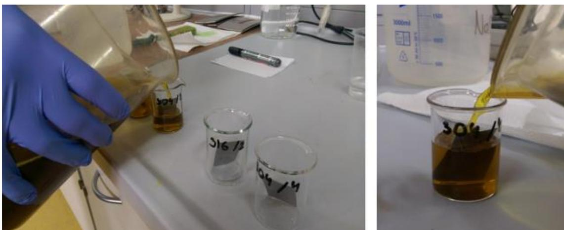
**Slika 44. Prikaz uranjanja uzoraka**
