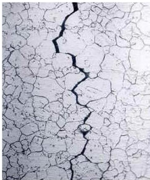
**Slika 10. Prikaz oštećenja uslijed interkristalne korozije [23]**
