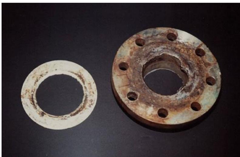
**Slika 7. Prikaz korozijskog oštećenja uslijed korozije u procjepu**
