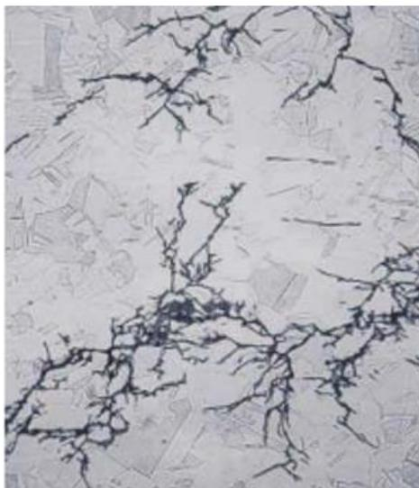
Slika 12. Napetosna korozija AISI 316 čelika [25]
