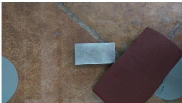
Slika 42. Prikaz brušenja uzoraka
