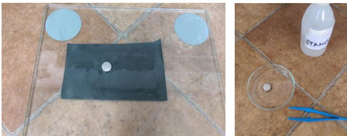
Slika 24. Prikaz brušenja uzorka (lijevo) i odmašćivanja (desno)
