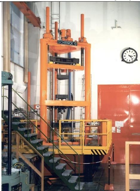
**Slika 4. Primarni etalon sile 1 MN, PTB, Njemačka [6]**
