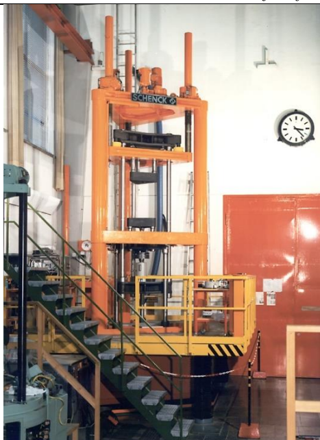
Slika 4. Primarni etalon sile 1 MN, PTB, Njemačka [6]
