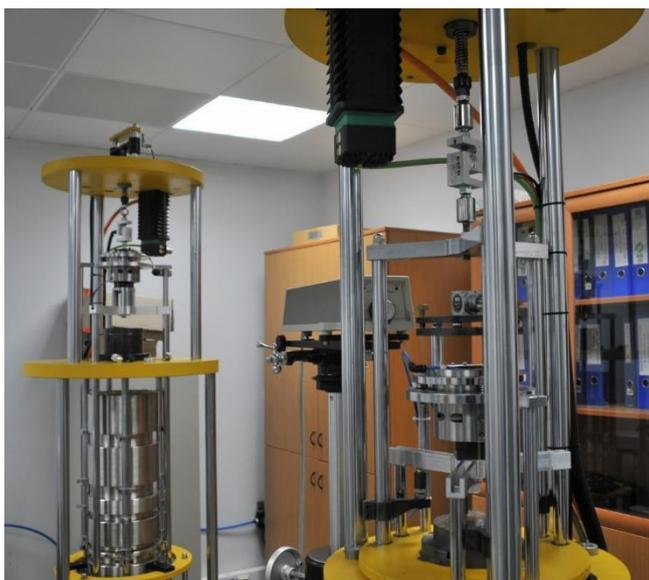
Slika 27. Primarni etaloni sile u Tübitak umjernom laboratoriju
