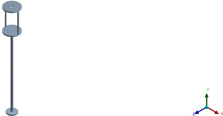
Slika 13. Pojednostavljeni model okvira nosača utega sa dva kraka
