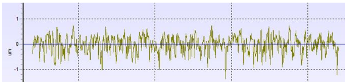
Slika 38. Profil hrapavosti osnovnog materijala za uzorak 2
