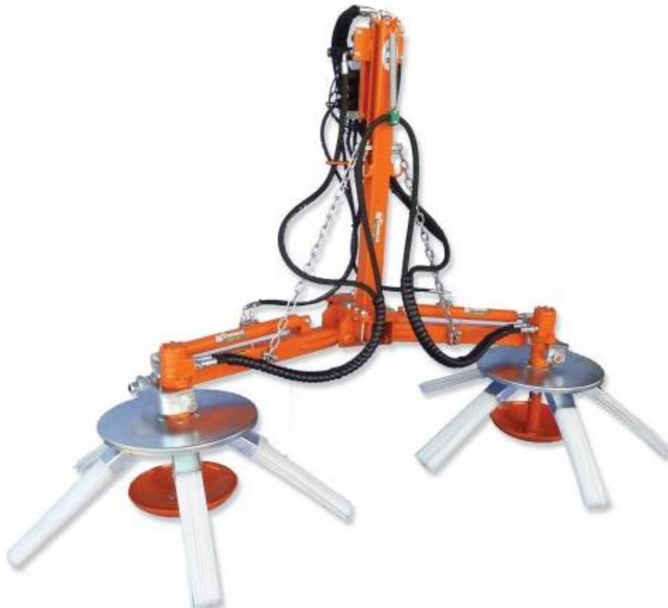
**Slika 8.** traktorski priključak RINIERI AN2 sa uvučenim cilindrima [5]
