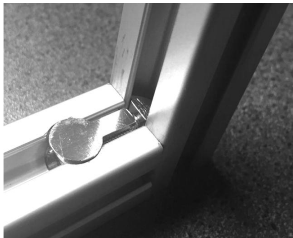
Slika 67. Spoj dva ekstrudirana aluminijska profila
