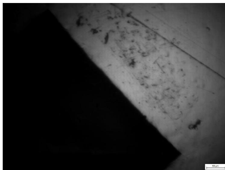
**Slika 6.17.** Rub otiska na etalonu 33P1825 - 204,4 HV20
