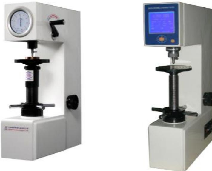
**Slika 2.1.** Tvrdomjeri; analogni i automatizirani
