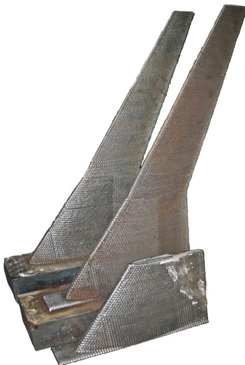
Slika 24. Model krila napravljen WAAM procesom [22]
