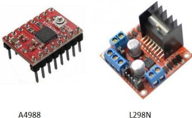
**Slika 4.40. Upravljački skloovi koračnog motora A4988 i L298N [36]**
