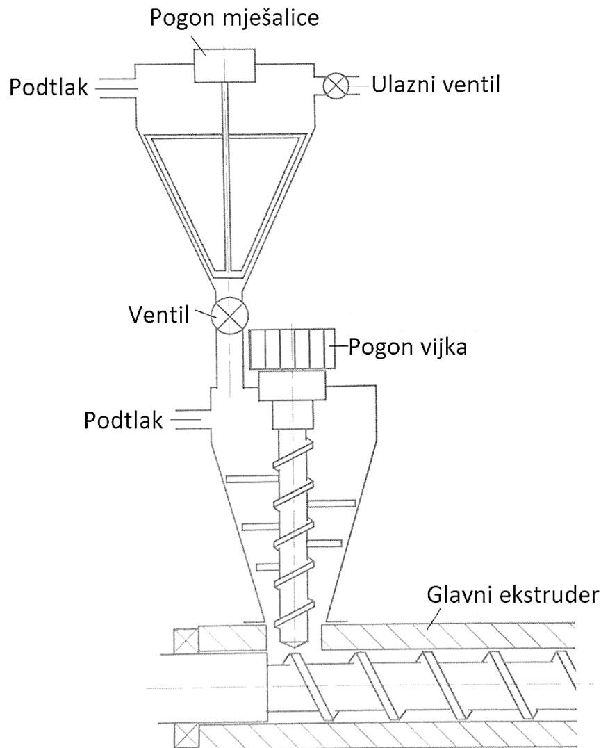
**Slika 2.9. Dvostruki lijevak s podtlačnim sustavom [1]**
