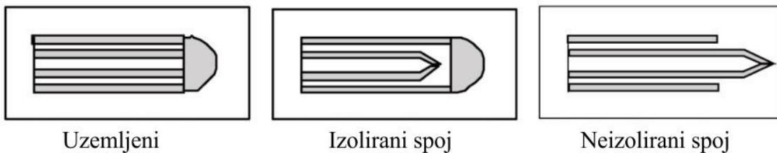
Slika 2.23. Izvedbe termoparova [3]
