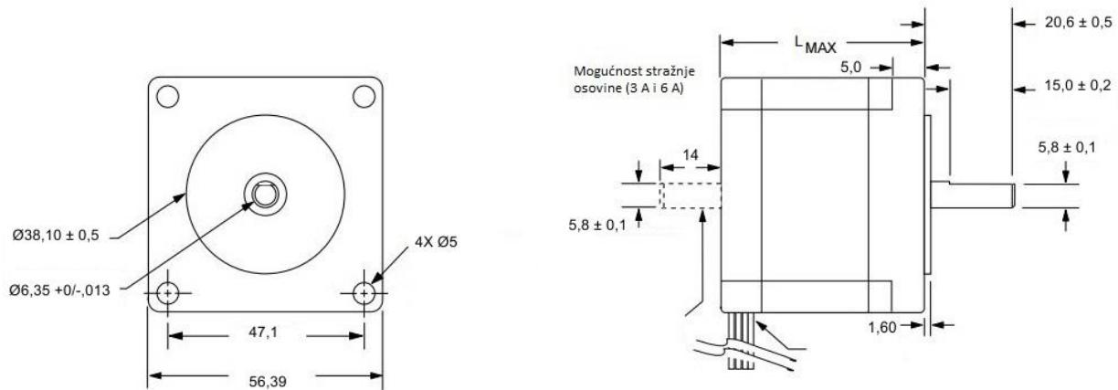
**Slika 4.30. Dimenzije NEMA 23 koračnog motora [31]**
