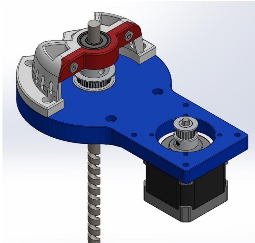
Slika 4.20. Sklop nosača motora i poklopca – pogled odozgo
