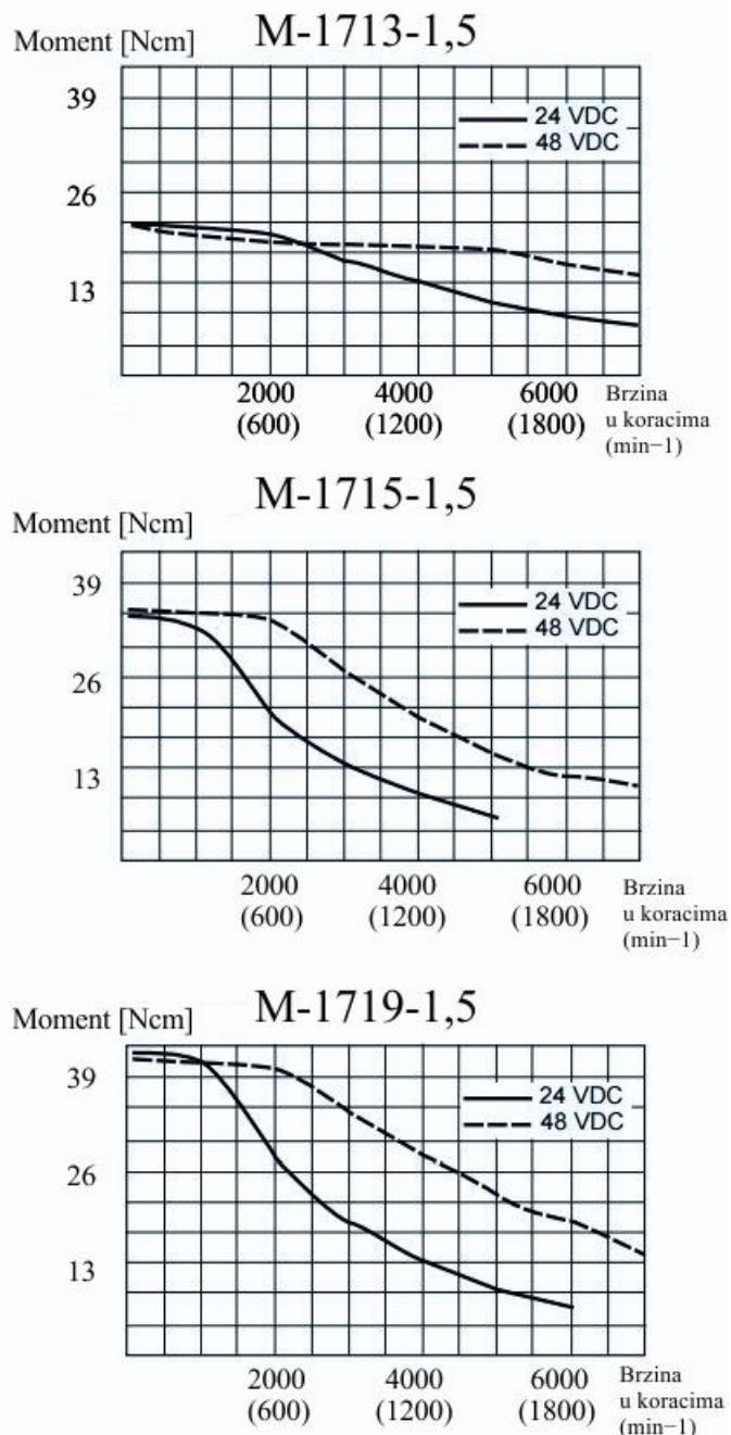
Slika 4.29. Momentna karakteristika NEMA 17 koračnog motora [31]
