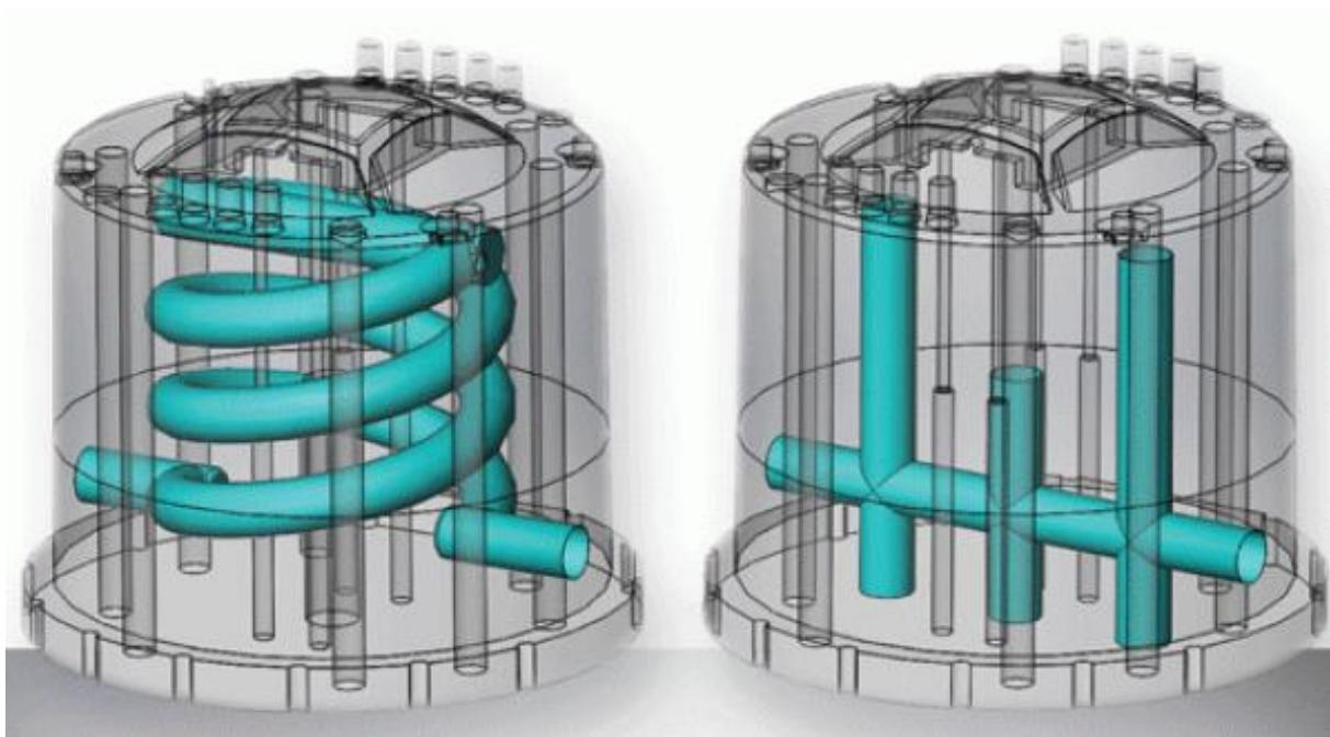
**Slika 3.8. 3D modeli kalupa za aditivnu proizvodnju (lijevo) i za CNC strojnu obradu (desno)**
