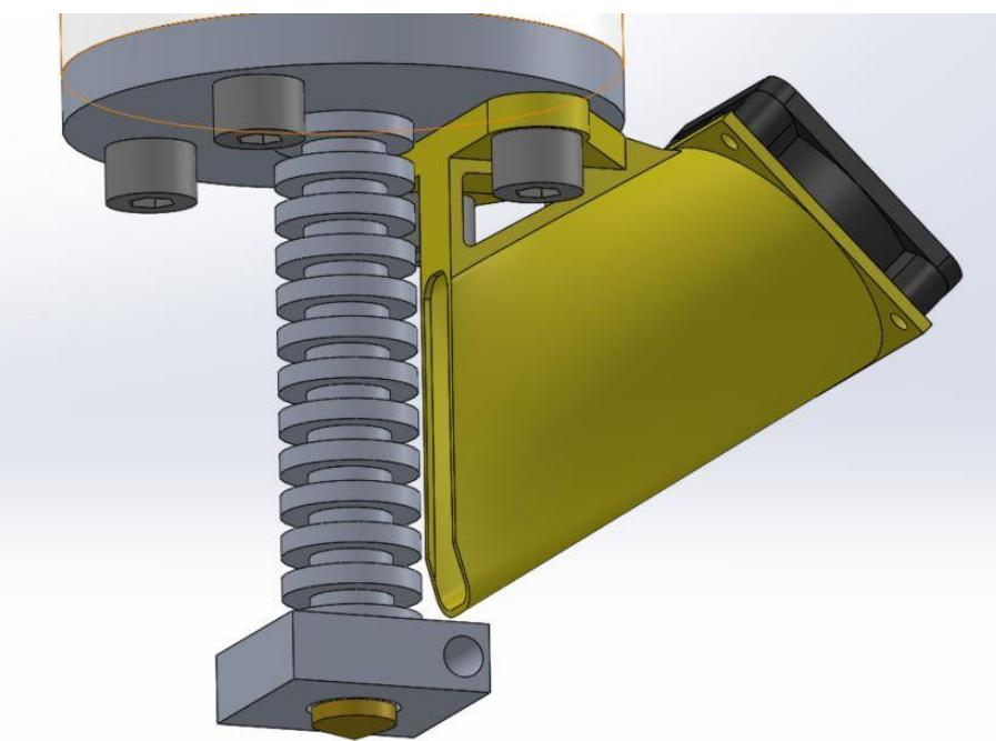
Slika 4.36. Sklop ventilatora i usmjerivača zraka - pogled 2
