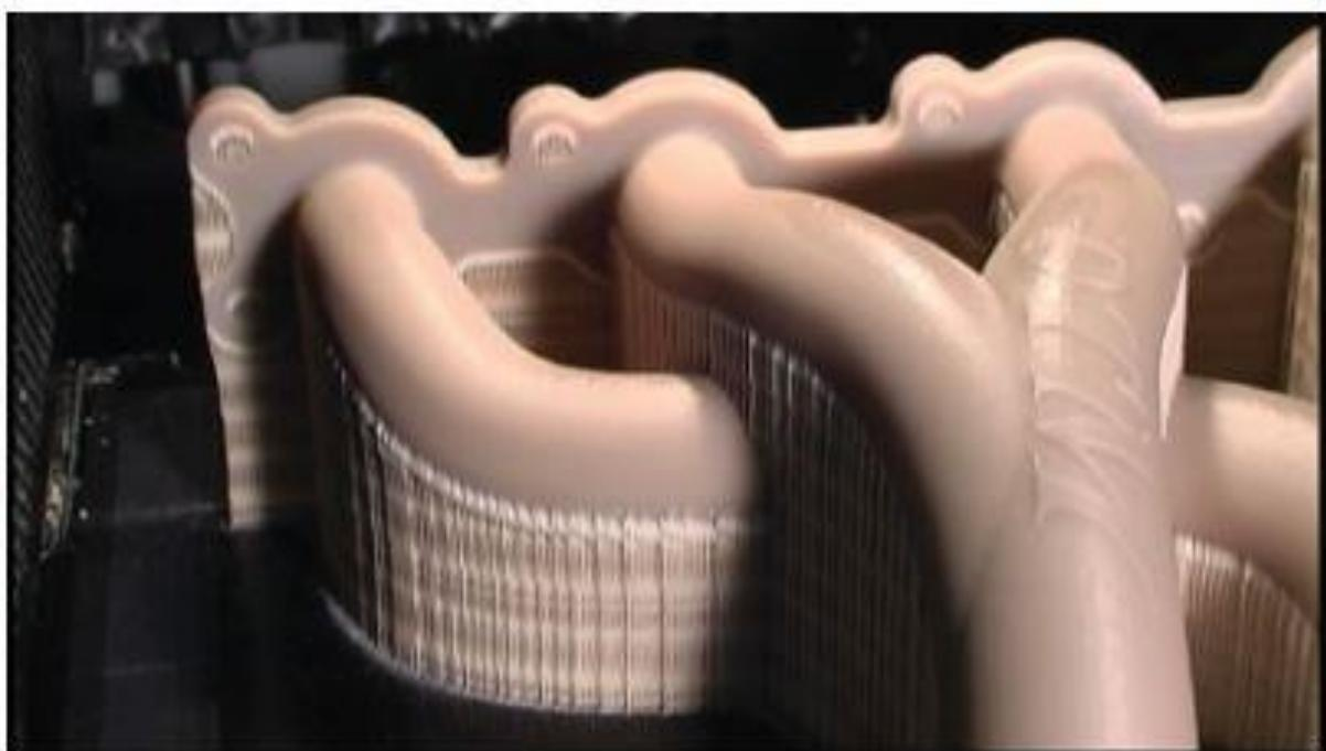
**Slika 3.4. Potporni materijal [16]**
