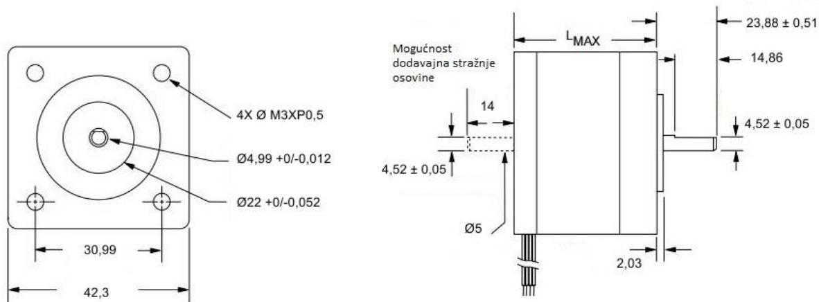
**Slika 4.28. Dimenzije NEMA 17 koračnog motora [31]**
