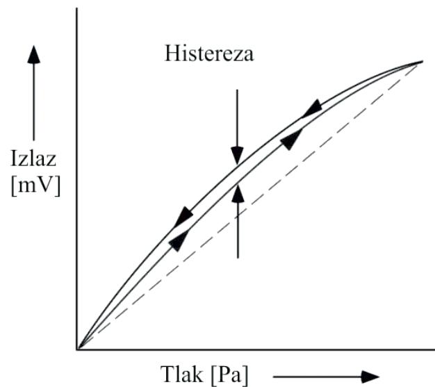
**Slika 2.20. Histereza kod karakteristike senzora tlaka [1]**
