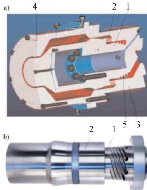
**Slika 2.12. Alat za ekstrudiranje cijevi: a) presjek, b) fotografija. 1 - vreteno kanala, 2 - rukavac za odvajanje, 3 - kućište ekstrudera, 4 - mlaznica, 5 - spiralni kanal za distribuciju polimera [11]**
