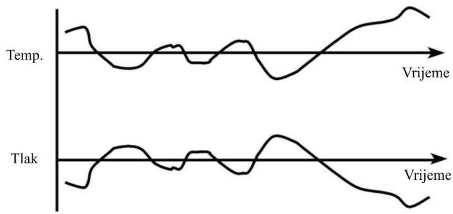
Slika 2.25. Ispis mjerjenja tlaka i temperature taljenja [15]
