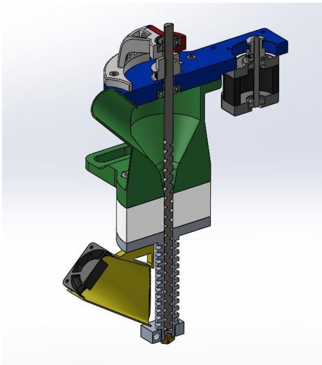
Slika 4.12. Model sklopa ekstrudera v1.1 – presjek
