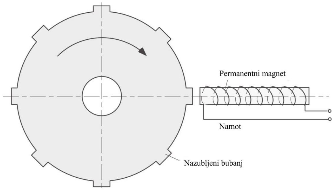
Slika 2.26. Mjerenje brzine vrtnje magnetskim impulsima [1]
