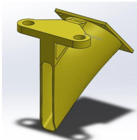
Slika 4.34. Usmjerivač zraka
