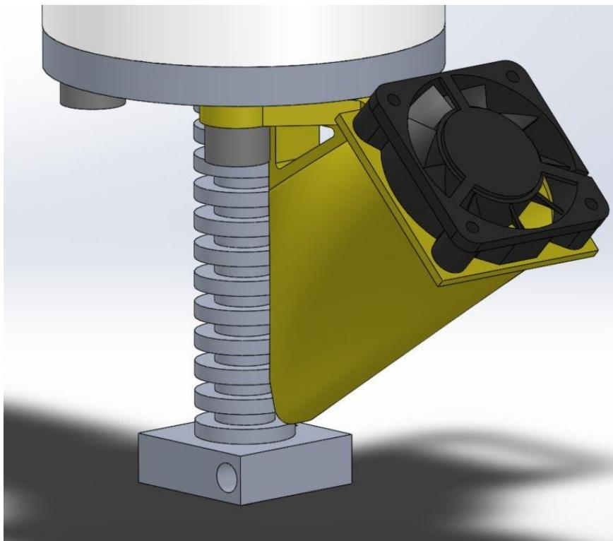
Slika 4.35. Sklop ventilatora i usmjerivača zraka – pogled 1
