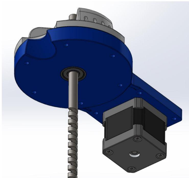
Slika 4.21. Sklop nosača motora i poklopca – pogled odozdo
