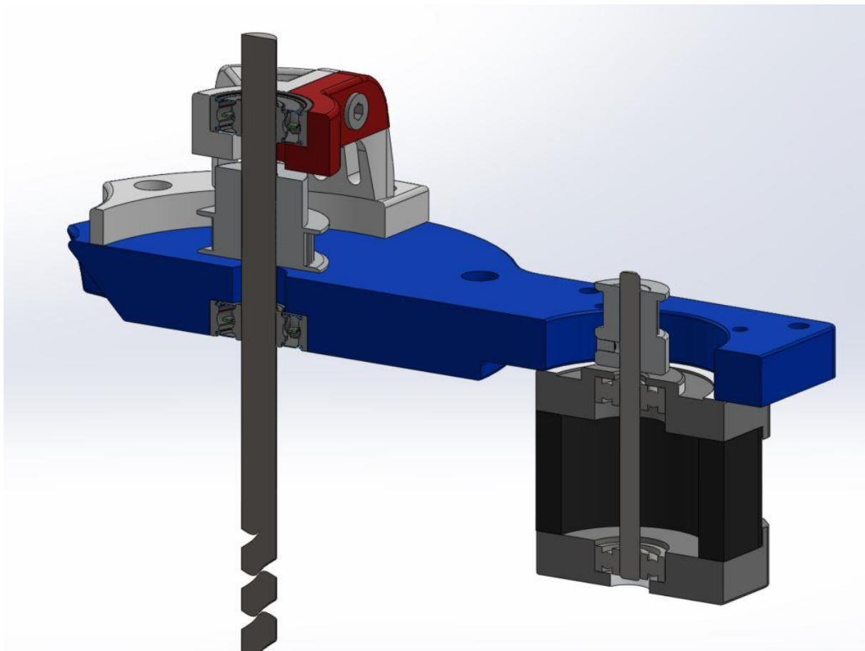
**Slika 4.22. Sklop nosača motora i poklopca - presjek**
