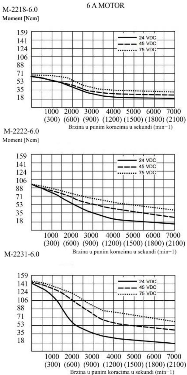
Slika 4.32. Momentna karakteristika koračnog motora NEMA 23 6 A [31]
