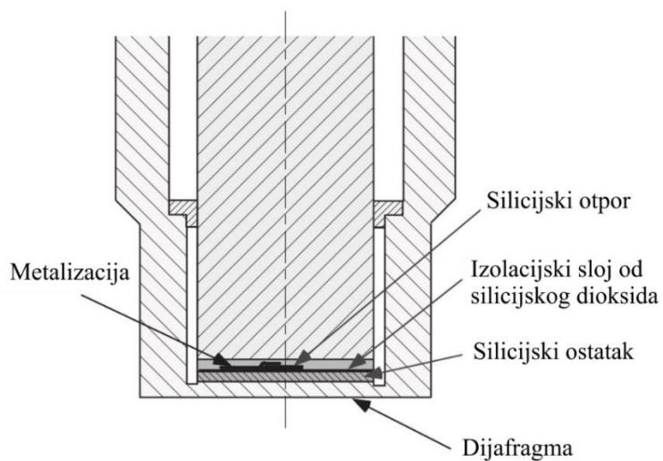
**Slika 2.19. Piezoelektrični senzor [1]**
