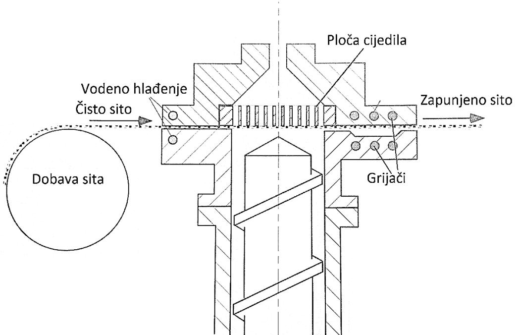
Slika 2.11. Sklop alata za ekstrudiranje s automatskom dobavom sita [1]
