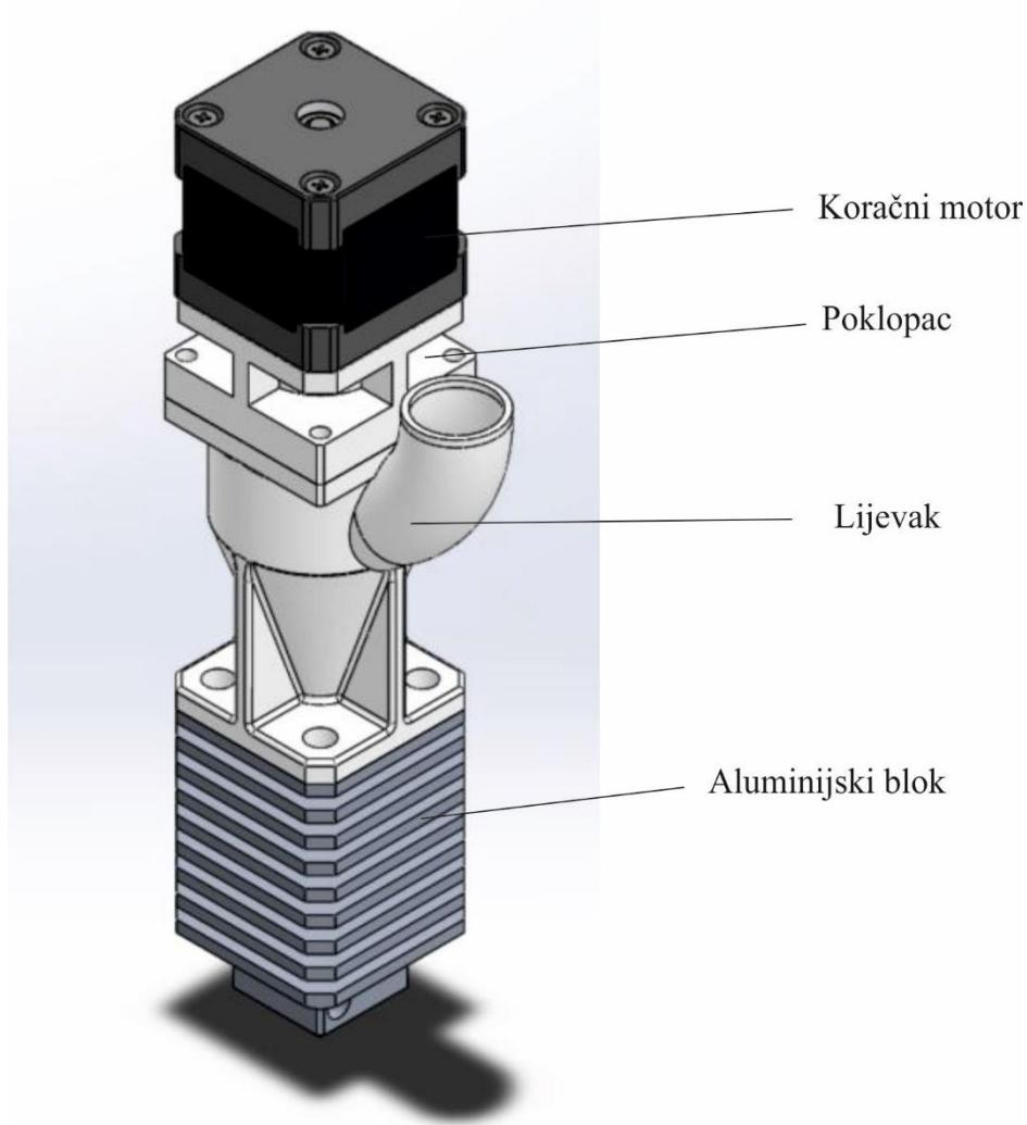
Slika 4.6. 3D model sklopa ekstrudera – v1.0
