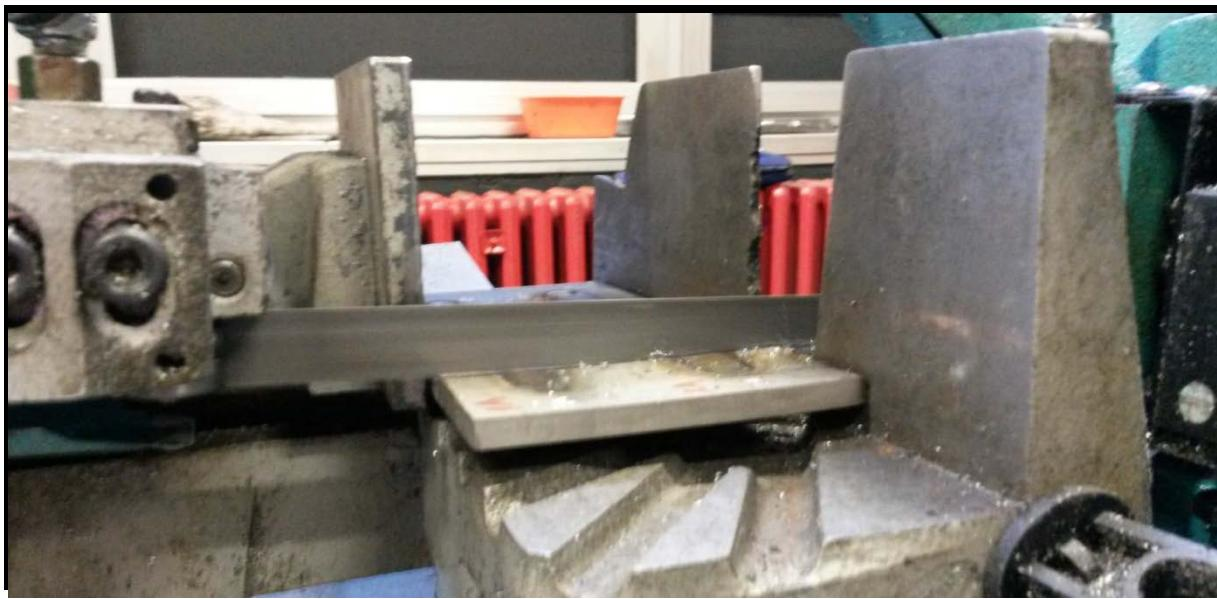
Slika 58. Postupak rezanja uzoraka na tračnoj pili
