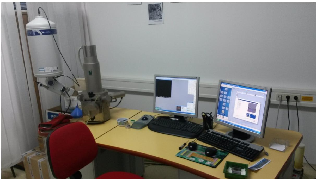
Slika 61. Tescan Vega TS5136 – pretražni elektroniski mikroskop (SEM)
