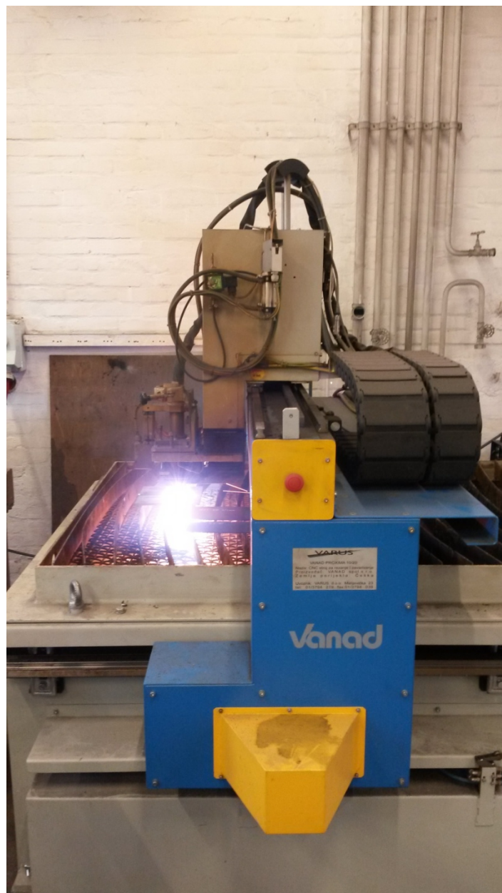
Slika 57. Postupak rezanja uzoraka na plazma rezačici
