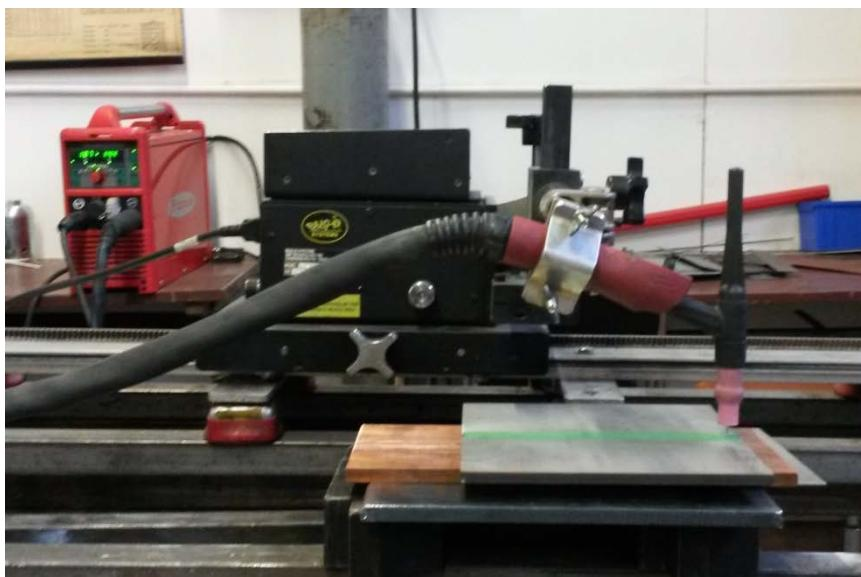
Slika 52. Uređaj za automatiziranje procesa zavarivanja „BUGO Systems“
