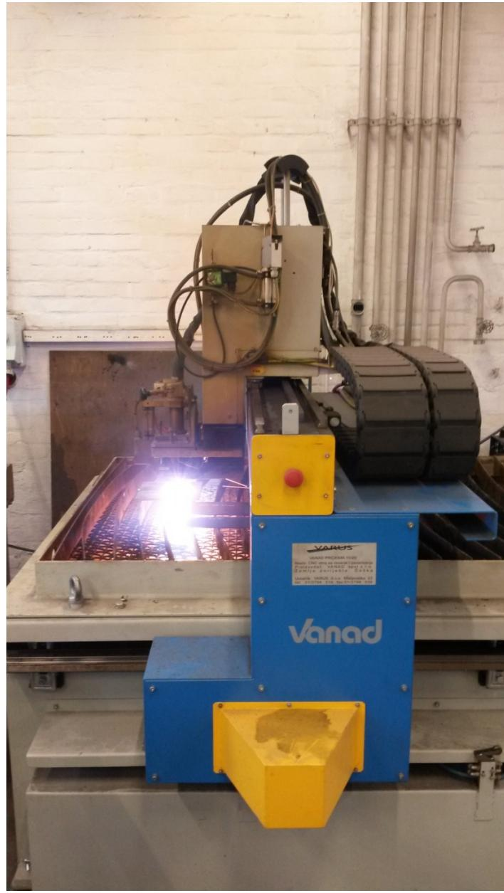
**Slika 57. Postupak rezanja uzorka na plazma rezačici**
