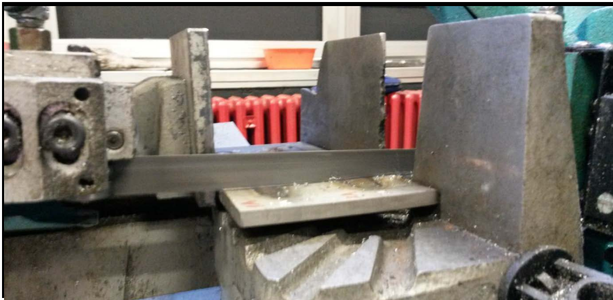
Slika 58. Postupak rezanja uzoraka na tračnoj pili
