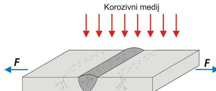
Slika 21. Mehanizam napetosne korozije [16]
