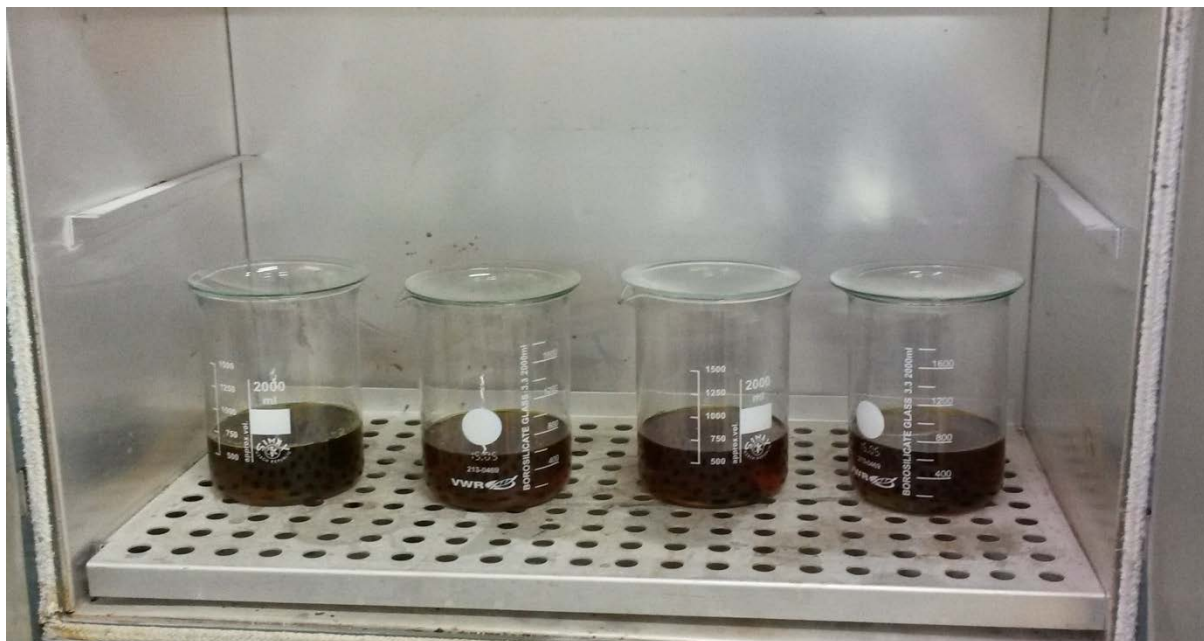
Slika 63. Uzorci pripremljeni za ispitivanje prema ASTM G48-03
