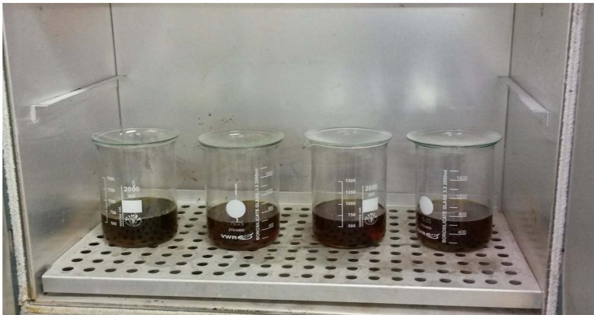
Slika 63. Uzorci pripremljeni za ispitivanje prema ASTM G48-03
