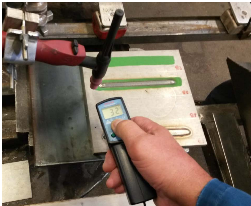
Slika 53. Mjerenje temperature ploče nakon navarivanja
