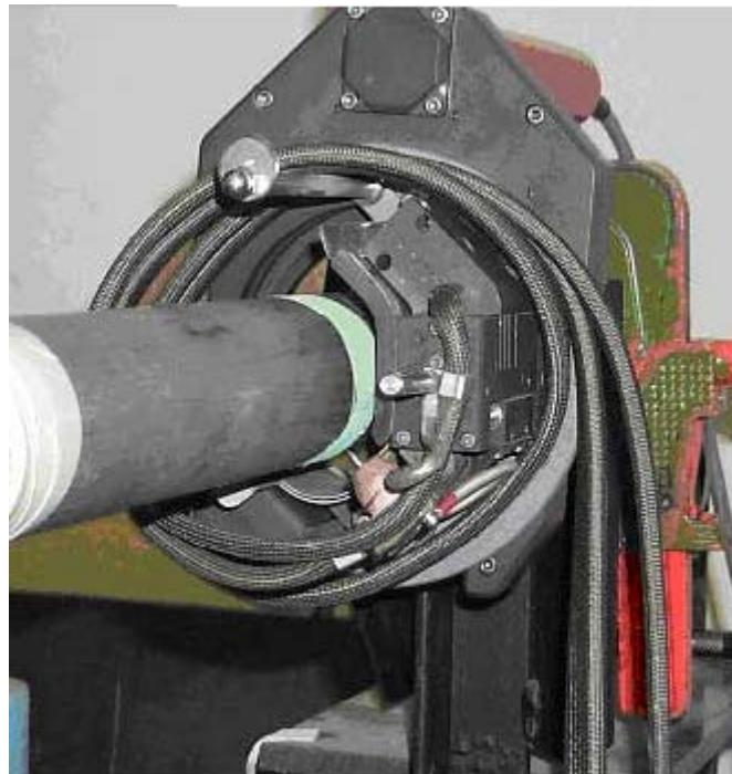
Slika 42. Orbitalno A-TIG zavarivanje cijevi [39]
