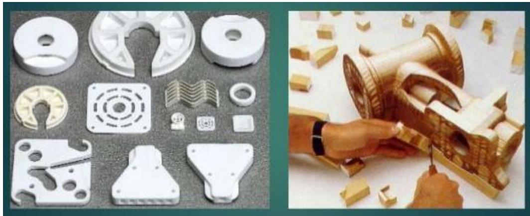
Slika 2.11. Primjeri proizvoda izrađenih s pomoću postupka LOM [20]
