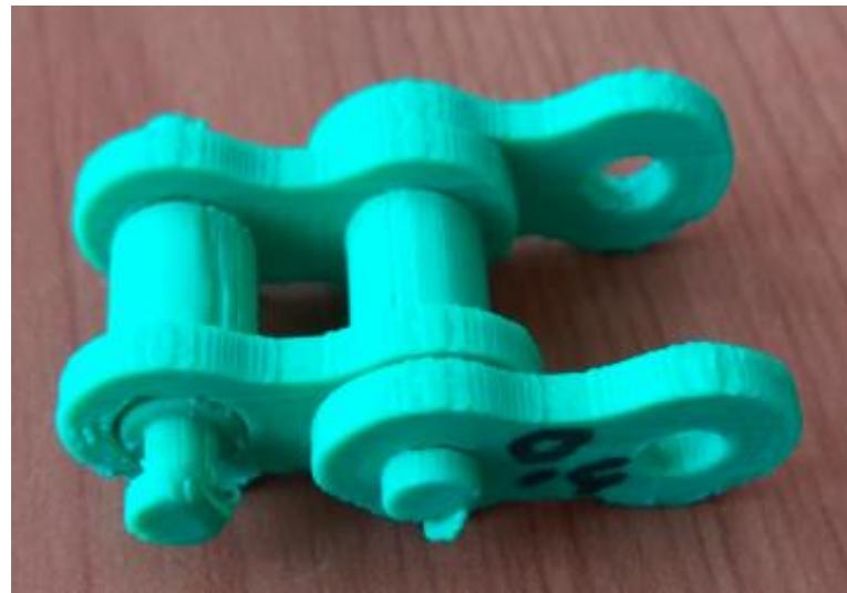
Slika 4.14. Proizvod A izrađen s razmakom između dijelova od 0,4 mm
