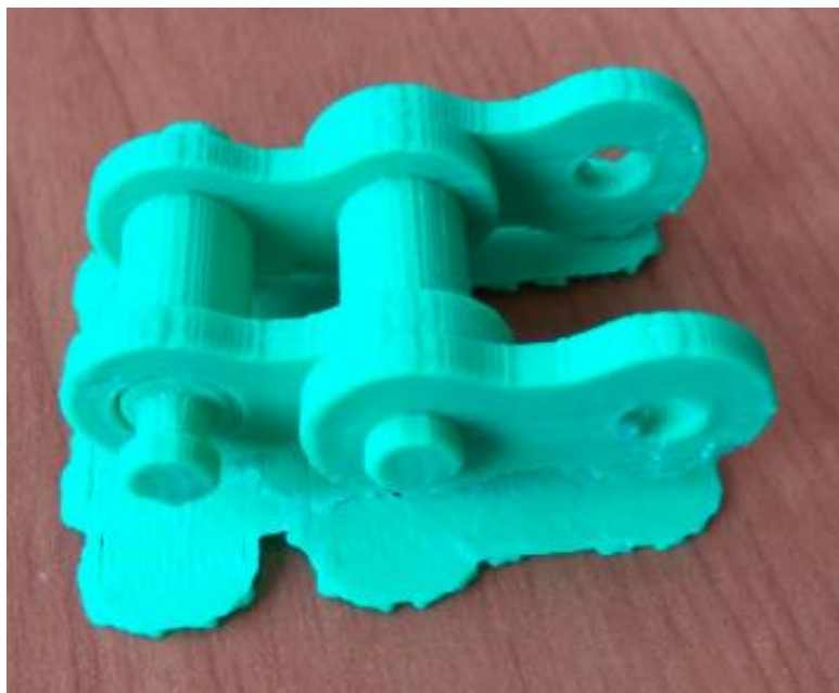
Slika 4.35. Proizvod A nakon otapanja potpornog materijala
